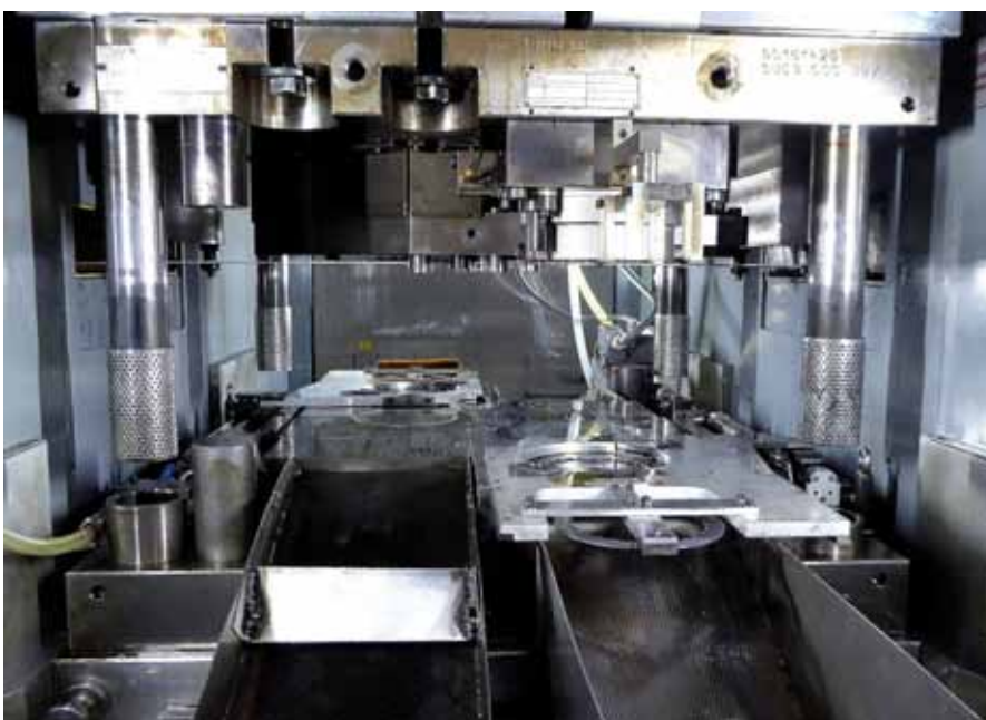
Da in der Feinschneidpresse unterschiedliche Werkstoffe verarbeitet werden, ist die Befettungsanlage für drei verschiedene Medien ausgelegt.
