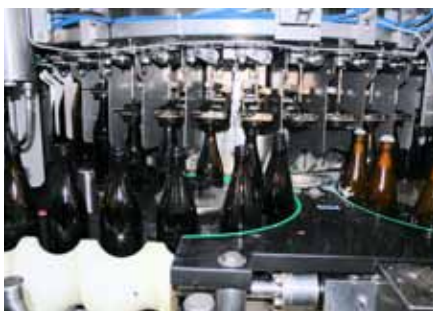
Die Befüllungsmaschinen sind so konstruiert, dass Luftsauerstoff vom eingefüllten Bier ferngehalten wird.
