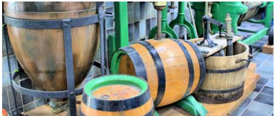
Abfüllanlage anno dazumal: Holzfässer werden von Bucher Bräu schon lange nicht mehr verwendet, da damit höchste Hygieneansprüche nicht erfüllbar sind.
