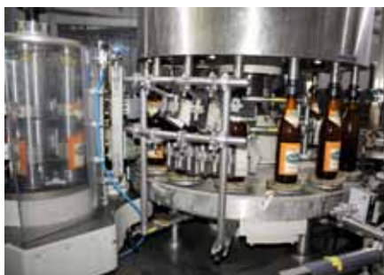
Vollautomatisch werden die jeweiligen Getränkeetiquetten in hohem Tempo auf die Flaschen aufgebracht.
