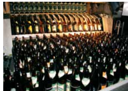
Vor dem Wiederbefüllen sorgen moderne Flaschenwaschmaschinen für hygienisch einwandfreie Flaschen.
