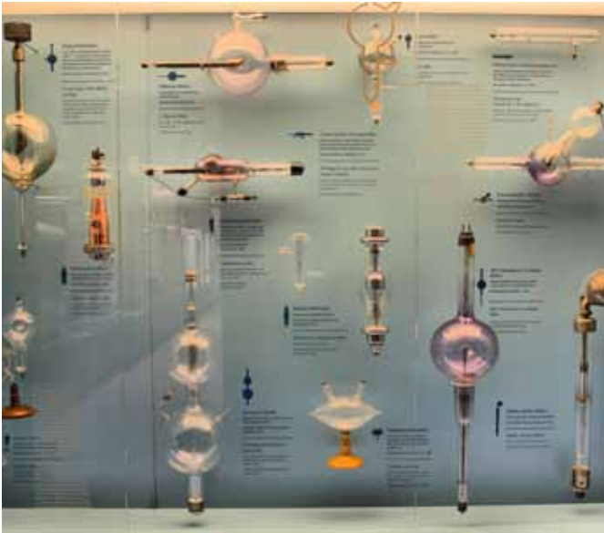
Kathodenstrahlröhren unterschiedlichster Bauart wurden erfunden, um Röntgenstrahlung zu erzeugen.
