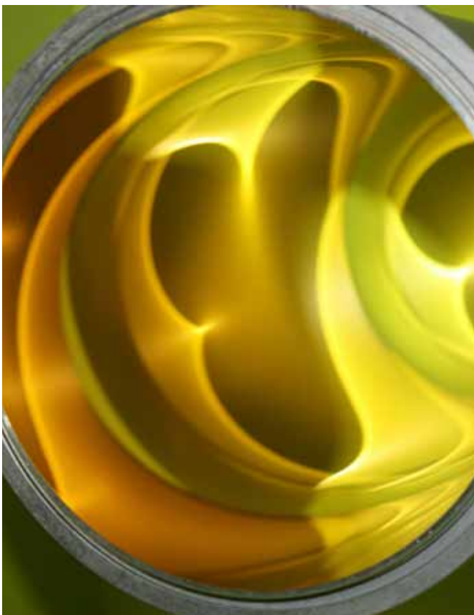
Wolter-Optiken sind ineinander geschachtelte Spiegelsysteme mit elliptischer beziehungsweise parabolischer Form. Damit sind Röntgenstrahlen einfangbar.
