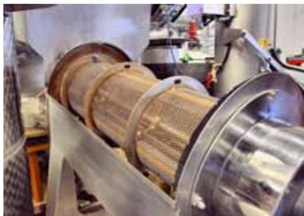
**Im Passiergerät werden vor der Vergärung den Steinfrüchten die Steine und Stiele entfernt.**
