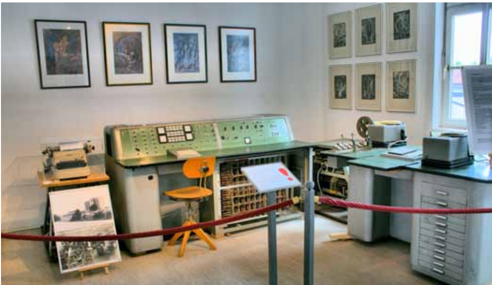
Der Relais-Rechner »Z11« wurde in der Flurbereinigung, in der Stadtvermessung sowie in der optischen Industrie eingesetzt. Er war sehr beliebt, da die Programme per Drucktasten ausgewählt werden konnten.
