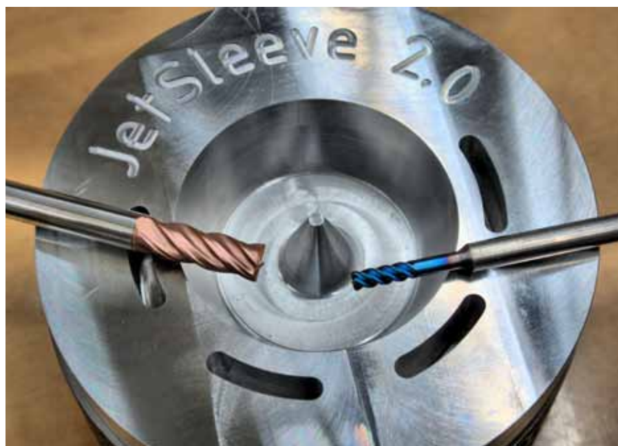
Tiefe Kavitäten bis 20xD sind selbst in schwer zerspanbares Material keine Hexerei mehr. Der Jetsleeve hat das Zerspanen seit 2008 entscheidend erleichtert.
