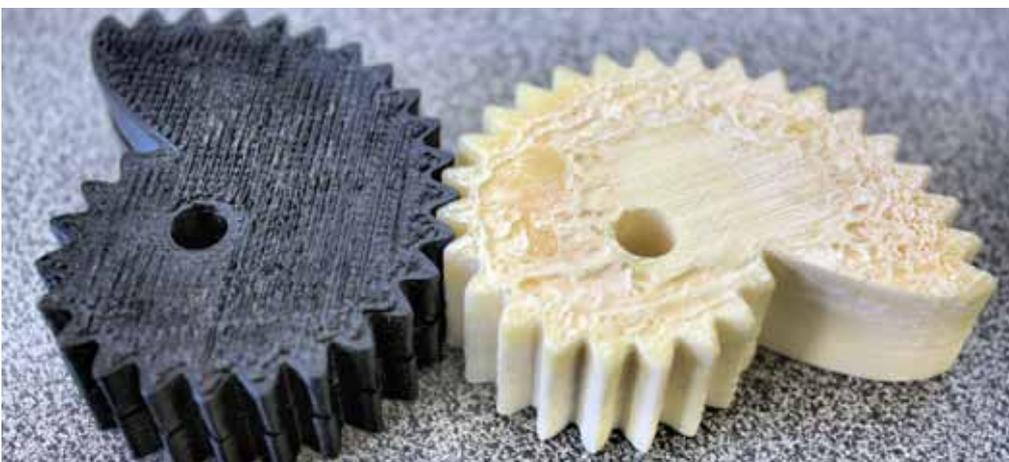
Das mit Epoxidharz gefüllte Teil (rechts) besitzt im Gegensatz zum vollständig aus Filamentmaterial bestehenden Teil rund 65 Prozent der Zugfestigkeit eines spritzgegossenen Teils.
