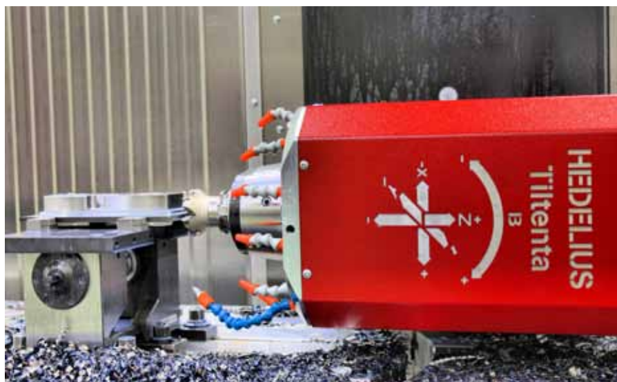
Dank der Schwenkbarkeit der Hauptspindel im Bereich von -5 bis +98 Grad sowie dem integrierten Rundtisch sind selbst komplizierte Teile rasch gefertigt.
