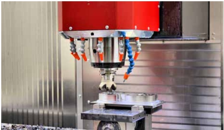
Die Hauptspindel des Fahrständer-Bearbeitungszentrums ›Tiltenta 9‹ wartet mit Drehzahlen von bis zu 18 000 min -1 , 35 kW Leistung sowie einem Drehmoment von bis zu 183 Nm auf.
