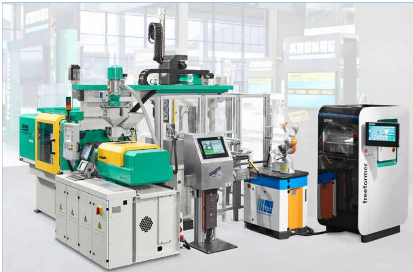
Bei einer informationstechnisch komplett vernetzten und durchgehend automatisierte Fertigungslinie für individualisierte Großserienteile bestückt ein Sieben-Achs-Roboter den Bauraum des Freeformers.
