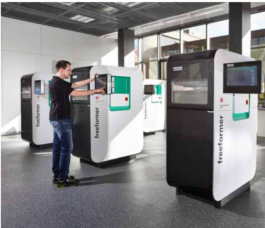
Im Prototyping Center von Arburg produzieren sechs »Freeformer« individuelle Musterteile nach Kundenwunsch.
