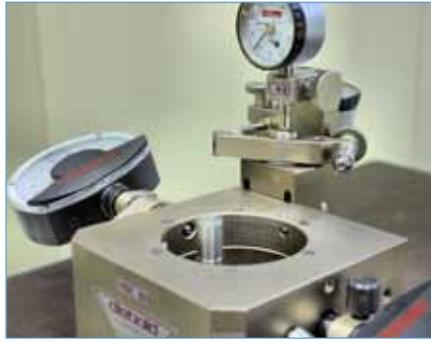
**Soll die Greiferrille geprüft werden, so kann das Messgerät dank der Modularität mühelos aufgerüstet werden.**
