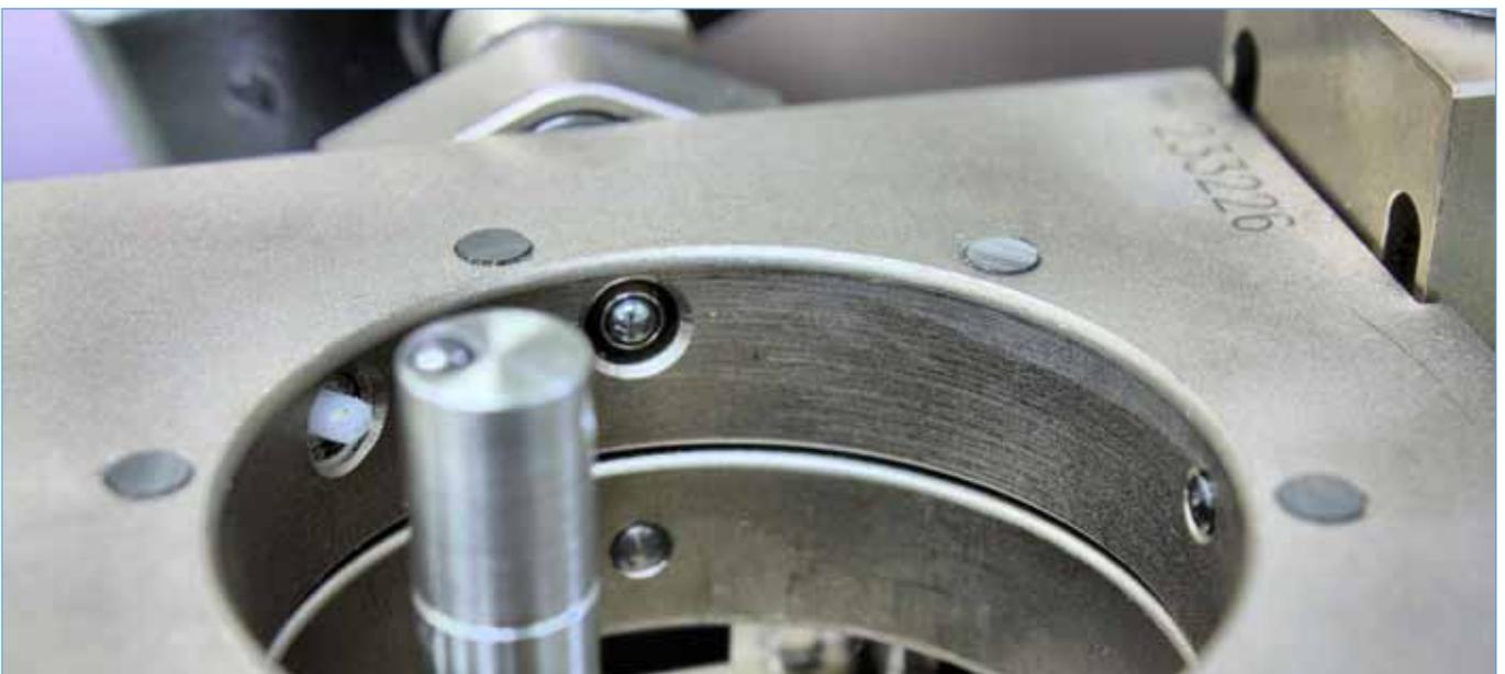
**Ob bewegliches Unterteil, präzise Auflagepunkte oder exakt berechnete Federkraft – das Kegelmessgerät von Diebold überzeugt durch eine wohldurchdachte Konstruktion zum raschen und exakten Prüfen von Kegeln.**
