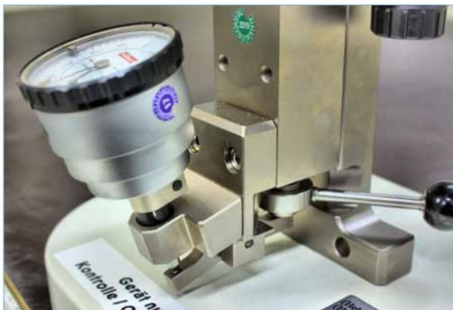
Die Einhaltung der Auswerttiefe kann durch Aktivieren eines Hebels und Ablesen einer Messuhr überprüft werden.
