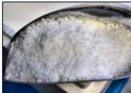
**Die Reinigungswirkung von Trockeneispellets beruht auf thermischen und kinetischen Effekten, zu denen sich noch die Umwandlung des CO<sub>2</sub> vom festen in den gasförmigen Zustand gesellt, wodurch Schmutz regelrecht abgesprengt wird.**
