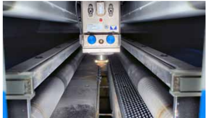
Der Laser verfährt in Y-Richtung, während die Blechtafel in X-Richtung unter dem Laser hindurchfährt.
