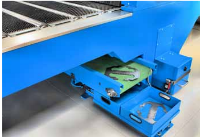
Ein optionales Förderband ist die sinnvollste Möglichkeit, die Teileausschleusung zu automatisieren.
