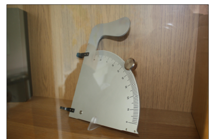
Der Pendelquadrant war ein einfaches Hilfsmittel zur Winkelbestimmung in der Berechnung der Wolkenhöhe.
