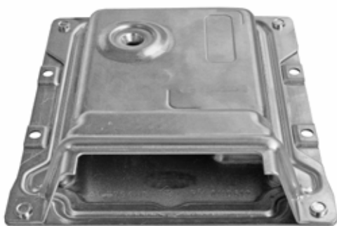
Die Elektronikbox wird in einem Arbeitstakt mittels vier Tox-Rund-Punkten von 6 mm Durchmesser dicht verbunden.
