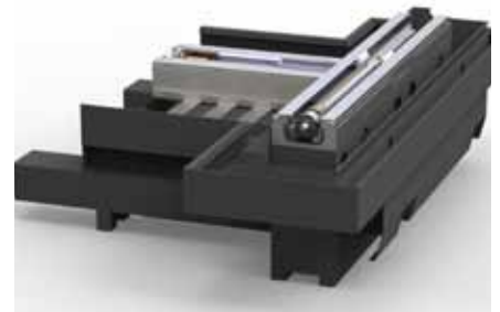
Das Maschinenbett aus Grauguss zeichnet sich durch eine hohe Steifigkeit und ein ideales thermisches Verhalten aus.
