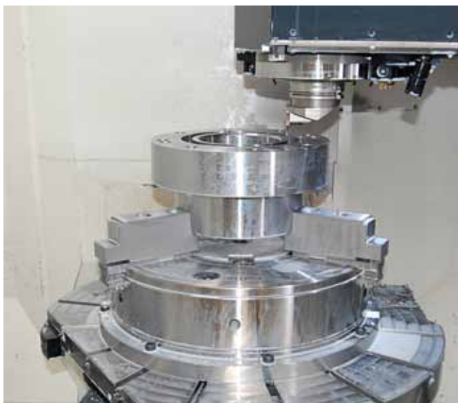
Die Rund- und Planlaufgenauigkeit des DURO-T von Röhm ist doppelt so gut wie nach DIN-Genauigkeitsklasse 1 gefordert.
