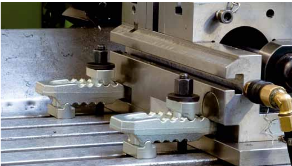
Das ›Krokodil‹ von AMF hat zwei unterschiedlich ausgeformte Spannhasen und kann je nach Anwendungsfall einfach umgedreht werden.
