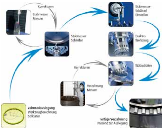
Closed-Loop-Fertigung: Abweichungen werden einem Korrekturalgorithmus zugeführt, der Korrekturwerte für die Kinematik berechnet und diese der Maschinensteuerung zuführt.
