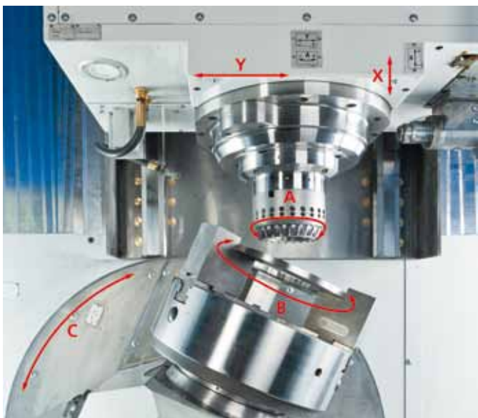
Wälzschälen auf einer Spiralkegelrad-Wälzfräsmaschine des Typs ›C 29‹ von Oerlikon.
