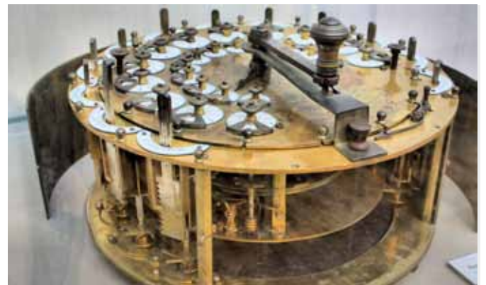
Die Rechenmaschine von Wilhelm Schickard schaffte bereits 1623 den selbsttätigen Zehnerübertrag.
