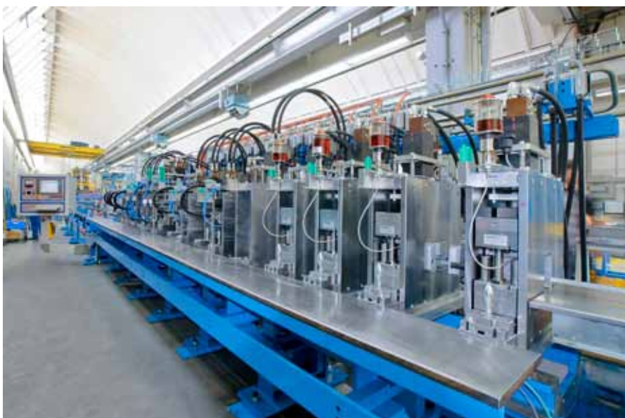
Die multifunktionale Profilvermaschine von Dreistern erlaubt an jeder Stelle der Maschine beliebige Operationen, wie etwa Profilvern, Stanzen oder Schweißen.
