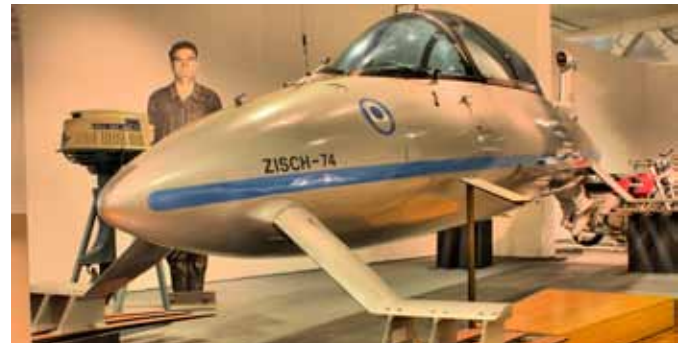
Felix Wankel war der Vater des Gleitboots ›Zisch-74‹. Bei den ski-ähnlichen Gleitflächen hat sich Wankel am Flügelaufbau einer Eule orientiert. Angetrieben von einem Wankelmotor erreichte das Boot auf dem Bodensee eine Geschwindigkeit von 80 km/h.
