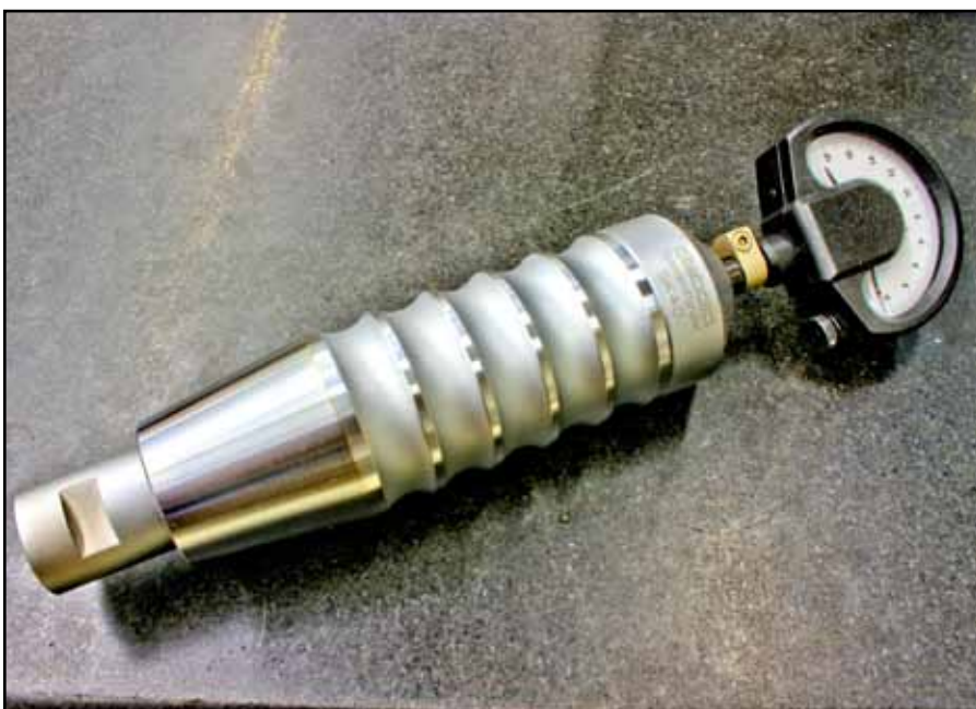
Spannkraftmessgeräte von Diebold besitzen eine wohlüberlegte Konstruktion, die für nur drei Prozent Toleranzabweichung vom Messwert sorgt.
