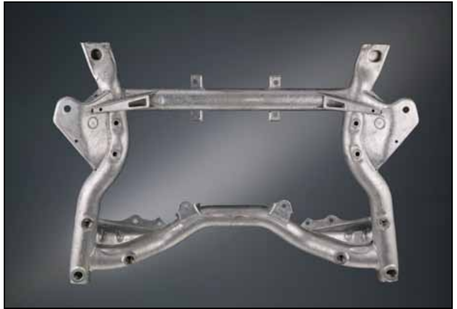
Beispiel für Leichtbau im Fahrwerk: Der Vorderachsträger aus lufthärtendem Stahl der Mercedes C-Klasse nimmt auch Motor und Lenkung auf.
