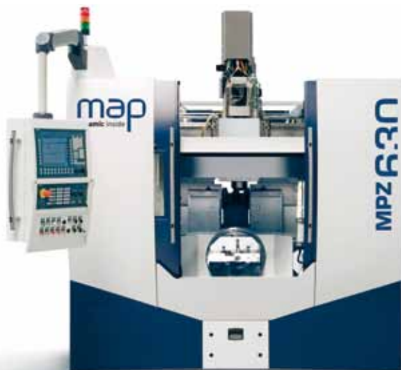
Die MPZ630 von MAP bietet Verfahrenswege von 600 x 965 x 500 mm in X, Y, Z und kann Werkstücke bis zu einem Durchmesser von 890 mm bearbeiten.
