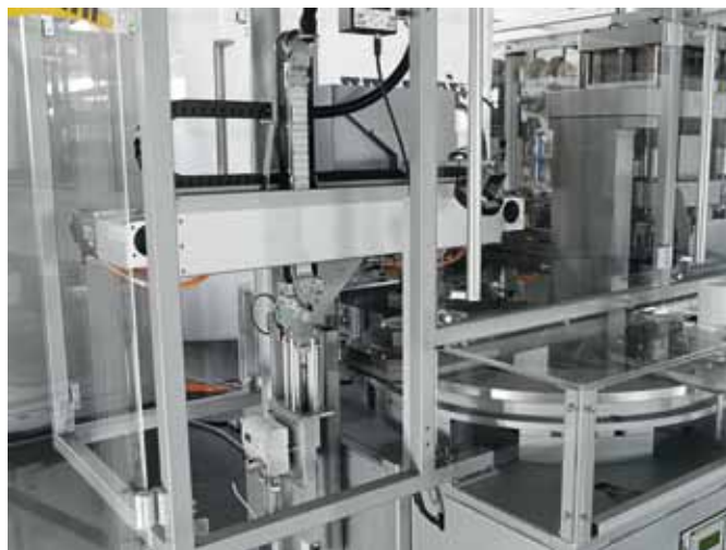
In die Gesamtanlage integriertes High-Speed T-Portal: Das Pick & Place-System von Festo ist mit seiner Taktzeit von 670 ms dynamischer als konventionelle Linienportale.
