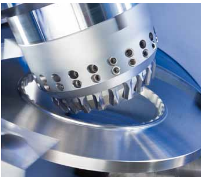
Stabmesser-Schälrad im Einsatz.
