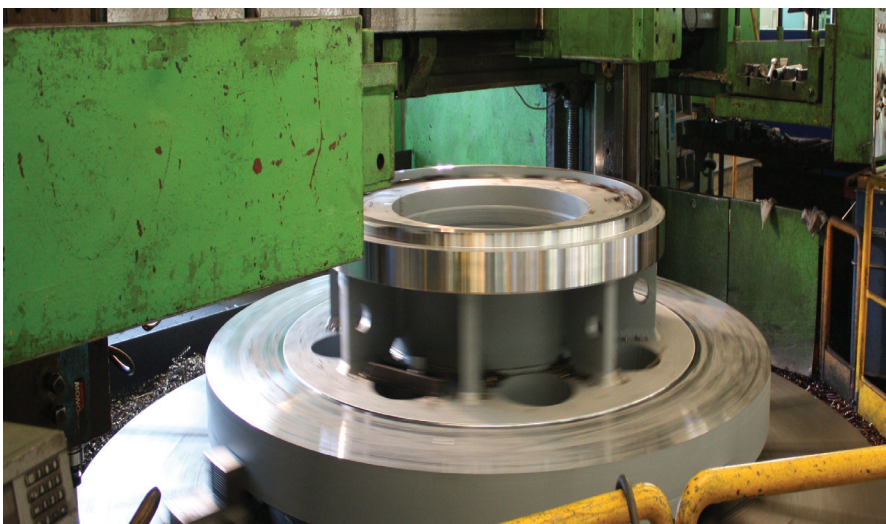
Beim Drehen führt das Werkstück die alles entscheidende Drehbewegung aus, auf die sich der Begriff ›Schnittgeschwindigkeit‹ bezieht.
