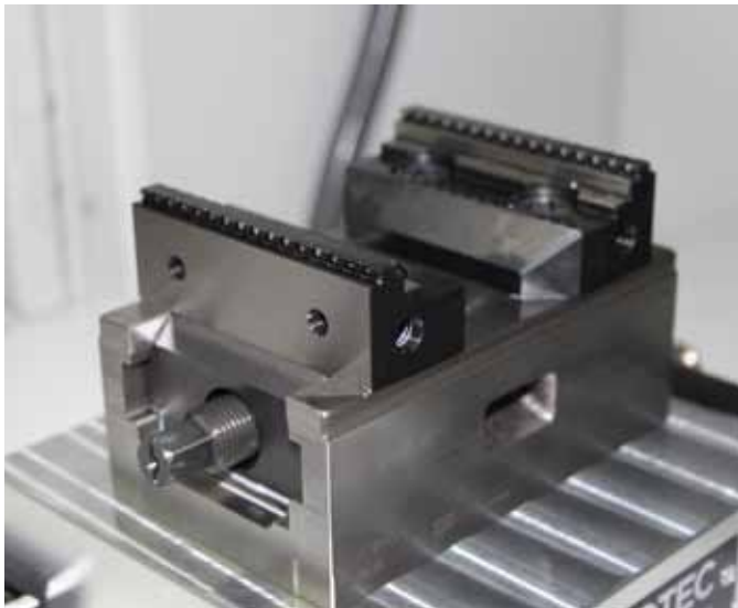
Zentrischspanner »C2 80 L-130« aufgebaut auf einer Standardpalette, die über ein auf dem BAZ vorinstalliertes Nullpunkt-Spannsystem aufgenommen wird.
