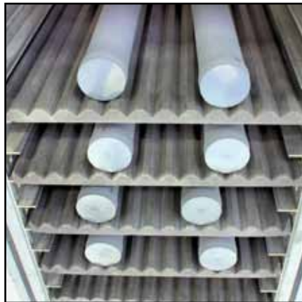
Mit dem Strangpressverfahren lassen sich Grünlinge in Stangenform herstellen.
