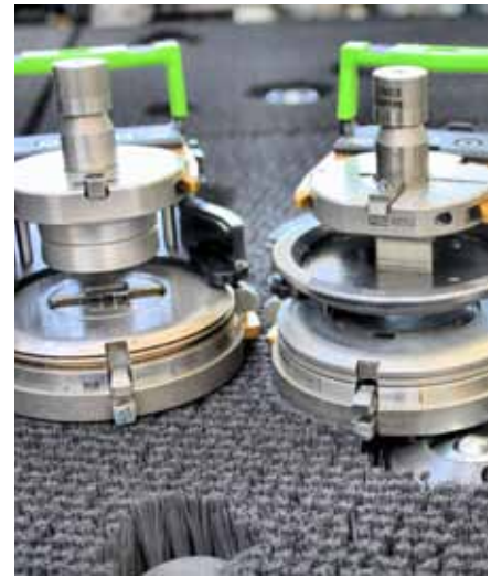
Die RTC-Werkzeugkassetten bestehen aus faserverstärktem Kunststoff, besitzen daher nur ein geringes Gewicht.
