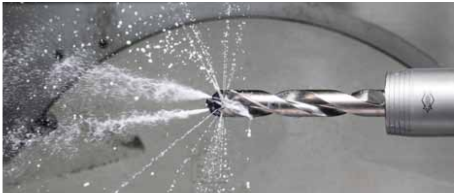
Die Mizellen des im Bonderite dualCys-Prozess verwendeten KSS sind feindisperser als bei Standardschmierstoffen und lassen sich auf die ideale Tröpfchengröße einstellen.
