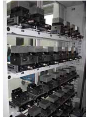
Werkstückmagazin bestückt mit Zentrischspannern von Gressel vom Typ ›C2 80 L-130‹.
