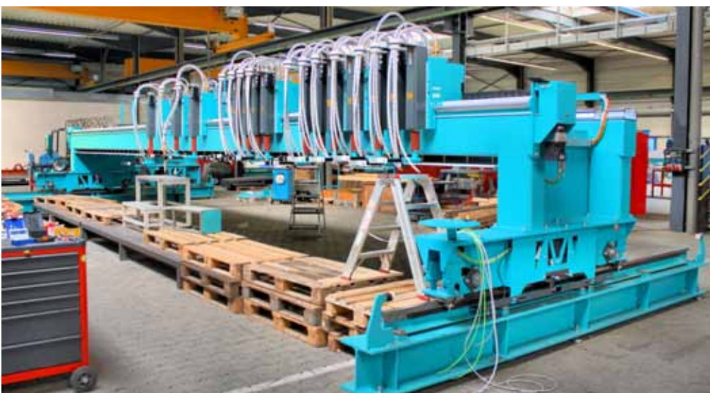
Sato liefert Brennschneidanlagen fast beliebiger Abmessungen, die mit bis zu 20 unabhängig voneinander verfahrbaren Brenner ausgerüstet werden können.
