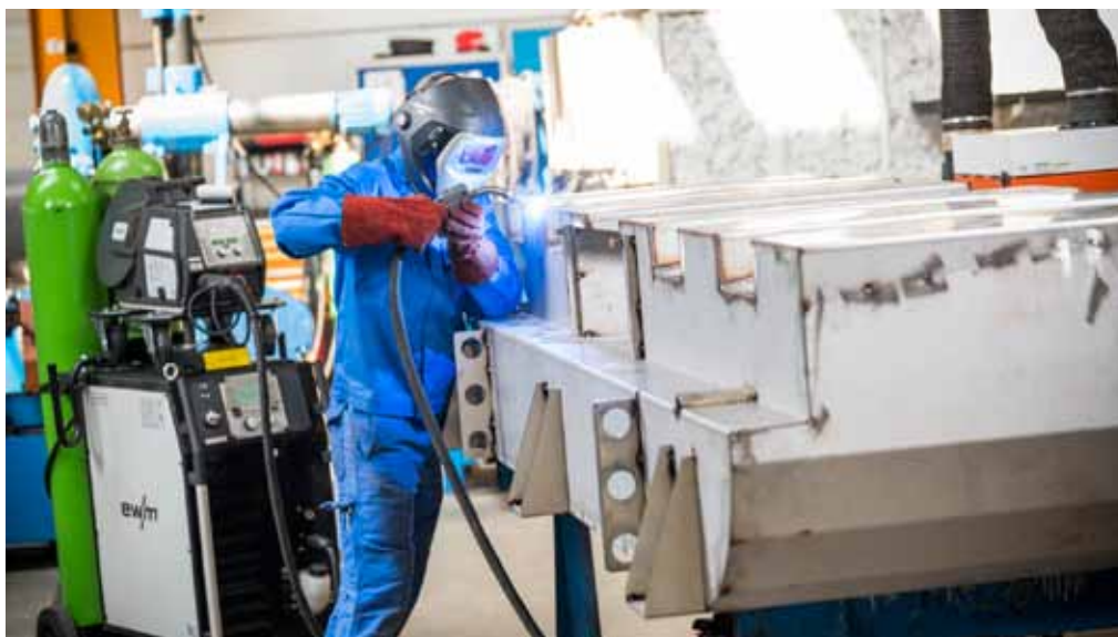
Nahezu spritzerfreies Schweißen der Nähte an einem Anlassofen. Das coldArc-Verfahren von EWM minimiert den Verzug beim Fügen der Edelstahlbleche.
