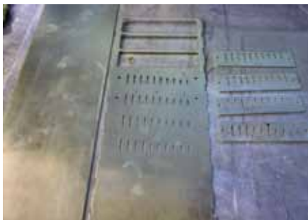
Präzise hergestellte Stanzteile sind eine wichtige Voraussetzung, damit Mundharmonikas perfekt klingen.
