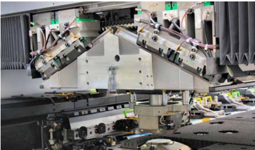
Eine raffinierte Konstruktion erlaubt das getrennte Verfahren von Unter- und Oberwerkzeug, deren gemeinsames Verdrehen, sowie die Auslösung des Stanzhubs.
