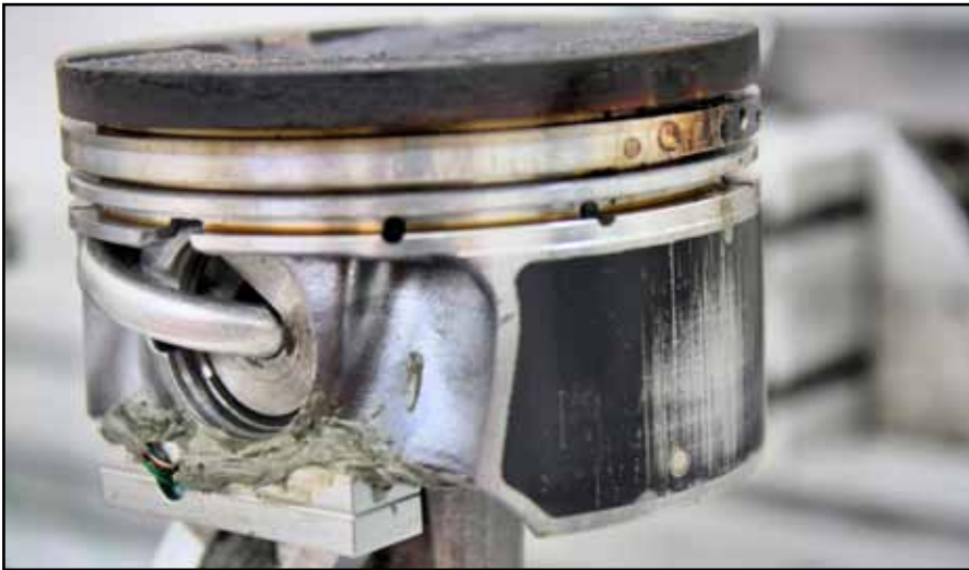
Mit in Kolben eingebauten Sensoren sind die Experten der TU-München in der Lage, Daten aus dem Brennraum zu gewinnen.
