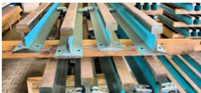
Schwere Eisenbahnschienen sorgen dafür, dass sich das Laufverhalten in einer überzeugenden Schnittqualität widerspiegelt.
