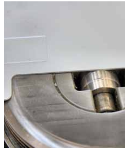
Ein besonderes Werkzeug erlaubt das Entgraten von Ausklinkungen.
