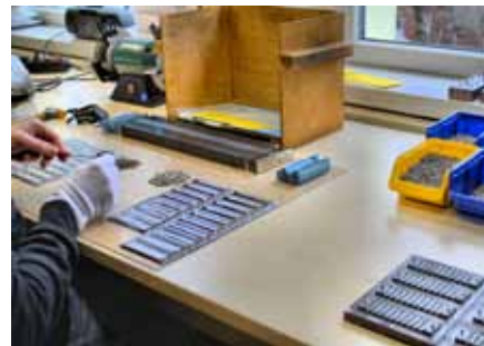
Mit großer Sorgfalt werden Mundharmonikas zusammenmontiert und Stück für Stück auf Funktion geprüft.
