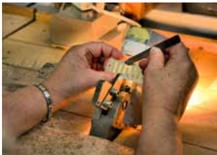
Mit dem Lichtspaltverfahren ist es möglich, Stimmzungen auf den Stimmplatten präzise auszurichten.
