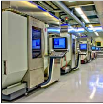
DMG-BAZs wurden von Horns Spezialisten zu leistungsstarken Wendeplattenschleifmaschinen umgebaut.
