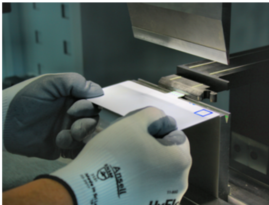
CNC-gesteuert Anschläge sorgen dafür, dass die Biegung von bis zu 500 Millimeter tiefen Blechlaschen sicher gelingt. Ein Biegelinienlaser zeigt zudem an, ob das Teil korrekt positioniert ist. Dies gibt Sicherheit, ehe der Biegevorgang gestartet wird.
