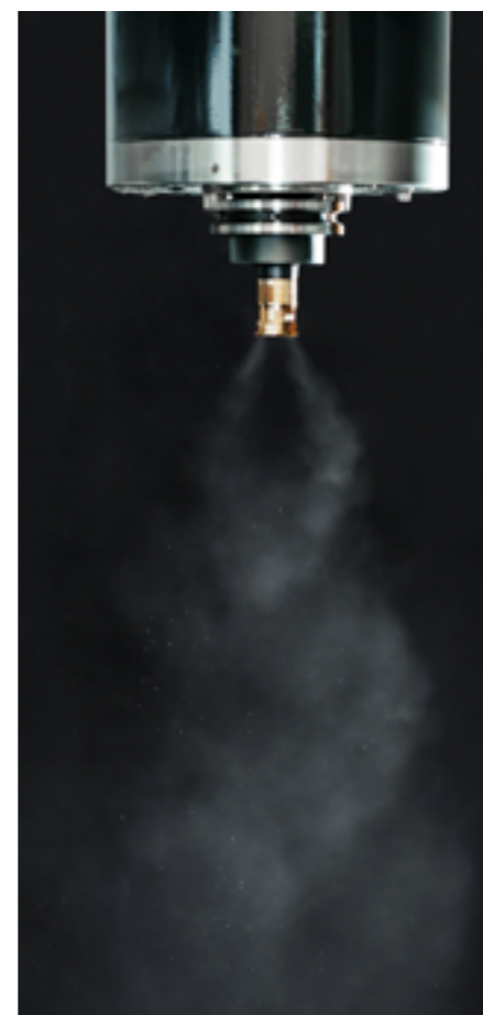
Nur wenn ein konstantes und konsistentes Aerosol mit gutem Sprühverhalten in der Werkzeug-Austragsdüse erzeugt wird, können Verbesserungen durch den Einsatz der Minimalmengenschmierung erreicht werden.
