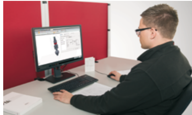
MarCAD erstellt Messprogramme für Mahr-Formmessgeräte.
