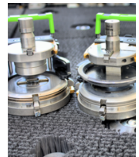
Die RTC-Werkzeugkassetten bestehen aus faserverstärktem Kunststoff, besitzen daher nur ein geringes Gewicht.
