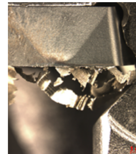
Dank der optimalen MMS-Strategie konnte eine Aufbauschneide an der Schneidkante verhindert werden, wie das rechte Bild nach 48 Fräsbahnen bezeugt.
