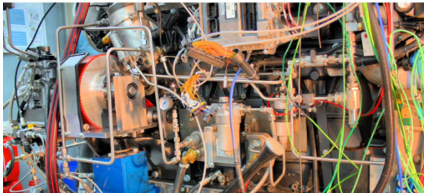
An der TU-München wird erforscht, wie herkömmliche Dieselmotoren ausgelegt werden müssen, um für den Betrieb mit OME-Kraftstoffen tauglich zu sein. Dies sind künstlich hergestellte Kraftstoffe, die höchsten Abgasanforderungen genügen.
