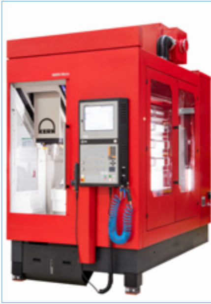
Mit der »Micro Pro« hat die Kern Micro-technik GmbH ein gegenüber der »Micro um bis zu 20 Prozent preisgünstigeres BAZ entwickelt, das nur vier Quadratmeter Aufstellfläche benötigt.
