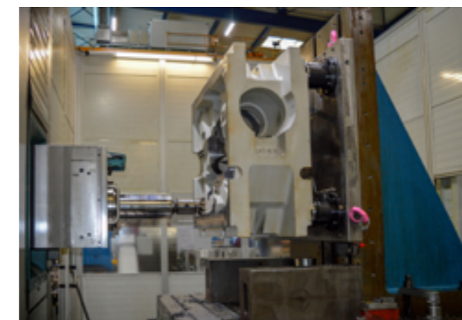
Auf einem Union-Bohrwerk für die Schwerzerspannung kommen zur Werkstückspannung die AMF-Module »K40-H« zum Einsatz.
