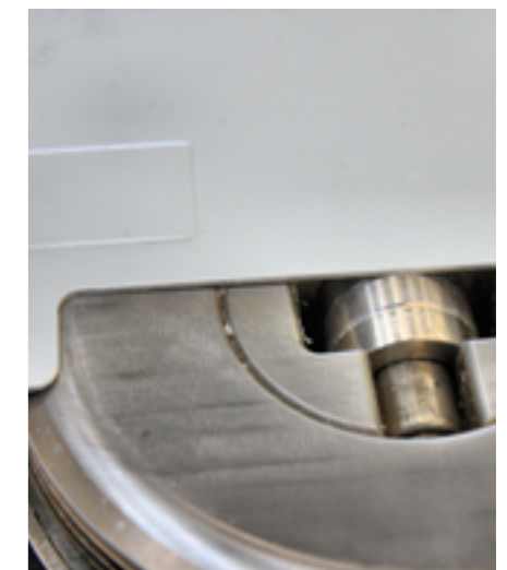
Ein besonderes Werkzeug erlaubt das Entgraten von Ausklinkungen.
