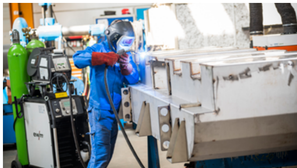
Nahezu spritzerfreies Schweißen der Nähte an einem Düsenkasten von einem Anlassofen. Das coldArc-Verfahren von EWM minimiert den Verzug beim Fügen der Edelstahlbleche.
