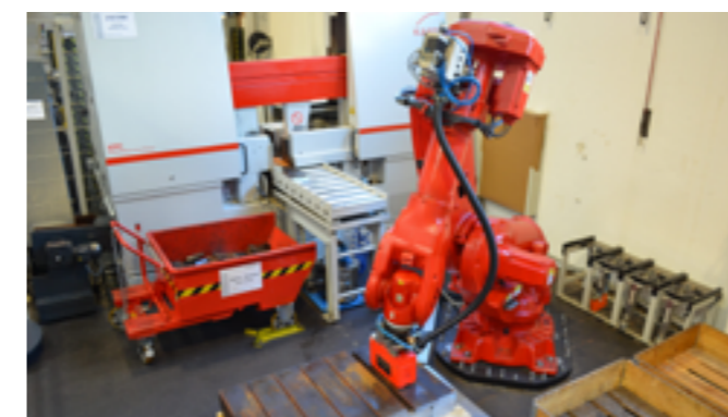
Via Automation ist die Qualität der gesägten Abschnitte höher, denn der Roboter bearbeitet alle Teile gleichmäßig und präzise.
