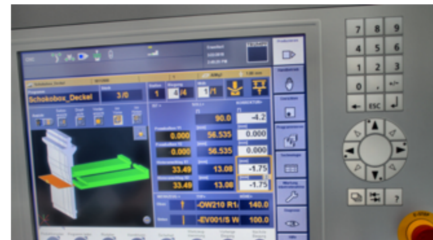
Die Steuerung der TruBend 7036 sorgt dafür, dass das Einrichten und Programmieren der Maschine rasch erledigt ist. Sie kann 3D-CAD-Zeichnungen direkt einlesen und daraus die Biegereihenfolge zur korrekten Biegung des Teils ableiten.
