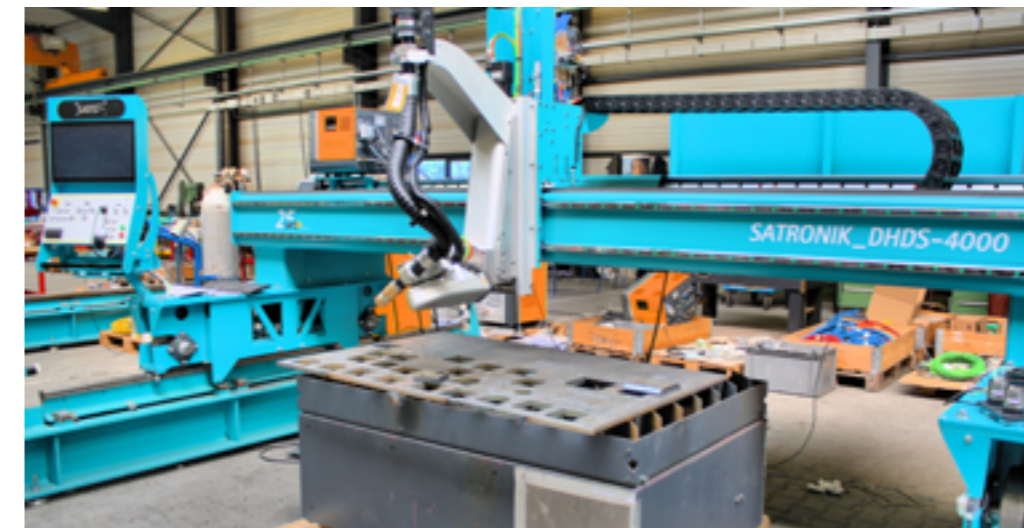
Mit dem dreh- und neigbaren Winkelkopf sind nicht nur Teile rasch ausgeschnitten, sondern auch gleich Fasen bis zu einem Winkel von 50 Grad herausgeschnitten.
