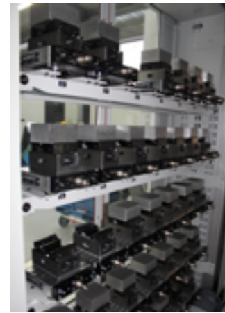
Werkstückmagazin bestückt mit Zentrischspannern von Gressel vom Typ »C2 80 L-130«.
