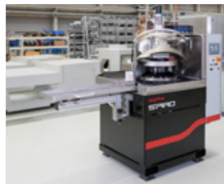
Die ›Spiro F5‹ ist für Werkstücke von 4 bis 150 mm Durchmesser und einer Bauteilhöhe von 0,5 bis 50 mm ausgelegt.
