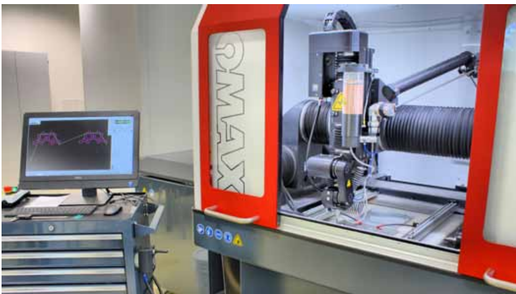
Mit einer Positionier- und Wiederholgenauigkeit von 0,0025 Millimeter kann die Wasserstrahlschneidmaschine ›Micromax‹ des US-Unternehmens Omax aufwarten.
