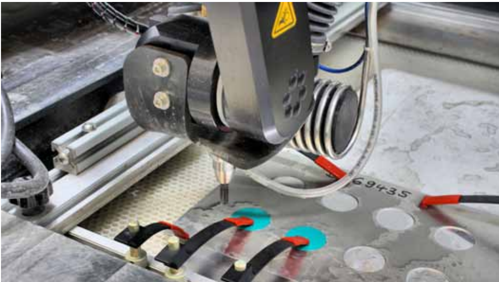
Eine einfache Spannmöglichkeit und die Erzeugung exakt winkliger Flächen mit dem beweglichen Präzisionsschneidkopf ›Tilt-A-Jet‹ sind Merkmale der Micromax.
