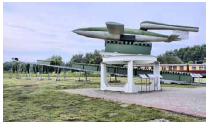
Die als fliegende Bombe konstruierte ›V1‹ wurde per Dampfkata-pult auf etwa 430 km/h beschleunigt, woraufhin das Triebwerk genug Leistung erzeugte, um das Fluggerät in der Luft zu halten.
