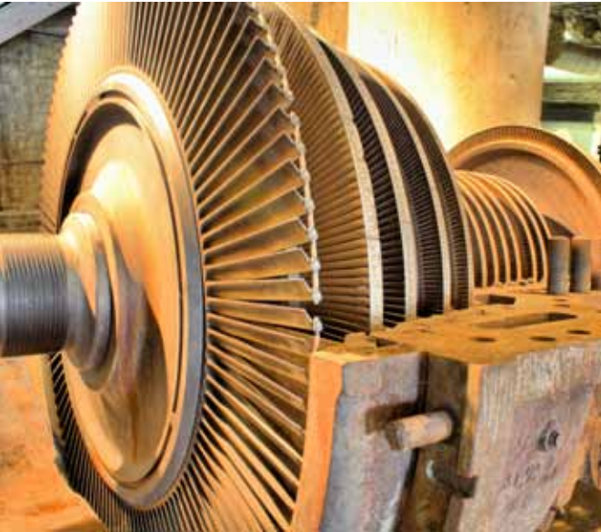
Starke Turbinen erzeugten eine Leistung von 30 MW. Mit dem Strom wurde Sauerstoff verflüssigt und die Bahn, die Wohnanlagen und ein Krankenhaus versorgt.
