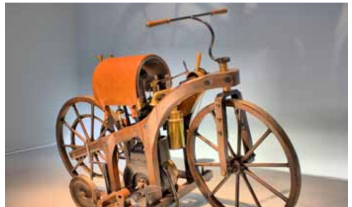
Im Jahre 1885 baute Gottlieb Daimler das erste Motorrad der Welt, das er unter dem Namen ›Reitwagen‹ vorstellte. Dieses Gefährt diente als Versuchsträger für Verbrennungsmotoren.
