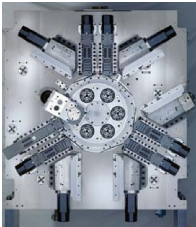
In der Anzahl der Stech-/Bohrschlitten und Kreuzschlitten ist die Maschine individuell konfigurierbar.
