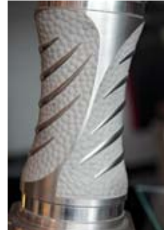
Texturen können auch direkt in ein Prototypenteil eingebracht werden.
