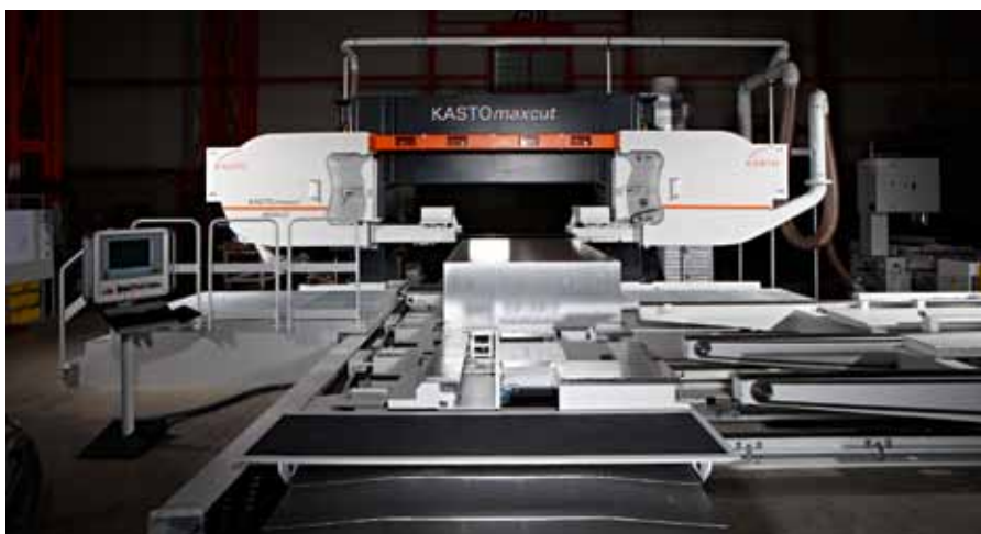
Die Portal-Bandsägemaschine »Kastomaxcut« ist zum vollautomatischen Sägen von Aluminiumplatten mit einer Dicke von sechs bis 2000 Millimetern geeignet.
