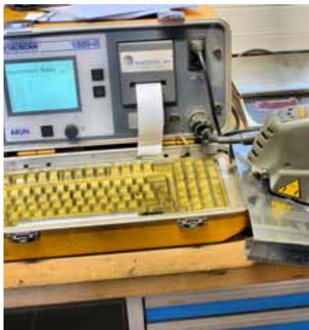
Grundlage sortenreiner Trennung: Die Ermittlung der Legierungsbestandteile.
