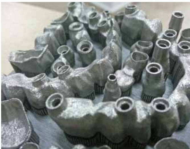
Mit der Metall-Laserschmelztechnik gefertigte Abutments, Kronen und Brücken, die von Fresdental mittels Laserschmelzen hergestellt wurden.
