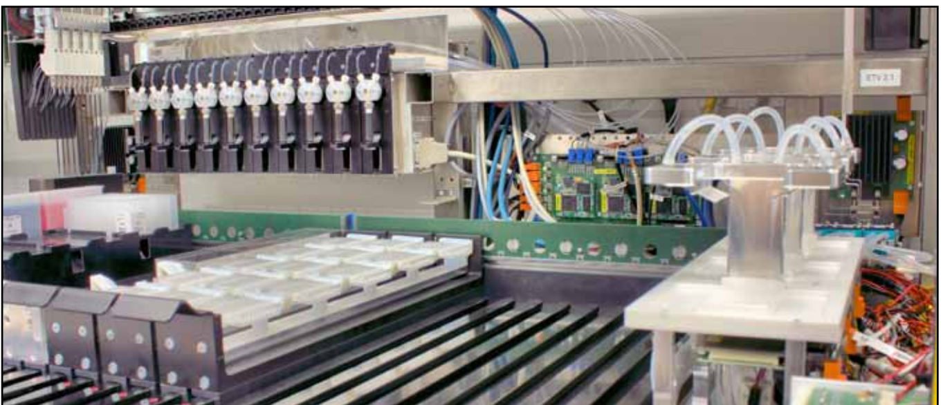
Euroimmun fertigt Medizingeräte für die Blutanalyse. Von diesem Unternehmen wurde beispielsweise der »Eurolabliquidhandler« entwickelt, der vollautomatisch bis zu 500 Proben parallel analysieren kann.
