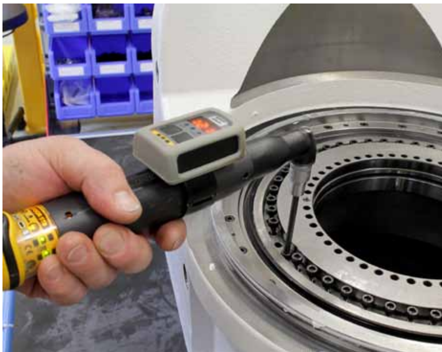
Der Drehtisch der Fräsmaschine ›HPM 450 U‹ hat etwa 540 Schrauben, die mit einem ›Tensor STB‹ von Atlas Copco Tools angezogen werden.
