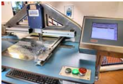
Die Punziersmaschine »Puma VII« ist ein Highlight von Brailletec. Damit werden Zinkplatten für Massendruckmaschinen in Brailleschrift hergestellt.
