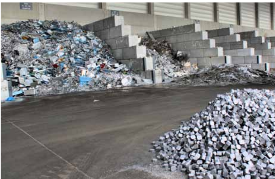
In eigenen Bunkern werden Metallspäne nach Gruppen sortiert gesammelt und an Schmelzwerke verkauft.
