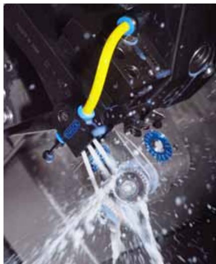
Für Rändelformwerkzeuge der Serien ›Bo‹ und ›B2‹ hat die Quick Tooling GmbH ein innovatives Innenkühlsystem entwickelt.
