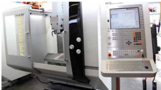
Die dreiachsige Fräsmaschine ›FPS 600U-NC‹ zeichnet sich unter anderem durch hohe Flexibilität und Haltbarkeit aus.
