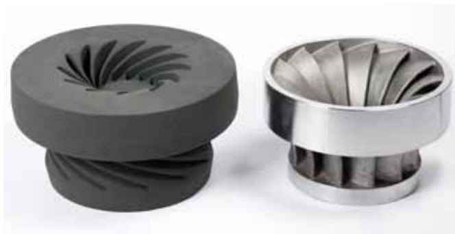
Die Vielseitigkeit der Voxeljet-Maschinen erlaubt sowohl die Produktion von Abformteilen, als auch von Sandgussformen, was die Einzelfertigung von einsatzfähigen Gussteilen erlaubt.
