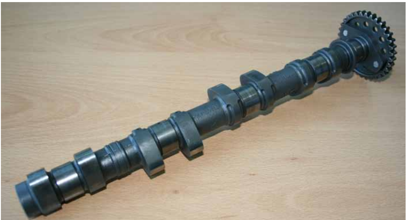
Nockenwellen sind hochbelastete Teile, die akribisch genau ausgelegt werden müssen, damit diese den Belastungen in einem Verbrennungsmotor standhalten. Mit dem kostenlosen FEM-Programm ›Z88Aurora‹ sind solche Berechnungen rasch erledigt.
