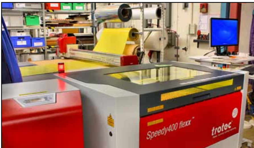
Die Faltlinien können per Laser oder mit Hilfe eines Plotters auf einfache und schnelle Weise aufgebracht werden.
