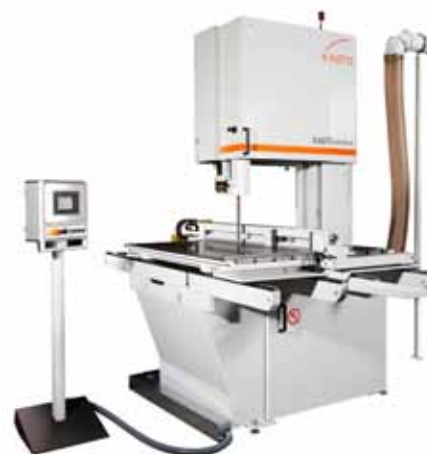
Die »Kastovertical M« ist ideal für die Bearbeitung kleiner Alu-Blöcke und -Platten.
