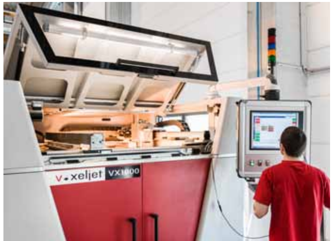
Der innovative Weg zur Gussform 56 Gussformen werden künftig nicht mehr vom Modellbauer erstellt, sondern kommen direkt aus dem 3D-Drucker von Voxeljet.
