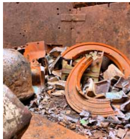
Große Gussteile werden in einer sogenannten „Katzgrube“ zertrümmert.
