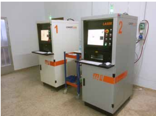
Die Laserschmelzanlagen »Mlab cusing« von Concept Laser sind sehr kompakt gebaut und funktionieren nach dem Schubkastenprinzip. Materialwechsel sind so kein Problem.
