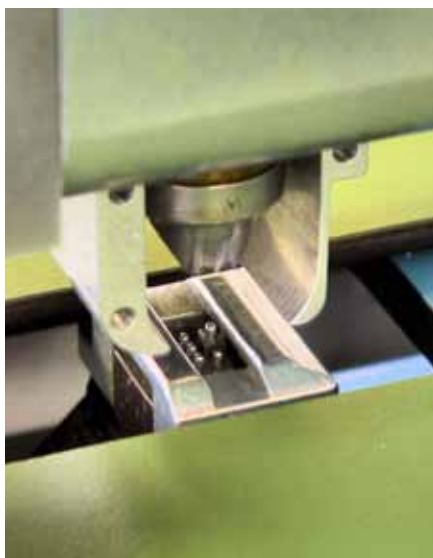
In Punziersmaschinen werden die Stahlstifte von je einem kräftigen Elektromagneten bewegt, damit das Zinkblech zuverlässig verformt werden kann.
