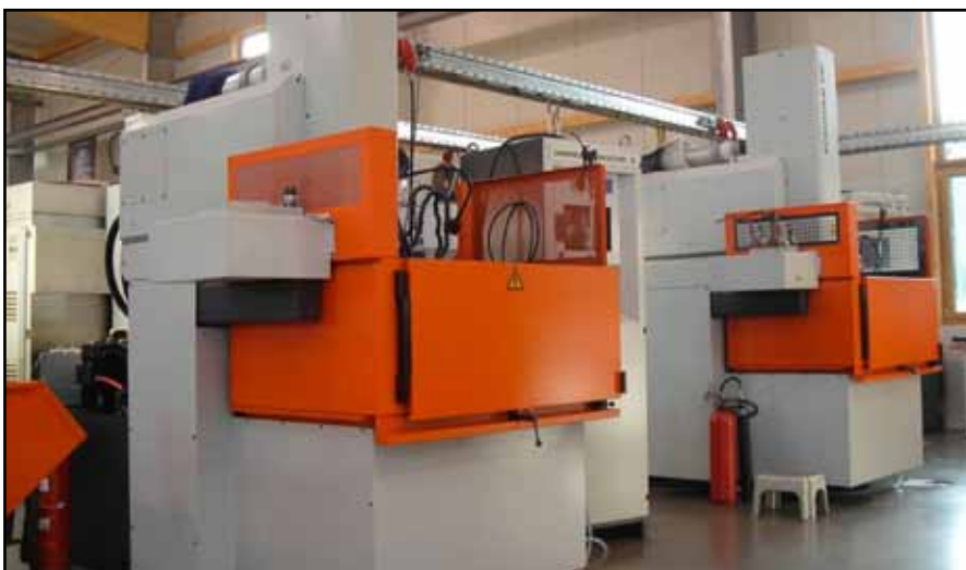
Die AgieCharmilles Drahterodiermaschinen von GF Machining Solutions arbeiten bei Hartex autark, benötigen aber reinstes Prozesswasser mit dauerhaft niedrigem Leitwert, das Geräte der Easymetal Prozesstechnik GmbH zur Verfügung stellen.
