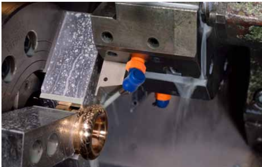
Die Loc-Line-Variante ›Extra Winkelbereich‹ kann in einem großen Radius geschwenkt werden. Das Kühlmittel lässt sich auch unter die Einschraubebene leiten oder zielen.
