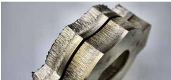
Die Oberfläche des mit einem Festkörperlaser geschnittenen VA-Teils (links) ist wesentlich gröber, als diejenige, die von einem CO 2 -Laser erzeugt wurde.
