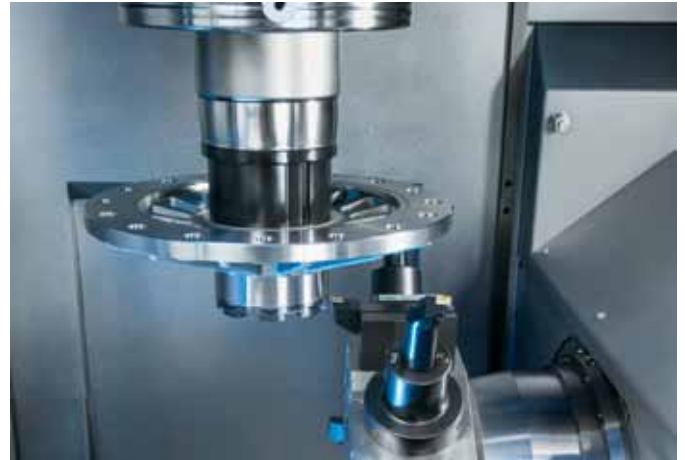
Bis zu 12 Dreh- oder wahlweise 12 angetriebenen Bohr- und Fräswerkzeuge machen vielfältige Bearbeitungen möglich.
