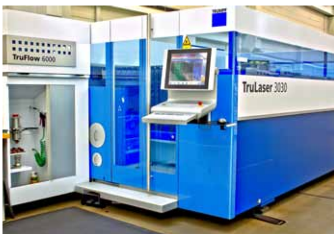
Die TruLaser Serie 3000 liefert Trumpf mit einem CO 2 - oder mit einem Festkörperlaser aus, sodass je nach Teilespektrum das optimale Werkzeug in der Maschine arbeitet. Dank der Flexibilität lassen sich sowohl Blechtafeln, als auch Rohre verarbeiten.
