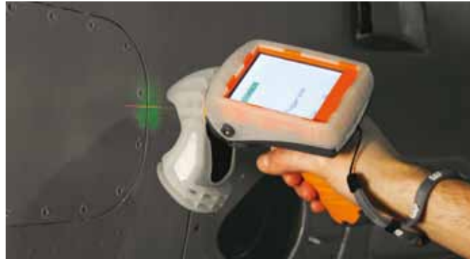
Kabelloses Lasermessen: ›GapGun Pro‹ von Third Dimension
