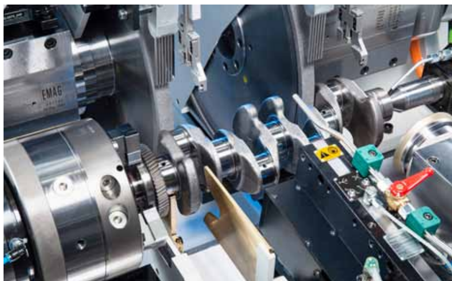
Zwei Schleifscheiben sind bei der ›PMD 2‹ von Emag im Einsatz: Durch die simultane Bearbeitung von zwei Hublagern verkürzt sich die Taktzeit deutlich.
