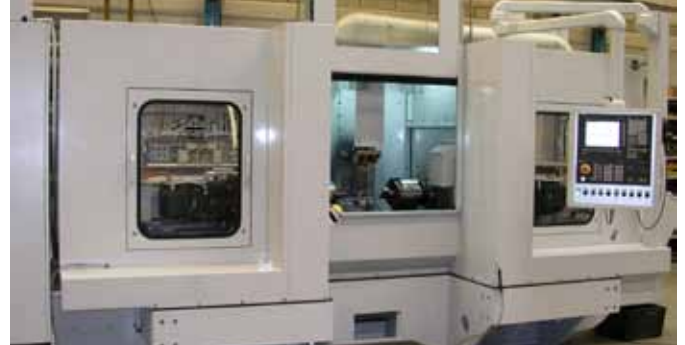
Perfekt: Eine Produktionsmaschine mit Plandreheinheit und Spezialkamera, die die Konturen des Bauteils vermisst.
