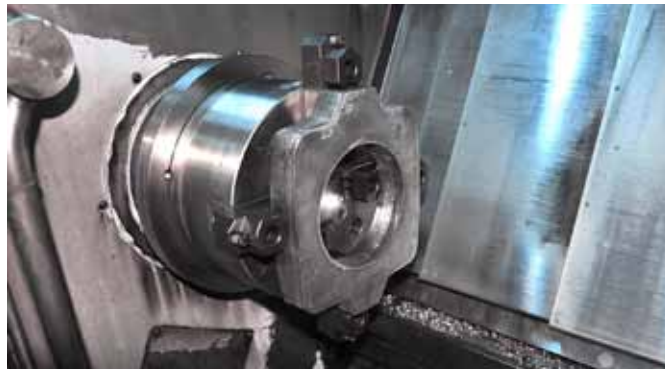
Die NAF Neunkirchener Achsenfabrik AG spannt mit dem Vierbacken-Futter ›InoFlex‹ von HWR Guss- und Brennteile.
