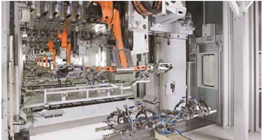
Schuler hat den Crossbar-Feeder zum schnellen und sicheren Transport von Doppel- und Vierfachteilen von Grund auf neu konzipiert.
