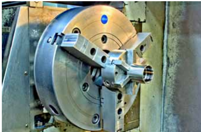
Auf großen Maschinen kann es nützlich sein, ein Sechsbckenfutter direkt im Dreibackenfutter aufzunehmen.
