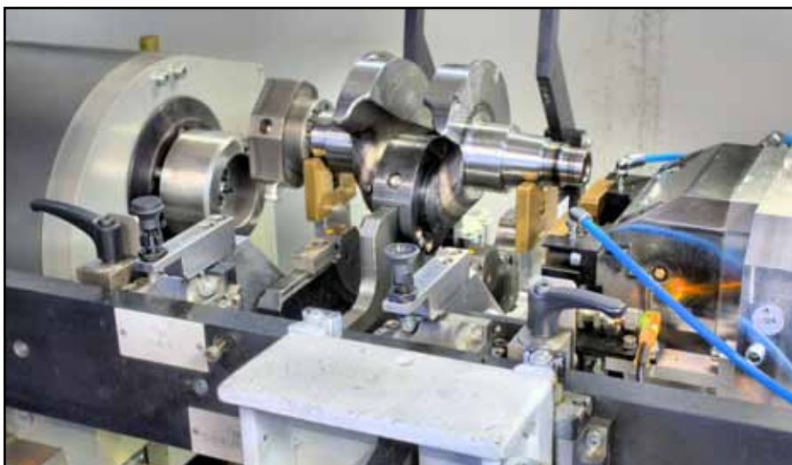
Jede einzelne Kurbelwelle der Hatz-Motoren wird exakt ausgewuchtet, was für ruhigen Motorlauf sorgt.
