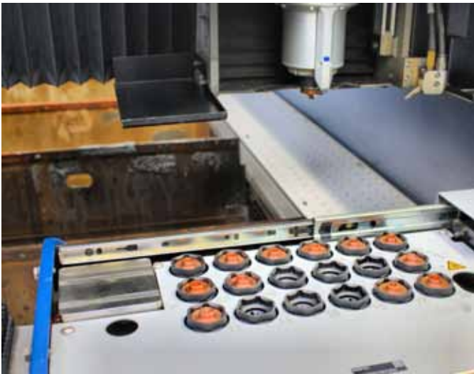
Via Technologiepaket ›Linsen- und Düsenautomatik‹ entfallen alle manuellen Tätigkeiten, die Düsen und Linsen betreffen.
