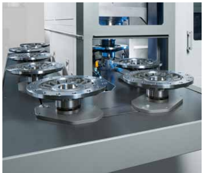
Per Transportband und flexiblen Schlepprahmen gelangen die Werkstücke zur Pick-up-Station. Der Rüstaufwand ist minimal.
