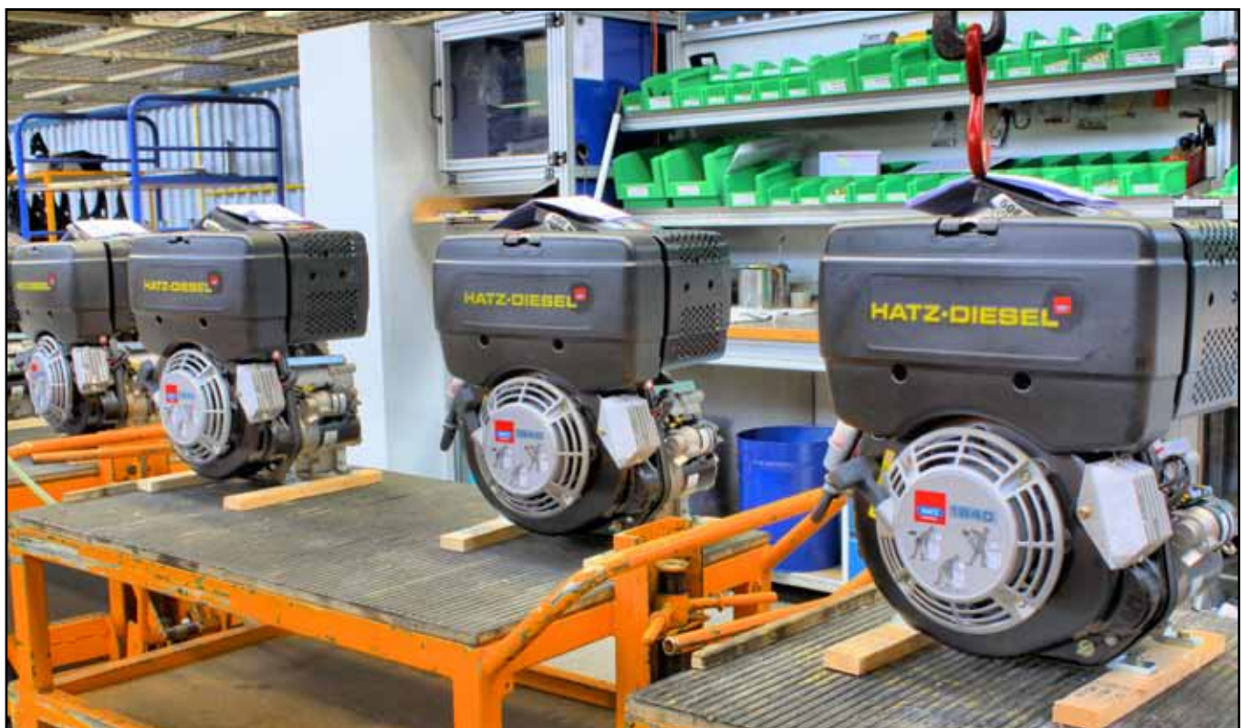
Fertig zum Versand: Dieselmotoren von Hatz werden weltweit exportiert und für Baumaschinen ebenso verwendet wie für Wasserpumpen oder besondere Motorräder, wie sie vom deutschen Unternehmen Sommer gebaut werden.
