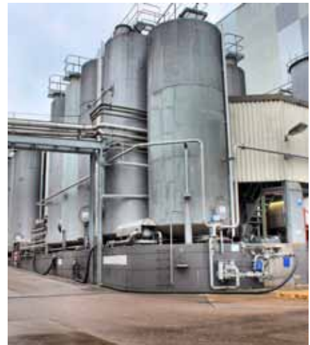
Dem Grundöl werden unterschiedliche Additive zugemischt und alles bei etwa 70 Grad Celsius vermengt.
