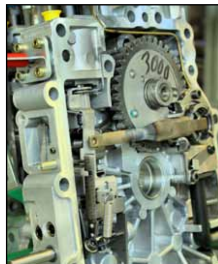
Eine komplexe Mechanik der Steuerplatte sorgt bei Hatz-Motoren dafür, dass der Handstart leicht und komfortabel erfolgt.
