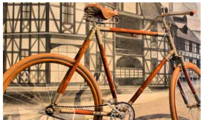
Ein Rad, das zum großen Teil aus Bambus besteht, ist eine Besonderheit der Fahrradabteilung. Das Herrenrad besaß sehr gute Fahreigenschaften und wurde bereits 1898 gebaut.
