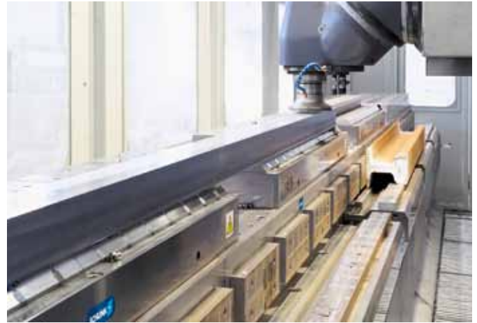
Um Wärmeverzug auszugleichen werden diese Vierkantprofile sowohl am Fuß als auch seitlich per Magnet gespannt.
