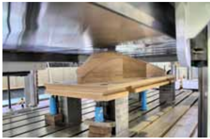
Das stufenweise verformte Blech schmiegte sich am Prozessende eng an die Patrice aus Leimholz an.
