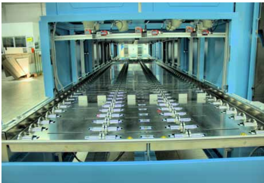
Anlagen mit Degausser und Einhausung sorgen für das rasche und zuverlässige Reinigen von Massenteilen ohne Rückverschmutzung.
