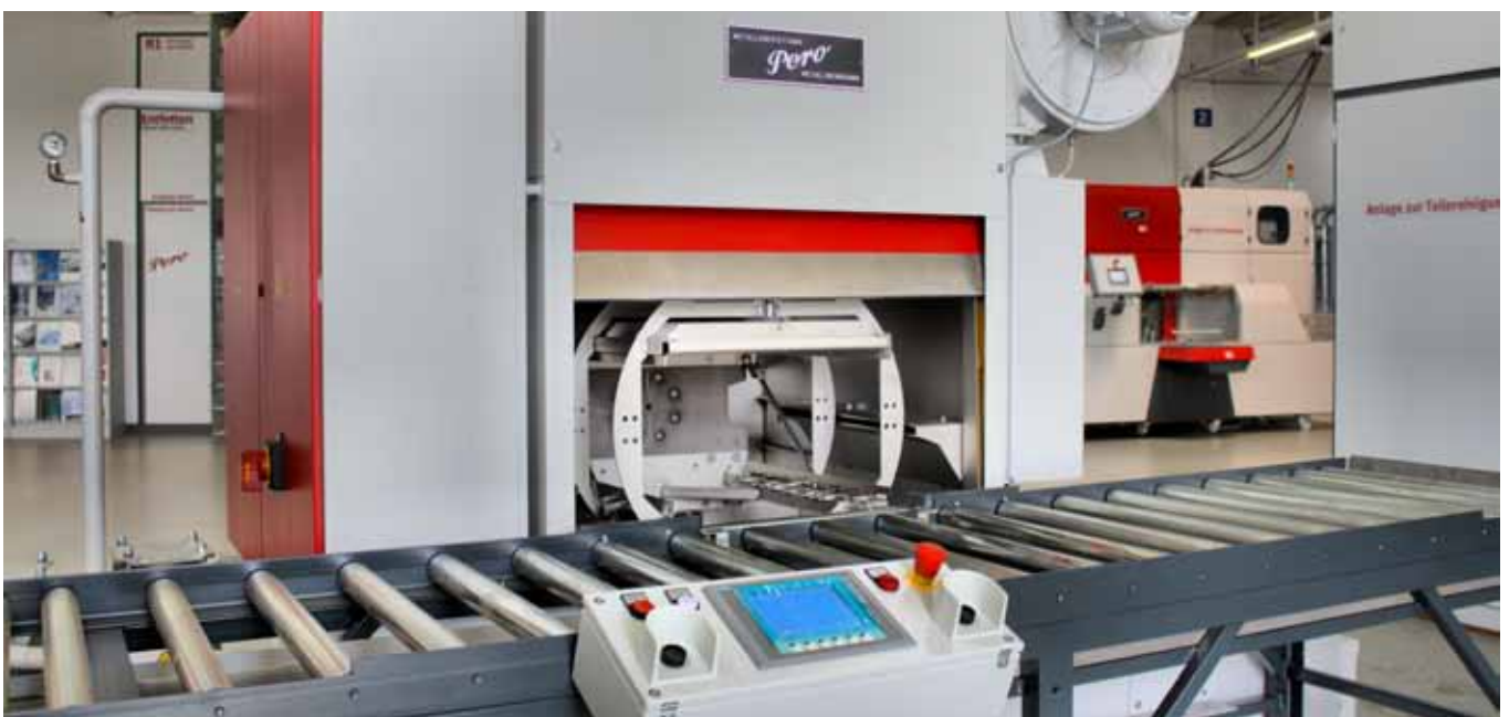
Mit der »Rotimat 3U« hat Pero eine Spritzreinigungsanlage im Programm, die wasserbasierte Reinigungsmedien verwendet und Sacklöcher sowie Kavernen zuverlässig säubert.
