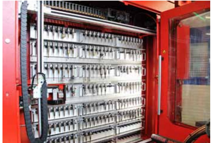
Das Werkstückmagazin der Kern Micro bietet serienmäßig Platz für zweimal 186 Werkzeuge.
