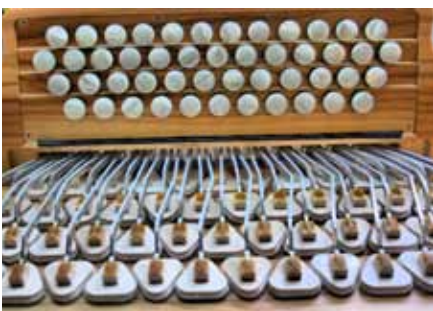
Die Diskantmechanik sorgt für das unmittelbare Öffnen der Verschlussklappe beim Betätigen einer Taste.
