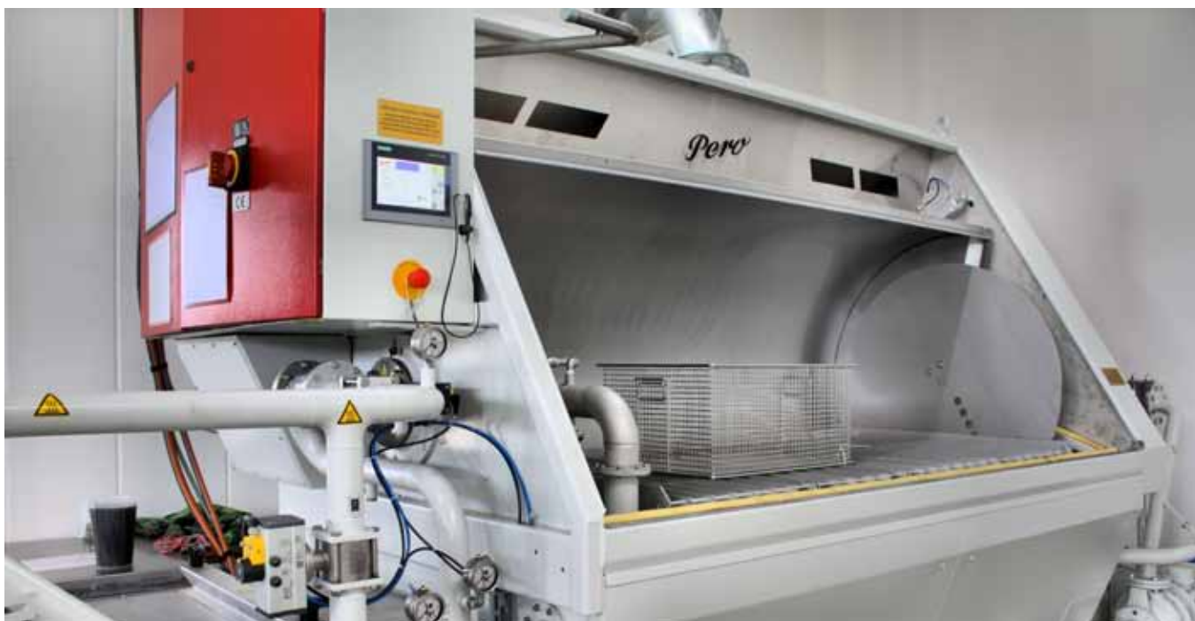
Die Reinigungsanlage ›Robomat‹ ist für wasserbasierte Reinigungsmedien ausgelegt und kann Teile bis zu zwei Tonnen Gewicht und drei Metern Länge aufnehmen.
