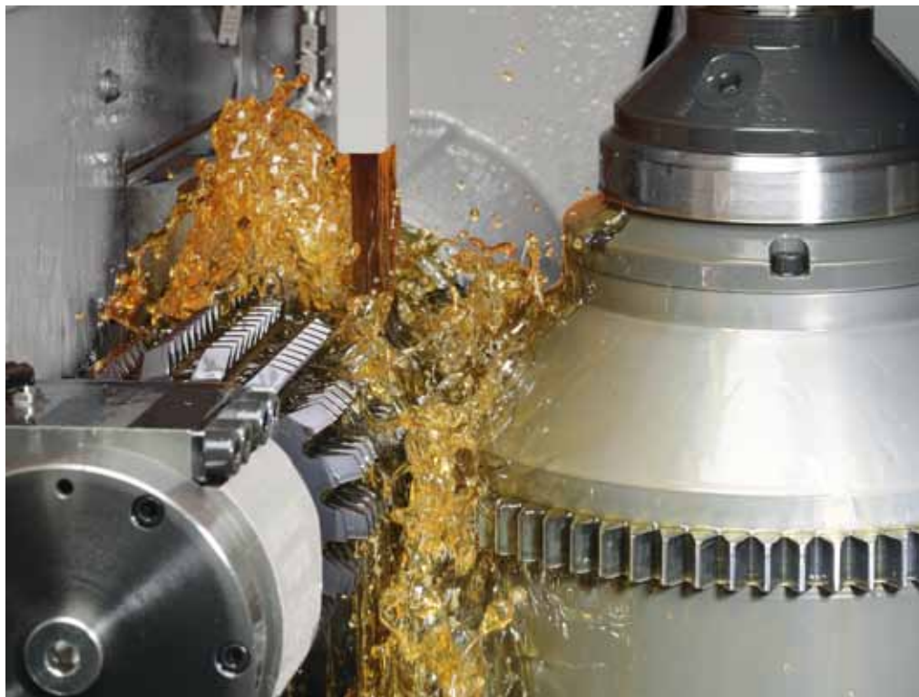
Die Wälzfräsmaschine LC 280 \alpha erlaubt den Einsatz von Hartmetall-Wendepaltenfräsern, wodurch bei bestimmten Anwendungen die Prozesszeit um bis zu 30 Prozent gesenkt werden kann.
