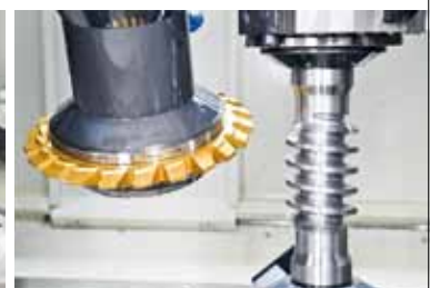
Schneckenfräsmaschine LC 80 WD Hauptzeitparalleles Anfasen und Bürsten
