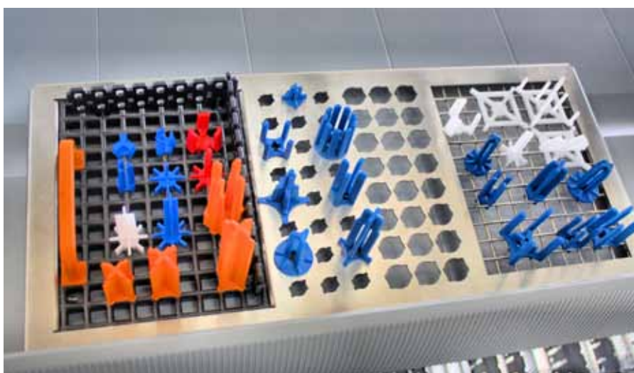
Spezielle Warenträger ermöglichen das sichere Fixieren der zu reinigenden Teile, sodass diese beim Reinigen nicht beschädigt werden.
