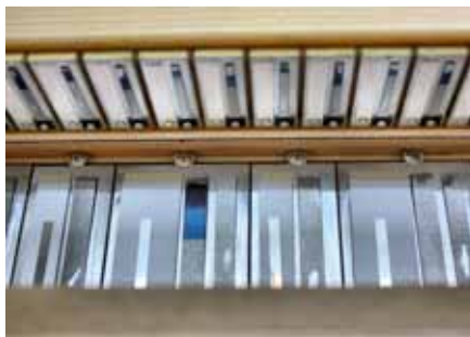
Die hellen Stellen an den Stimmzungen zeigen, dass nur wenig Material zum Stimmen abgenommen werden muss.
