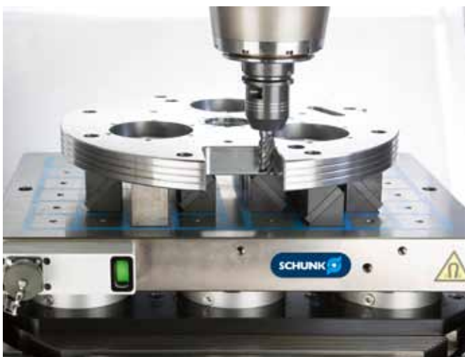
Über die Statusanzeige (hier grün) wird der Spannzustand von Magnos-Quadratpolplatten signalisiert. Zusätzlich kann der Status über die Steuereinheit »KEH plus« abgefragt und an die Maschinensteuerung übertragen werden.
