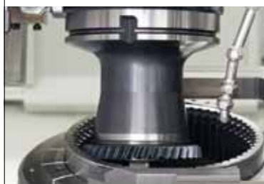
Wälzschälmaschine LK 180/280 DC Hauptzeitparalleles Anfasen inkl. Drehen, Bohren, Fräsen und Messen
