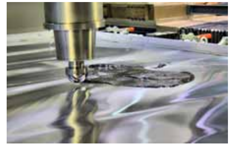
Damit der Umformprozess problemlos vonstattengeht, ist eine Fettschmierung eine wichtige Voraussetzung.
