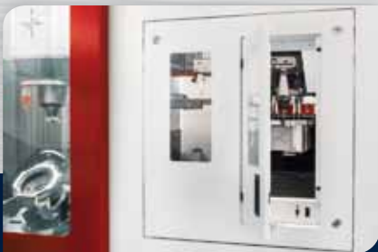
80-fach Werkzeugmagazin, von vorne bedienbar
