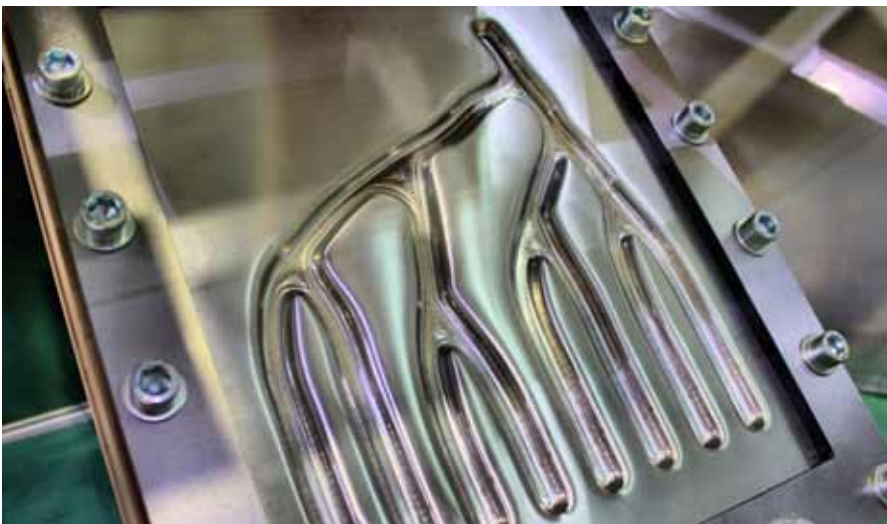
Die inkrementelle Blechumformung erlaubt auch die Einarbeitung von feinen und kleinen Details.
