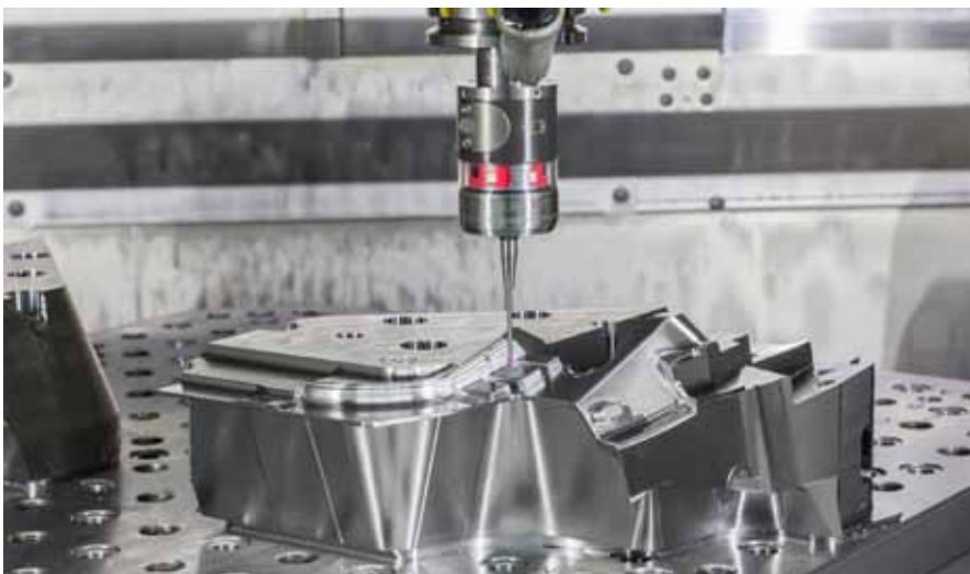
Mit der Messsoftware ›FormControl‹ und den Messtastern von Blum lassen sich komplexe Formen blitzschnell im Bearbeitungszentrum messen.
