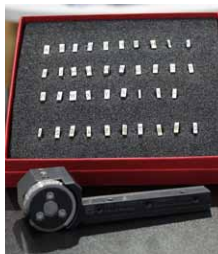
Das 432-System besteht aus Segmentträgern und austauschbaren Segmenten.
