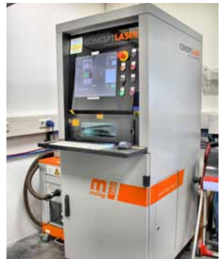
Neben der M2 hat Weber die ›Mlab cu- sing‹ im Einsatz. Diese ist besonders zum Herstellen filigraner Strukturen geeignet.
