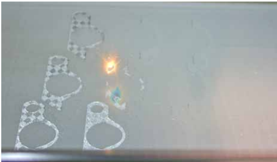
Ein Kontrollsystem überwacht via Digitalkamera jede frisch aufgetragene Pulverschicht auf Fehler. Dies verlangsamt zwar den Erstellungsprozess um rund 35 Prozent, doch werden auf diese Weise Aufbaumängel verhindert.
