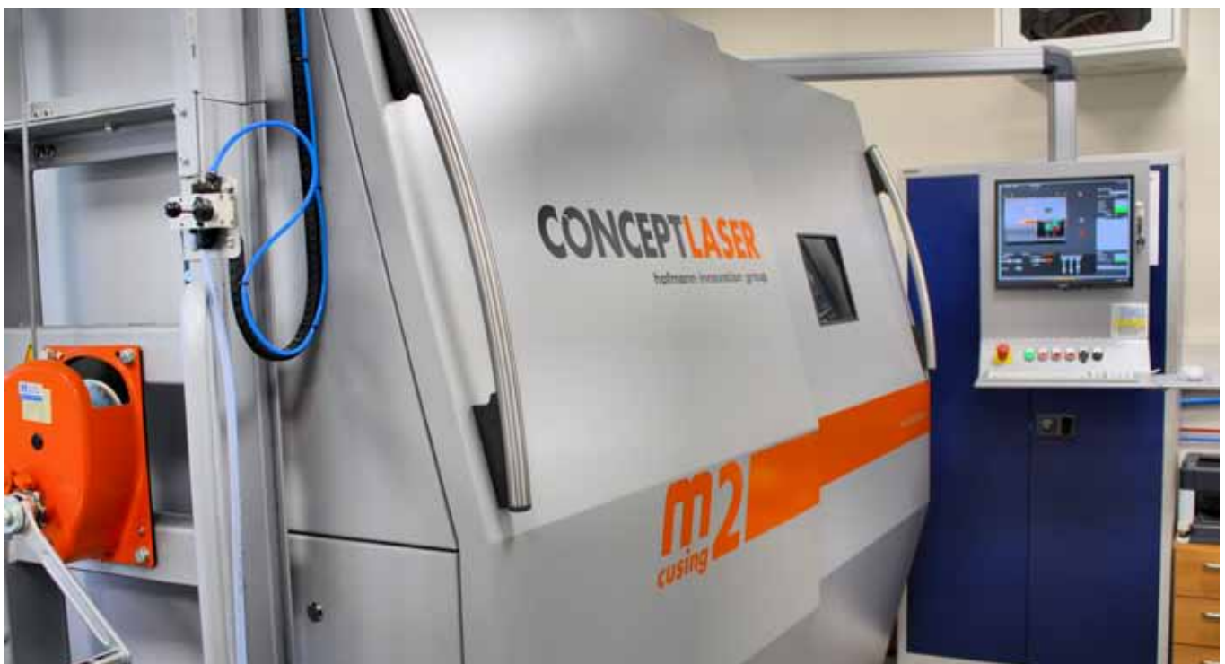
Die bei Weber KP installierte ›M2 using‹ von Concept Laser ist nach Atex-Richtlinien konstruiert. Sie verfügt über einen geschlossenen Schutzgaskreislauf sowie über eine räumliche Trennung von Prozesskammer und Handhabungsbereich.
