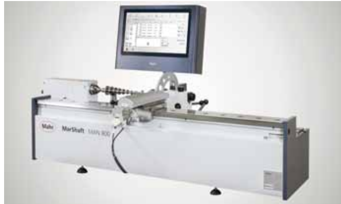
Produktiv Wellen messen: manueller Wellenmessplatz von Mahr.
