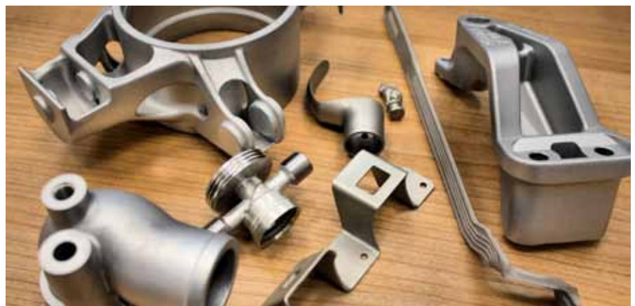
Das Laserschmelzen von Metallen hat die Fertigung von Teilen revolutioniert. Nun sind Teile möglich, die früher aus mehreren Modulen bestanden oder in der gewünschten Weise gar nicht herstellbar waren.
