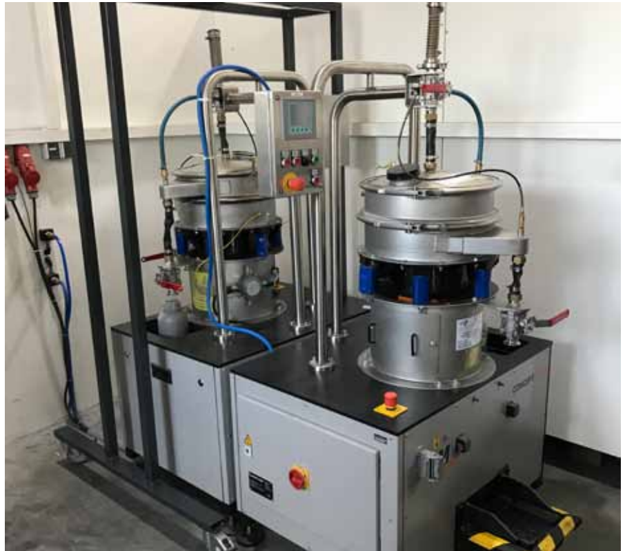
Eine effektive Filteranlage sorgt für die Trennung der noch nutzbaren Metallpulverreste von unbrauchbaren Rückständen. Auf diese Weise werden die Stückkosten massiv gesenkt. Für verschiedene Korngrößen ist die Anlage rasch umrüstbar.
