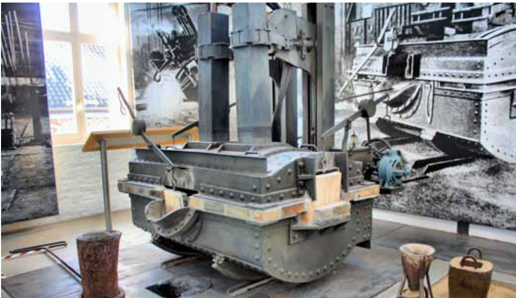
Ein originaler Lichtbogenofen von 1906 gibt Einblick in eine faszinierende Technik, besonders hochwertigen Stahl zu erschmelzen. Dieser Ofen war bei den Richard-Lindenberg-Stahlwerken in Remscheid im Einsatz.
