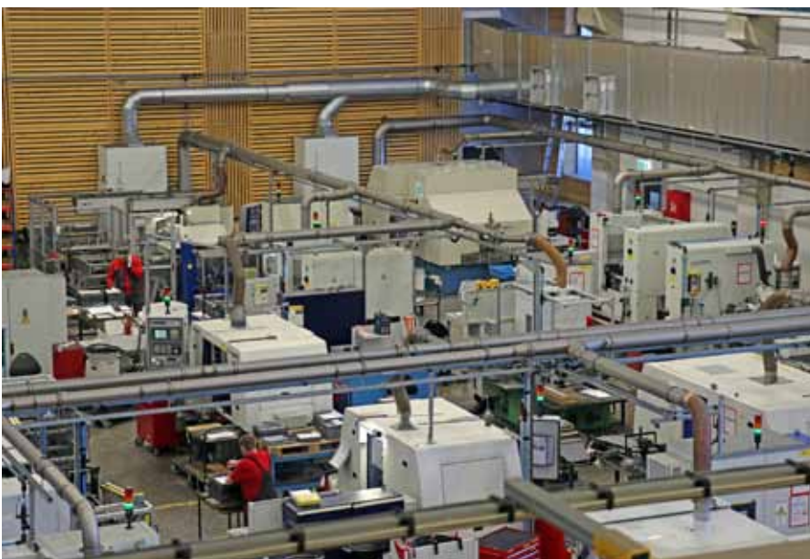
Blick in eine Fertigungshalle bei Ceratizit, in der HM-Wendeschneidplatten geschliffen werden. Für deren hohe Qualität ist die Feinstreinigung des Schleiföls unerlässlich.
