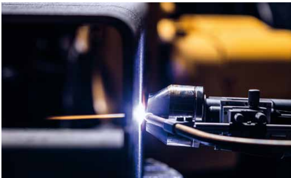
Das WIG-Verfahren ›Arctig‹ von Fronius sorgt für hohe Schweißgeschwindigkeiten und eine hervorragende Nahtqualität.
