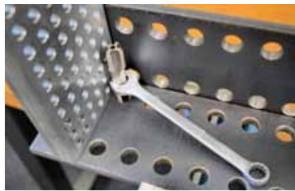
»HexTap« heißt der Problemlöser, der es erlaubt, Gewinde an kritischen Stellen neu zu schneiden oder zu reparieren.
