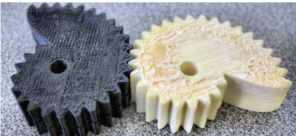
Das mit Epoxidharz gefüllte Teil (rechts) besitzt im Gegensatz zum vollständig aus Filamentmaterial bestehenden Teil rund 65 Prozent der Zugfestigkeit eines spritzgegossenen Teils.
