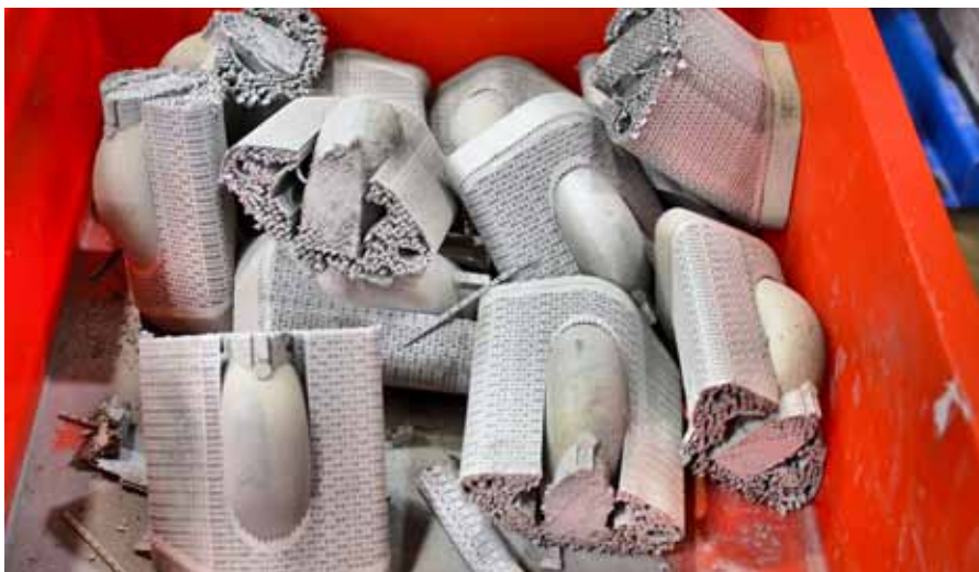
Bauteile direkt nach dem Absägen von der Trägerplatte. Die korrekte Anordnung der Stützstrukturen ist eine wichtige Voraussetzung für korrekt aufgebaute SML-Teile.
