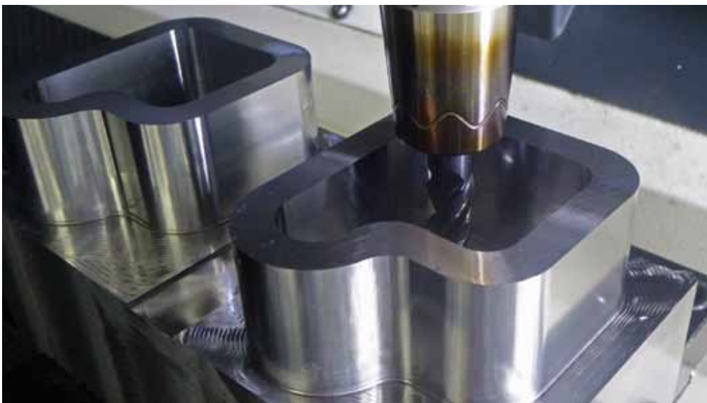
Mit trochoidalem Fräsen kann der Anwender bis zu dreimal schneller und tiefer fräsen. Ideale Werkzeuge für diese Bearbeitung sind Haimers Power Mill-Fräser mit Safe-Lock-Futter.
