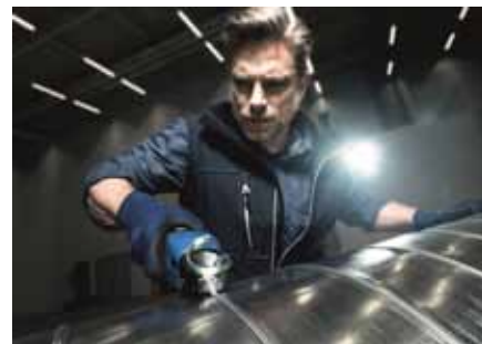
Bis zu zwei Millimeter dicke Bleche trennt die Schlitzschere ›Trutool C 200‹.
