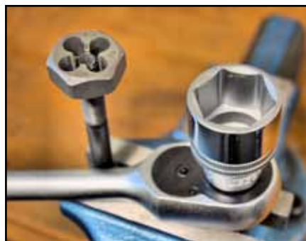
Zum Antrieb der Schneidemuttern kann ein passender Maulschlüssel oder – wie auf dem Bild – ein Steckschlüssel mit Ratsche verwendet werden.
