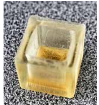
Wasserlösliche Kunststoffe ermöglichen Teile, die komplett aus Füllmaterial bestehen.
