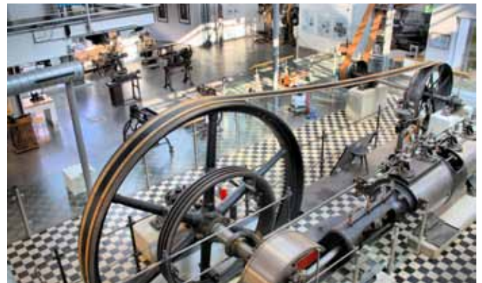
Im Museum zeigt eine gewaltige Dampfmaschine, wie in der industriellen Anfangszeit Werkzeugmaschinen per Transmissionsantrieb betrieben wurden.
