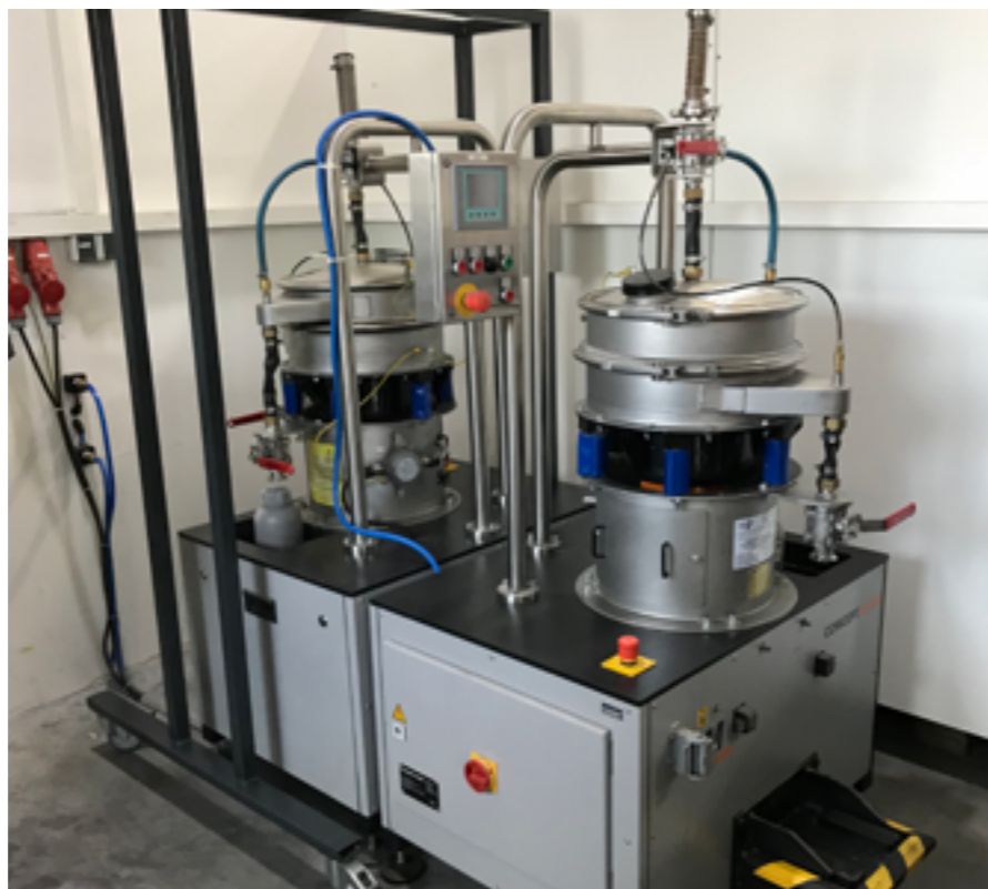
Eine effektive Filteranlage sorgt für die Trennung der noch nutzbaren Metallpulverreste von unbrauchbaren Rückständen. Auf diese Weise werden die Stückkosten massiv gesenkt. Für verschiedene Korngrößen ist die Anlage rasch umrüstbar.
