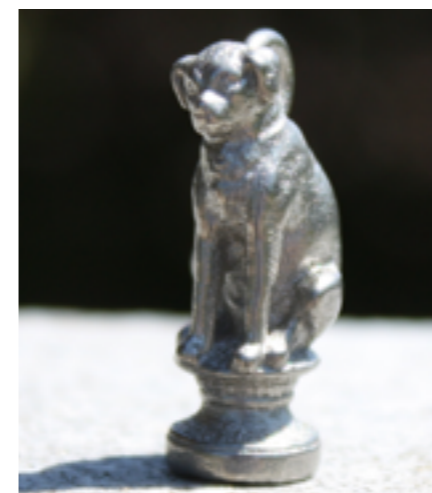
Das »Brettener Hundle« wurde als digitales Abbild per Laserscanner erfasst und anschließend auf der M2 ausgedruckt.
