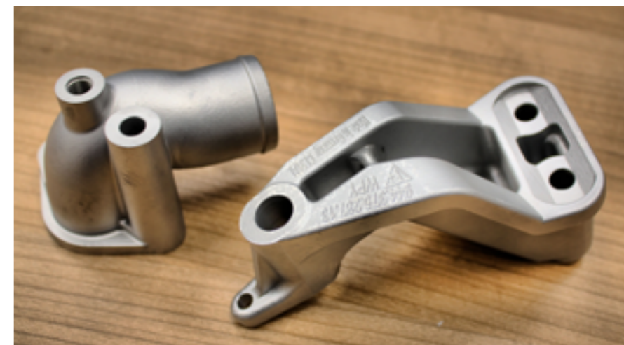
Insbesondere Oldtimer können dank SLM-Technik in Schuss gehalten werden, wie diese Porsche-Teile zeigen, die von Porsche Classic vertrieben werden. Sie stehen den nicht mehr erhältlichen Originalteilen in nichts nach.
