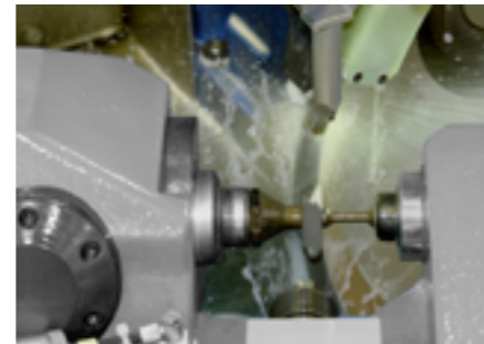
Zum Schleifen von Hartmetall ist höchste KSS-Reinheit Voraussetzung.
