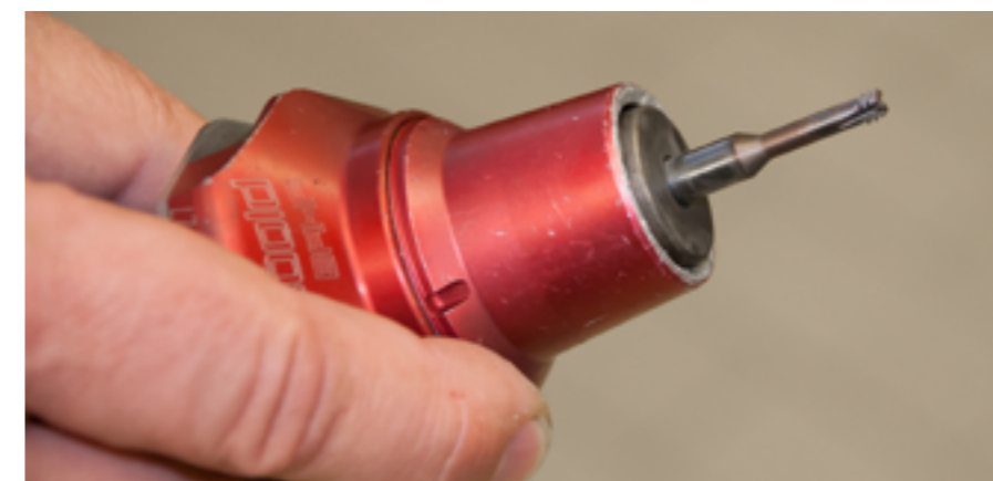
32 Gewinde der Größe M6 eines gehärteten Formeinsatzes waren Dank des Gewindefräasers »EDT-1.0-15-TH« von MMC Hitachi Tool nach einer halben Stunde fertig gefräst.
