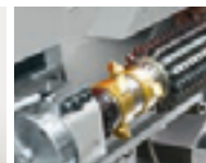
Anfasen im Arbeitsraum
