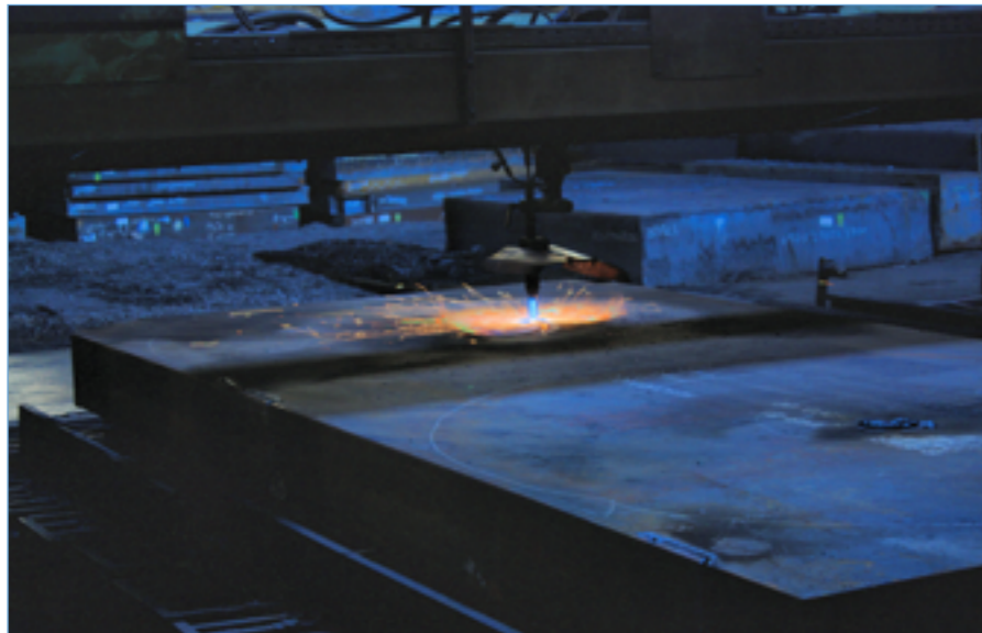
Brennschneidmaschinen von Sato sind bekannt für ihre hohe Zuverlässigkeit. Diese Anlagen sind problemlos für über 60 000 Betriebsstunden gut.
