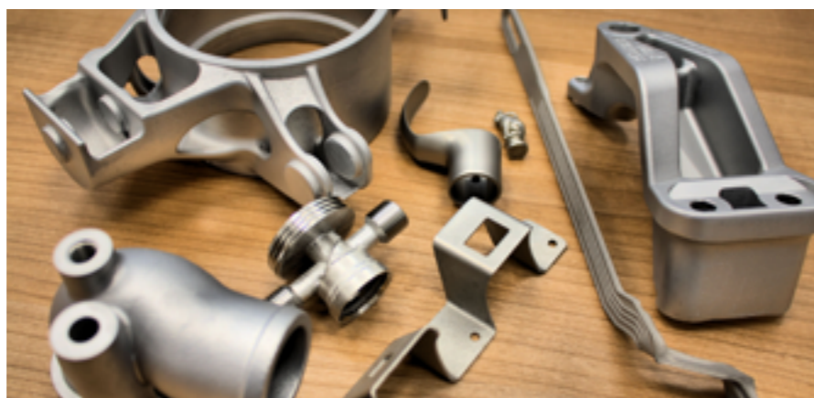
Das Laserschmelzen von Metallen hat die Fertigung von Teilen revolutioniert. Nun sind Teile möglich, die früher aus mehreren Modulen bestanden oder in der gewünschten Weise gar nicht herstellbar waren.
