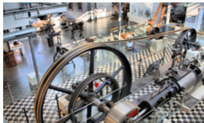
Im Museum zeigt eine gewaltige Dampfmaschine, wie in der industriellen Anfangszeit Werkzeugmaschinen per Transmissionsantrieb betrieben wurden.
