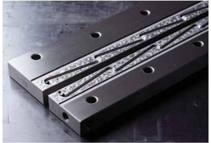
Handgeschabte Führungsbahnen werden in rund zehnstündiger Arbeit je Bahn handgeschlichtet.
