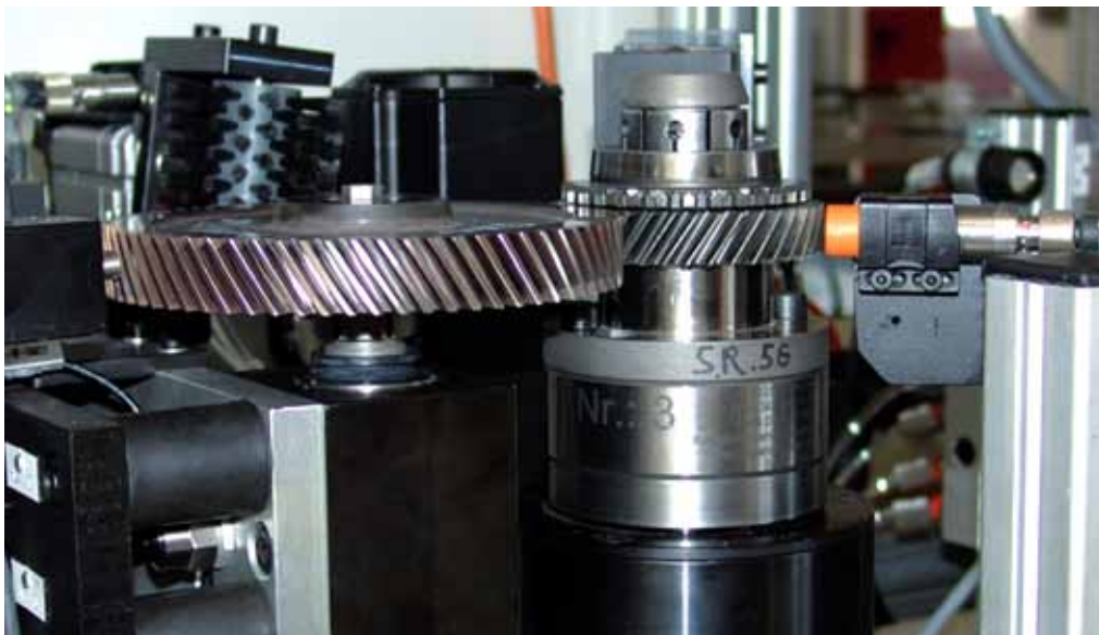
Einsatz eines Standard-Spannzeugs der Baureihe ›Kegelbüchsen-Flanschdorn‹ bei der Prüfung der Verzahnungsgüte von Zahnrädern.
