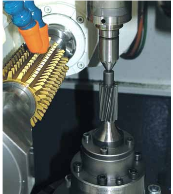
Einsatz eines Komplett-Spannzeugs vom Typ ›Kegelhülsen-Flanschfutter‹ beim Fräsen der Zahnflanken eines Pumpenrads.
