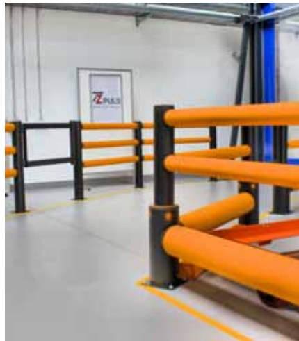
Anfahrtschutzsysteme von A-Safe leiten Routenzüge sicher durch die Fertigung.
