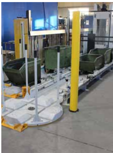
Volle Spänekübel werden auf den Zuführförderer geschoben, alles weitere erledigt die Anlage selbsttätig.
