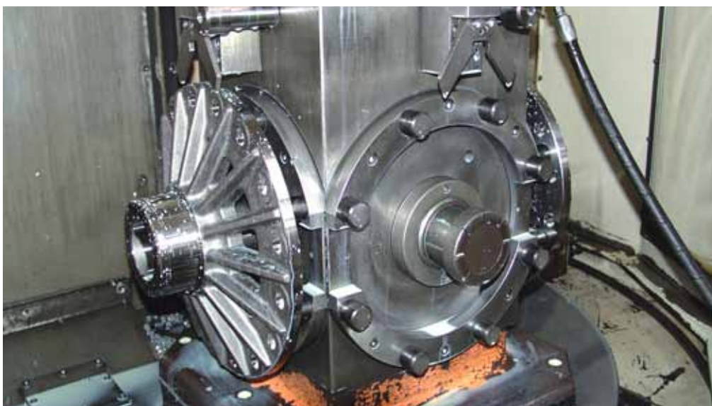
Einsatz eines Komplett-Spannzeugs der Baureihe ›Kegelhülsen-Spanndorn‹ in einem Bohr-Fräszentrum zur Bearbeitung von Lkw-Ausgleichshäusen.
