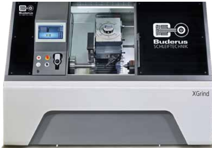
Die ›Xgrind‹ von Buderus ermöglicht kombinierte Dreh- und Schleifbearbeitungen. Ein integrierter Messtaster steuert die Bearbeitung bis zum Erreichen des Endmaßes.
