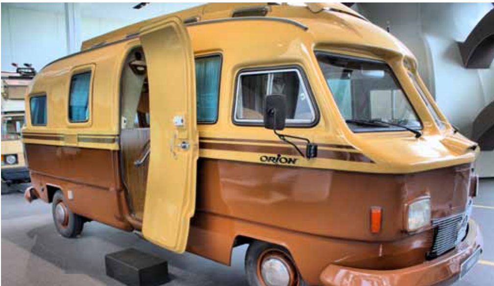
Das Unternehmen Schäfer baute in den 1970er Jahren die wunderschönen Orion-Modelle. Dies war das erste integrierte Wohnmobil mit eigenständiger Kunststoff-Karosserie. Der Aufbau war sehr leicht, stabil und zudem absolut verrottungsfrei.
