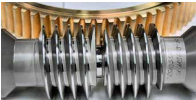
In der ATC-Reihe kommt ein Präzisions-Schneckengetriebe vom Typ ›Ott‹ zum Einsatz. Durch eine Zweiteilung der Schnecke kann bei diesem Getriebe das Zahnflankenspiel eliminiert werden.
