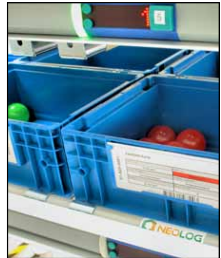
Lichtschrankensperren und Stückzahlvorgaben sorgen für eine irrumsfreie Teileentnahme.
