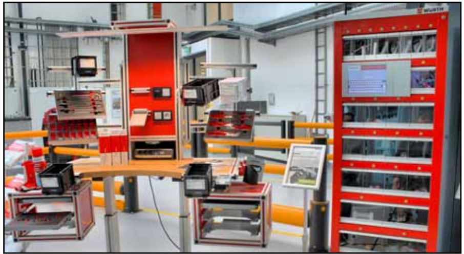
Moderne Montageplätze sind höhenverstellbar, übersichtlich und ergonomisch. Ein Konsignationslager versorgt den Monteur mit Verschleiß- oder Ersatzteilen.
