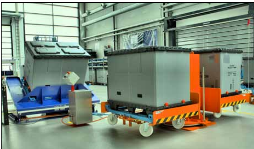
Besondere Dreh- und Kippeinrichtungen ermöglichen ein platzsparendes und ergonomisches Teilehandling im Fertigungsbereich.
