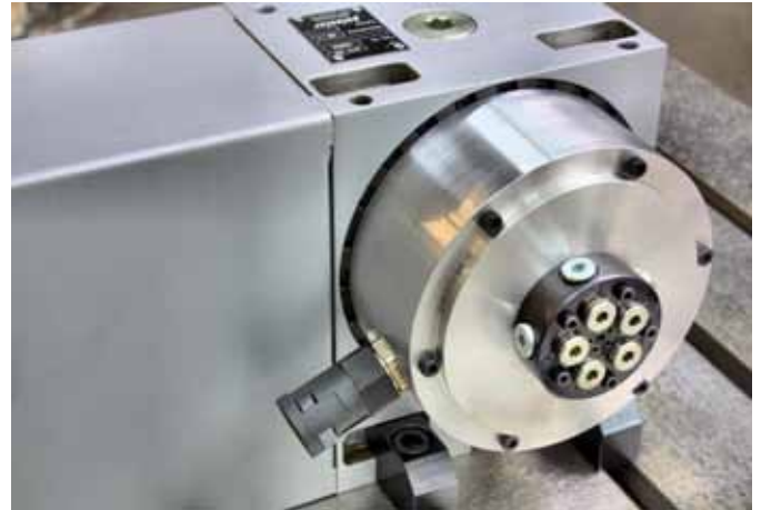
Auf der Rückseite des Teilapparats sind Hydraulik- oder Pneumatikanschlüsse vorhanden.
