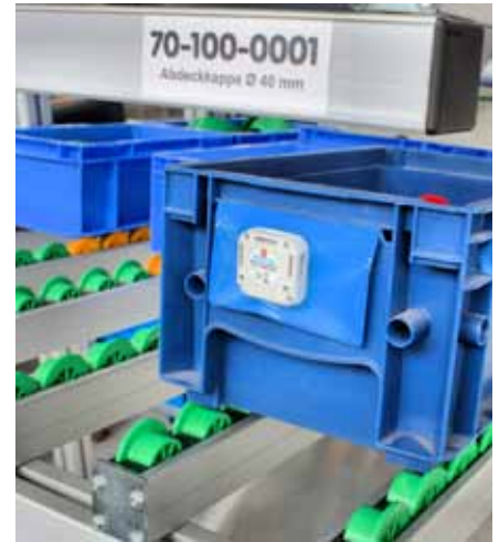
Via UWB-Funktechnik sind Teilebehälter jederzeit lokalisierbar.
