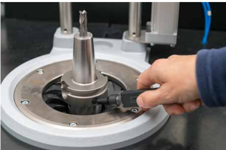
Im TDSc-Chip von Bilz können Einstelldaten für Schrupfgeräte eingespeichert werden. Dadurch werden Schrupfvorgänge absolut perfekt und ohne Werkzeugbeschädigung ausgeführt.
