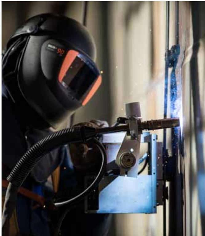
Innovative Schweißtechnik von Kemppi: Schweißen der Blockabschnitte eines Eisbrechers mit dem A5 MIG Rail System 2500 und einer Fastmig M 520-Stromquelle.
