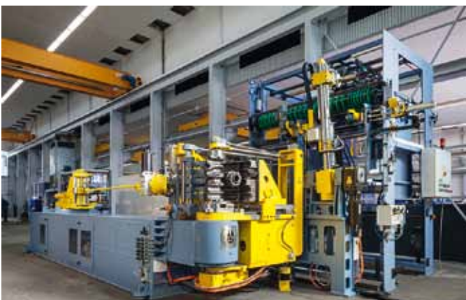
Schwarze-Robitecs automatische Biegezellen erlauben eine automatisierte Herstellung von gebogenen Rohrsystemen.
