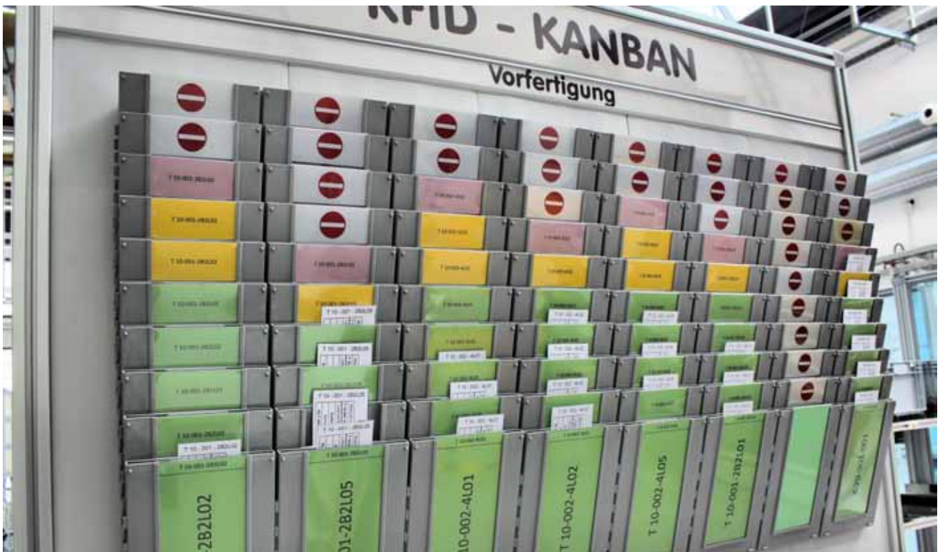
Das Kanban-System ist genial einfach und extrem wirkungsvoll. Jedes Unternehmen kann damit ohne EDV-Unterstützung stets eine zuverlässige Teileversorgung sicherstellen. Sobald eine Karte den gelben Bereich erreicht, muss gehandelt werden.
