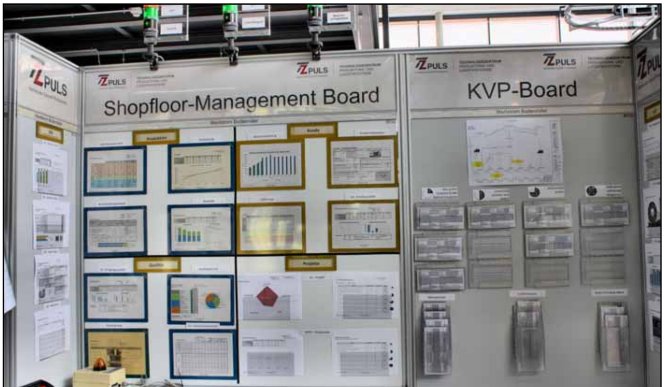
Das Shopfloor-Management Board informiert umfassend über den Status in der Produktion. Hier sind Infos etwa zur Fertigungsqualität, zur Liefertreue oder zur Absatzentwicklung zu finden. Ein Ideenmanagement rundet das positive Bild ab.
