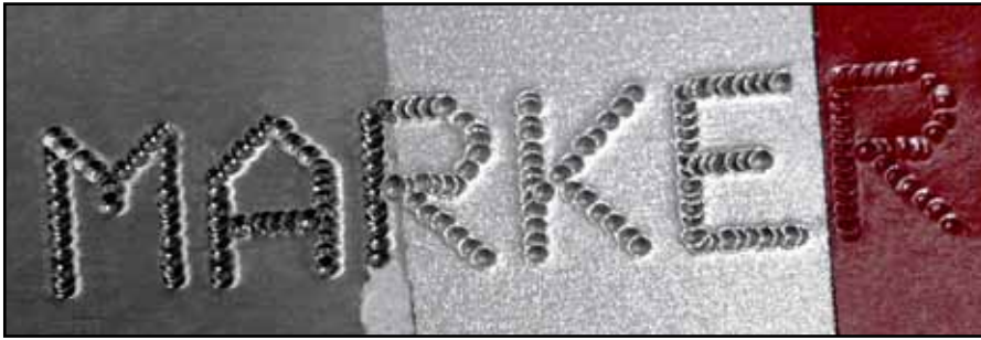
Von links nach rechts: Markierung auf Stahl, sandgestrahlte Markierung, sandgestrahlte und lackierte Markierung. Eine per Nadelprägung aufgebrachte Markierung ist dauerhaft und sorgt für das zuverlässige Erkennen eines Originalbauteils.
