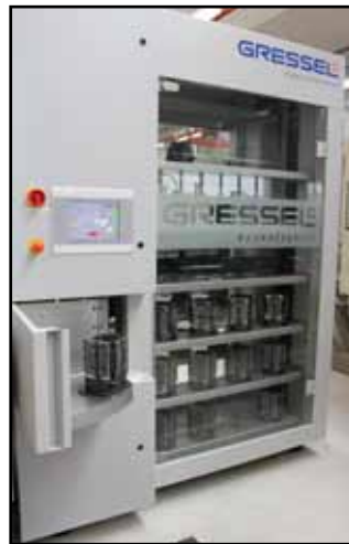
Der »P60« lässt sich mit bis zu 60 Spannmitteln beladen.
