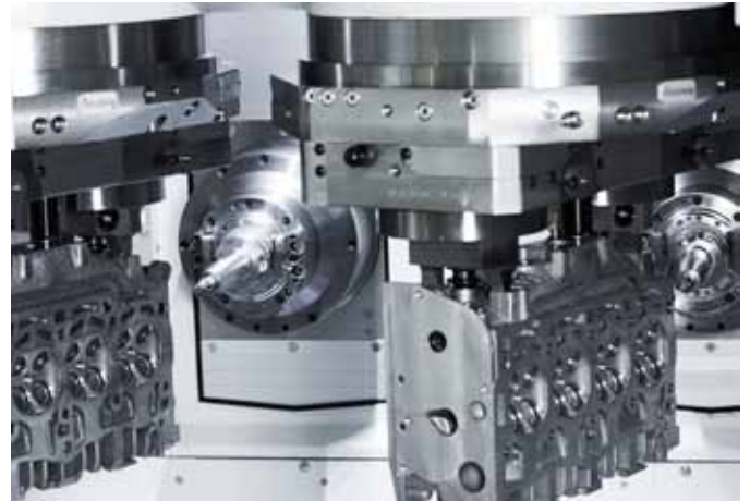
Hightech im Standard – die Überkopfbearbeitung beim Doppelspindler ›Specht 450 Duo‹ sorgt für freien Spänefall.
