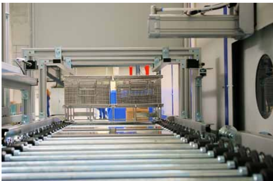
Eine automatisierte Beschickung der Reinigungsanlage erhöht zwar die Investitionskosten, reduziert aber den Personalaufwand im laufenden Betrieb.
