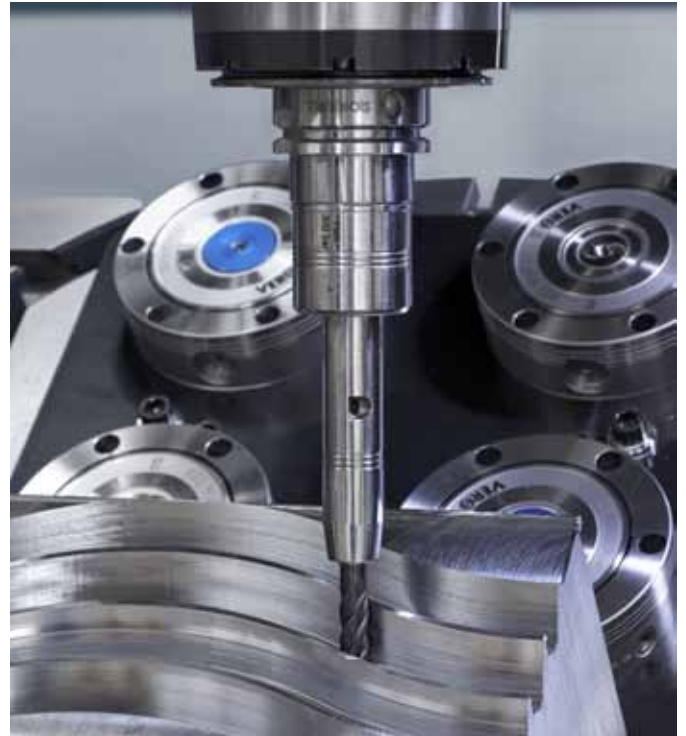
Schlank: Mit der Hydro-Dehnspannverlängerungen ›Tendo SVL‹ lassen sich auch enge Räume präzise und kraftvoll bearbeiten.
