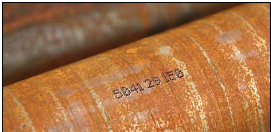
Eine Nadelmarkierung auf Stahl stellt sicher, dass das Material zweifelsfrei zu identifizieren ist, nachdem es eingelagert wurde. Anders als Farben ist diese Kennzeichnung nur schwer wieder zu entfernen und verhindert zudem zuverlässig Verwechslungen.
