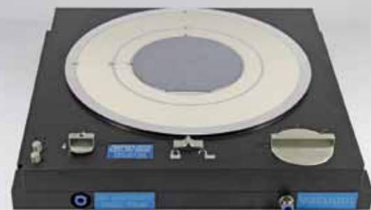
µ-poröse Vakuum-Spannplatte für die Halbleiterproduktion mit drei gesteuerten Spannbereichen, Anschlägen für die Werkstückpositionierung und Liftingpins zur Waferentnahme.
