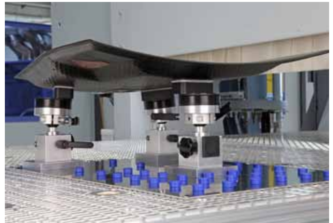
Manuelles 3D-Spannen: Vakuum-Aufspannsystem ›Basic Holding Fixture‹ mit einstellbarer Saugeraufnahme ›Uni-Base‹.
