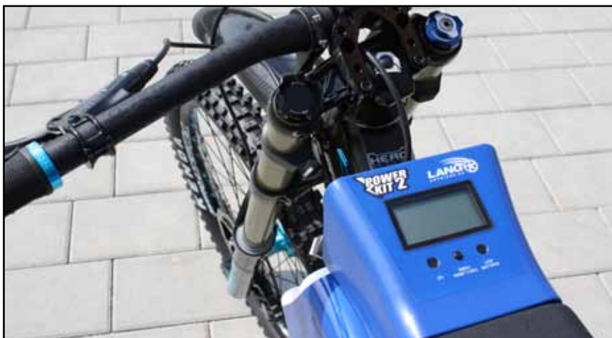
Robust und zweckmäßig präsentiert sich das Power-Kit dem Fahrer. Eine Leistungsanzeige gibt Auskunft, wann es Zeit ist, den Akku zu wechseln beziehungsweise zu laden.
