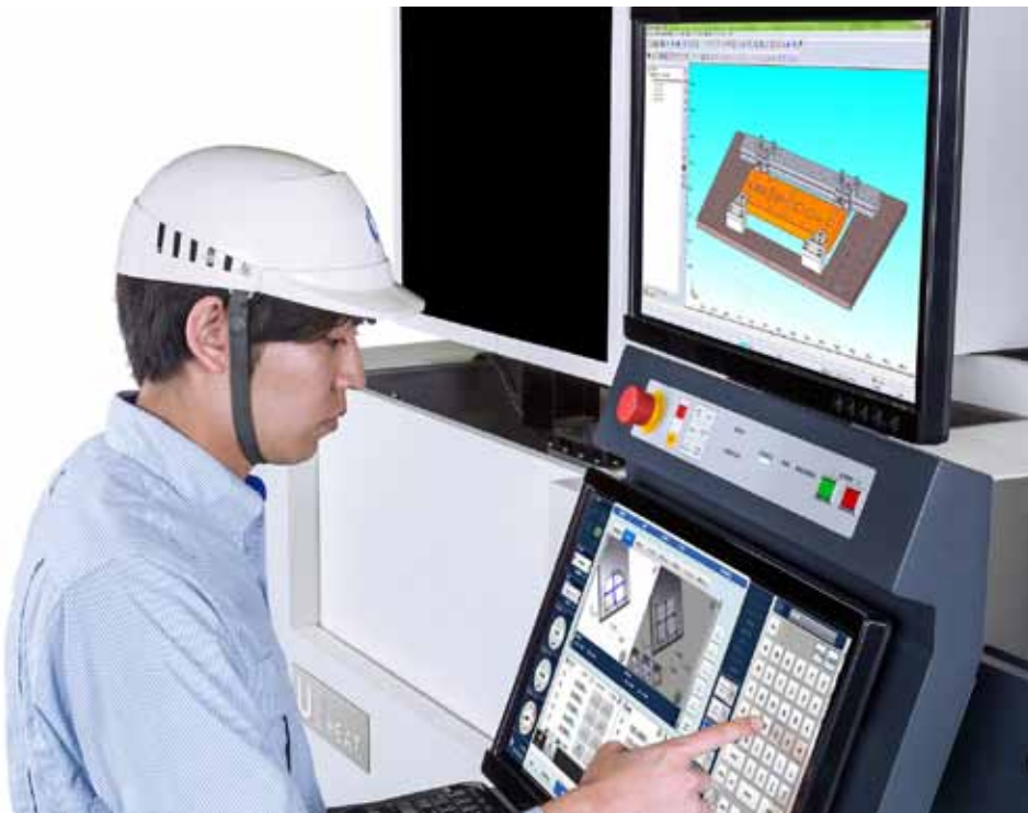
Die neue Touchscreen-Steuerung ›Hyper i Control‹, hier mit optionalem zweiten Monitor dargestellt, wird mit denselben intuitiven Gesten bedient, wie ein Smartphone oder ein Tablet.
