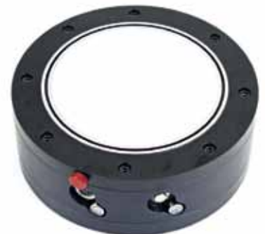
Autarkes Vakuum-Spannfutter. Akkus, Vakuumpumpe, Anzeigen, Überwachungsgeräte und Ventile sind integriert.
