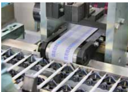
Eine raffinierte Auswerteelektronik erkennt, ob die produzierten Kugelschreiberminen sicher funktionieren.
