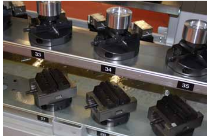
Die Beschickung aus dem Magazin erfolgt frei nach Programm und damit „chaotisch“.
