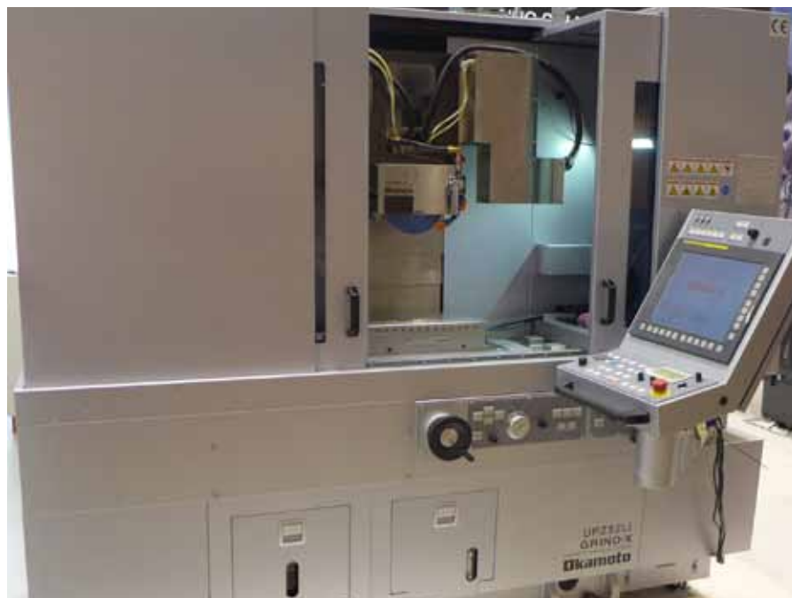
Die Profilschleifmaschine ›UPZ 52 Li‹ ist ein leistungsfähiges Anlagenkonzept für hochgenaue Profilschleifaufgaben etwa im Werkzeug- oder Formenbau.
