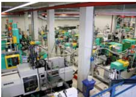
Die modernen Spritzgussmaschinen werden vollautomatisch mit Kunststoffgranulat versorgt.
