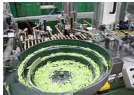
Egal ob Kugelschreiber, Filzschreiber oder Textmarker – alle Schreibgeräte werden vollautomatisch montiert.
