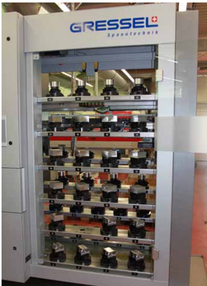
Der Werkstückspeicher »P60« ist mit 56 Werkstück-Spannsystemen vom Typ Zentrischspanner C1 und C2 von Gressel bestückt.
