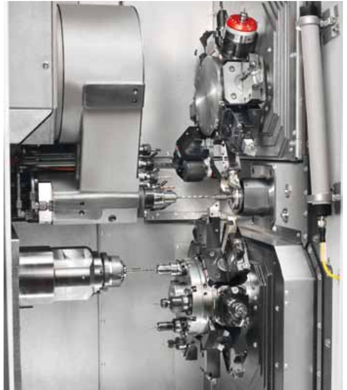
Das Modell ›TNL20-9‹ erlaubt es, mit bis zu drei Werkzeugen zeitgleich und präzise zu fertigen.
