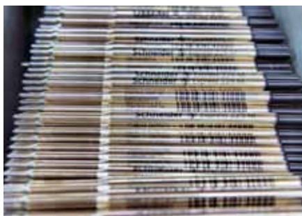
Je nach Modell erfolgt die Kennzeichnung der Kugelschreiberminen per Siebdruck oder via Folie.
