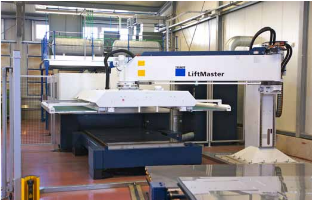
Die automatische Laserschneidmaschine benötigt neben technisch ölfreier Druckluft auch hochreinen Stickstoff der Klasse 5.0 mit einem Druck von 30 bar.
