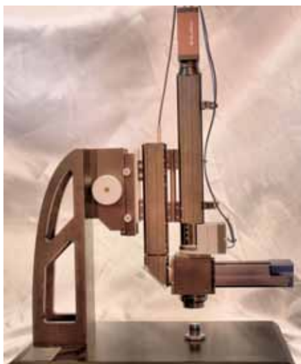
Bei dem smartWLI-Sensor mit großem Arbeitsabstand von vier Zentimeter ist der Aufbau des Interferometers mit Referenzstrahlengang, Lichteinkopplung und Kamera klar erkenntlich.
