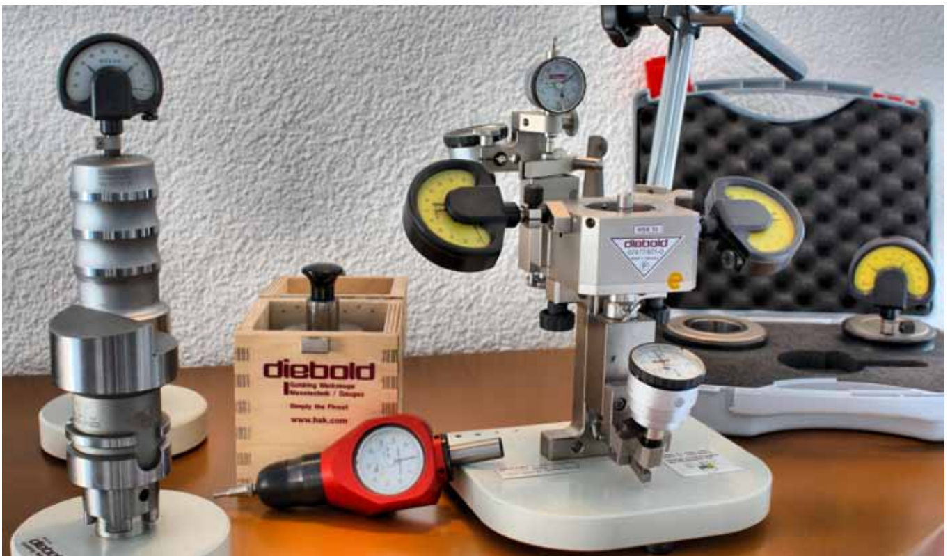
Das Unternehmen Diebold produziert eine ganze Reihe von Messmitteln für den Praxisalltag. Darunter ist auch ein Messgerät, mit dem das Prüfen von Kegeln zum Kinderspiel wird.
