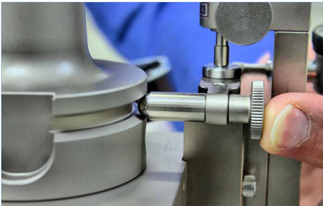
Die korrekte Fertigung der Greiferrille lässt sich ermitteln, indem ein Hebel in Position gebracht wird. Eine Messuhr zeigt unmittelbar die Einhaltung der Toleranz an. So kann bei Bedarf eine Korrektur der jeweiligen Produktionsmaschine vorgenommen werden.
