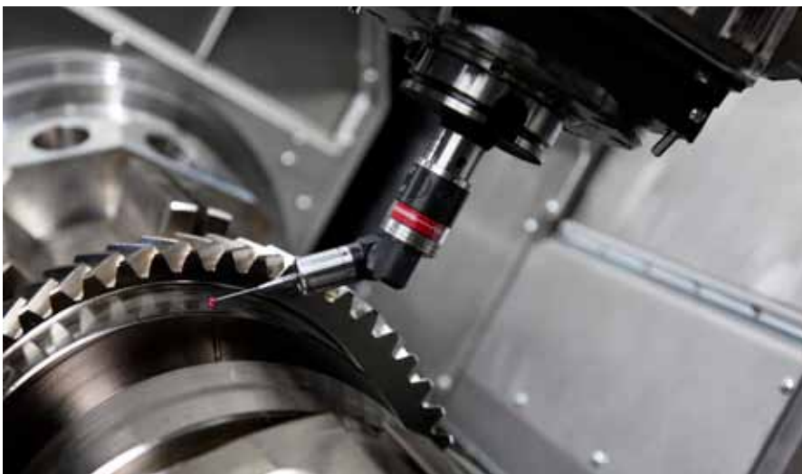
Dank des umfangreichen Zubehörs kann der Messtaster ›TC63-Digilog‹ von Blum einfach an verschiedenste Messsituationen angepasst werden.
