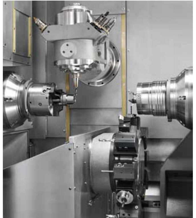
Der Werkzeugrevolver ist mit 18 oder 12 Stationen verfügbar und besitzt eine Y-Achse mit einem Verfahrbereich von \pm 50 mm.
