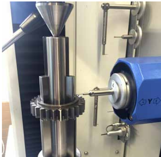
Vermessung des auf dem HDDS von Ringsspann aufgespannten und fertig geschliffenen Stirnrads.
