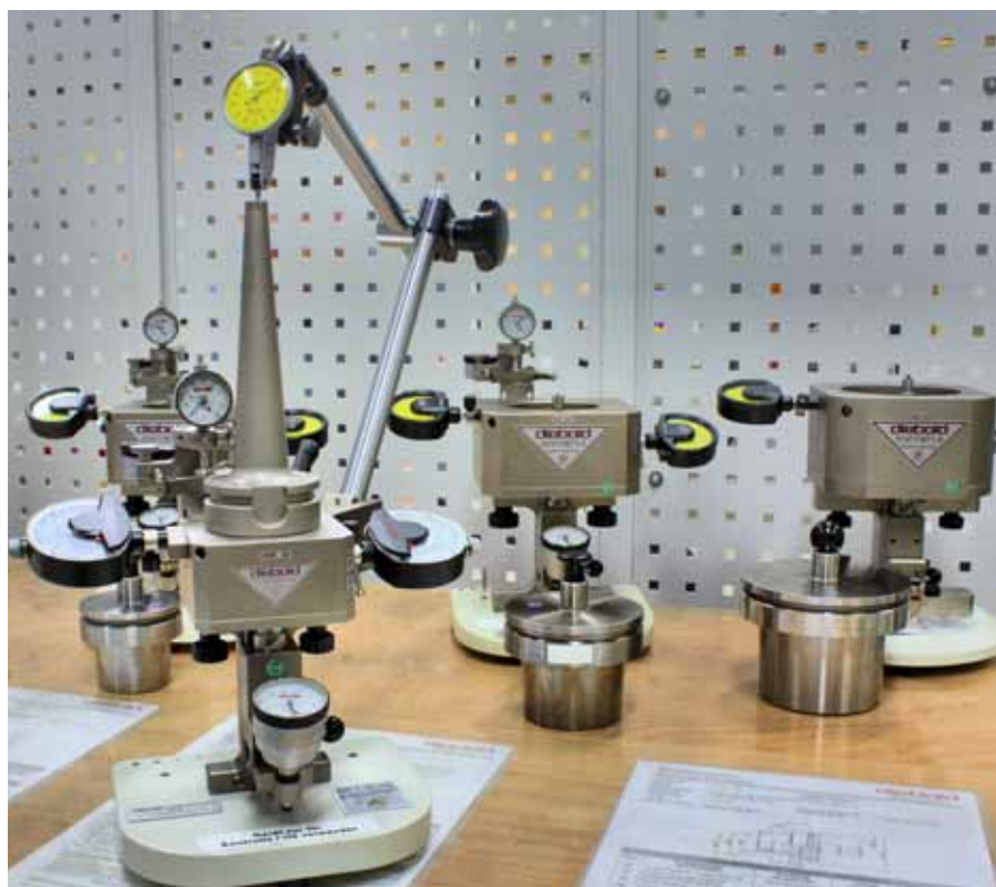
Egal ob SK-, HSK- oder BT-Kegel – mit dem Kegelmessgerät von Diebold können Kegel für Präzisionswerkzeugaufnahmen mühelos geprüft werden.
