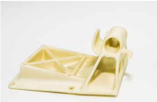
Perfekt für den Guss: Die 3D-gedruckten PMMA-Modelle wurden mit Wachs infiltriert.
