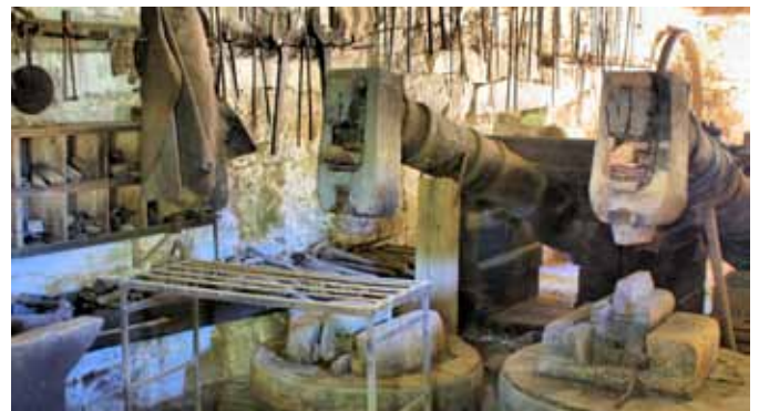
Bis zu 200 Kilogramm wiegen die Hämmer in der mit Wasserkraft angetriebenen Hammermühle. Damit konnte ein Schmied Kraft sparen und mehr Teile in kürzerer Zeit herstellen.
