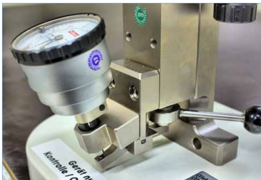
Die Einhaltung der Auswerttiefe kann durch Aktivieren eines Hebels und Ablesen einer Messuhr überprüft werden.
