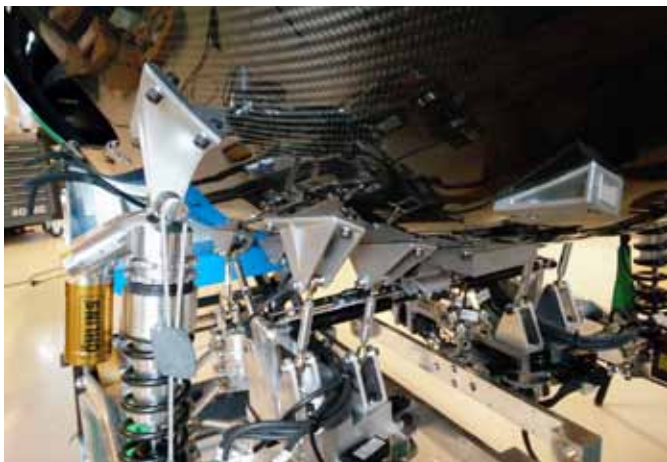
Die gegossenen Aluminiumteile konnten problemlos an der Hyperloop-Kapsel montiert werden.
