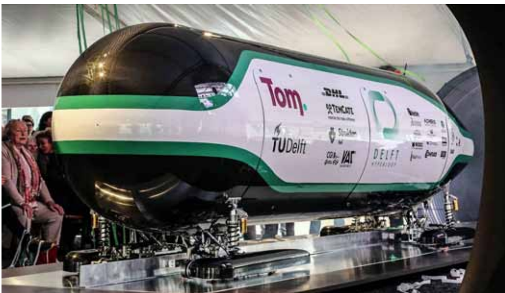
Wie ein Wassertropfen geformt: Die Delfter Hyperloop-Kapsel erhielt eine aerodynamische Form und ähnelt einem Wassertropfen – die optimale Form für einen geringen Luftwiderstand.
