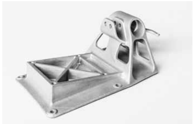
Die gegossenen Modelle sind nach einer Wärmebehandlung fertig zum Einbau in die Hyperloop-Kapsel.
