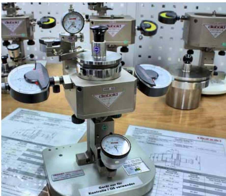
Das Kegelmessgerät von Diebold wird mittels eines Einstellorns geeicht. Dazu werden alle Messuhren nach dem Einstecken des Messdorns einfach auf Null gestellt.
