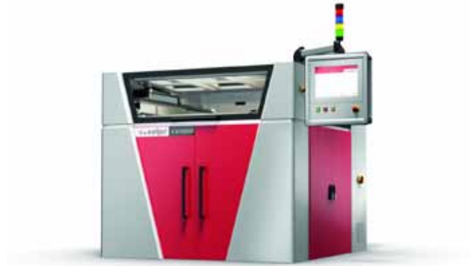
Die PMMA-Modelle für den Guss wurden auf einer ›VX1000‹ im Voxeljet-Dienstleistungszentrum in Friedberg gedruckt.
