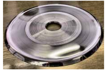
Eine fehlerfrei produzierte Masterplatte ist Voraussetzung für eine reibungslose Produktion von Schallplatten. Die Platte wird vernickelt, damit sie schadlos viele tausend Pressvorgänge übersteht.
