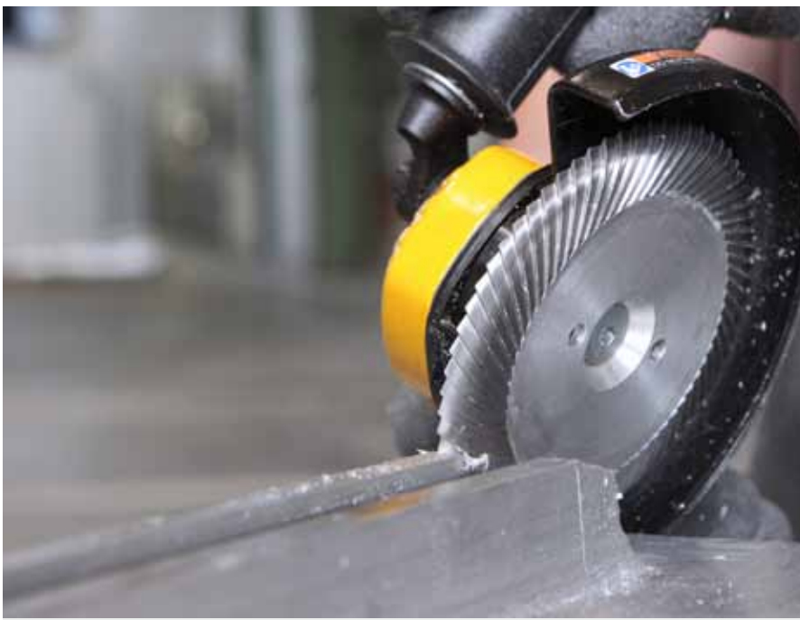
Der 116-mm-Fräsring der Maija-Frästechnik GmbH besteht aus gesintertem Wolframkarbid und wird auf einem Turbinenschleifer GTG 21 von Atlas Copco Tools eingesetzt.
