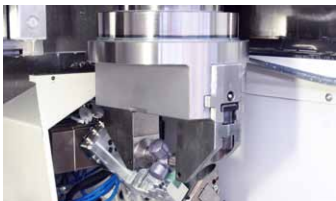
Wendestation beim Schwenken des T-Stücks um 90 Grad. Das Zweibackenfutter ist im Bild geöffnet.
