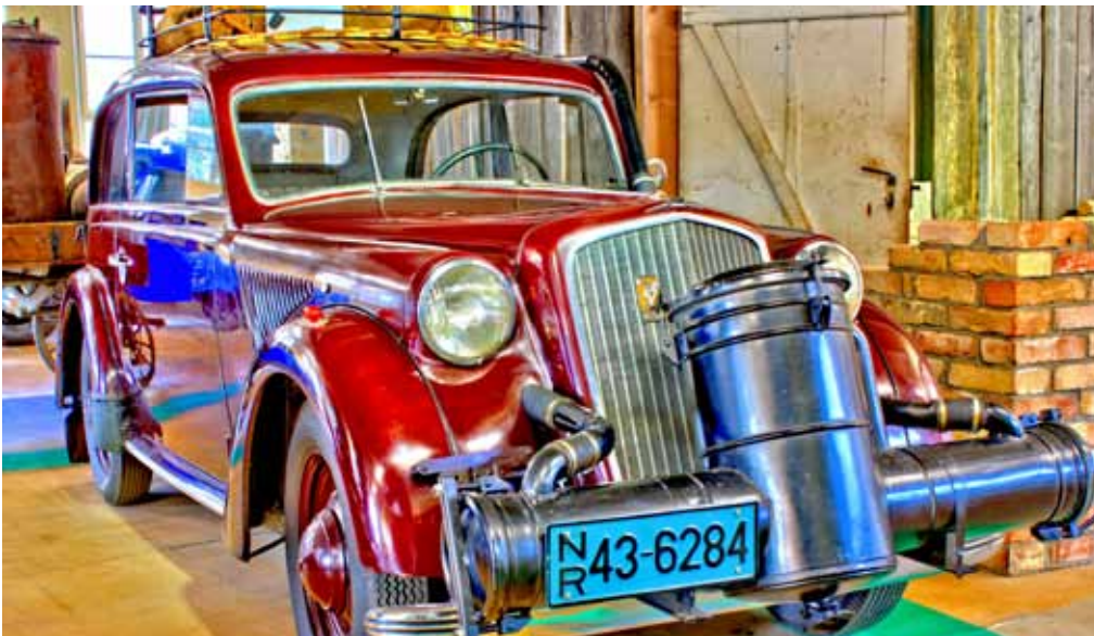
Ein Opel Olympia mit nachträglich angebaute Holzgasanlage sorgte im Jahre 1946 trotz knappem Benzinangebot für Mobilität. Der Olympia war technisch eine Pioniertat, denn er hatte die erste selbsttragende Ganzstahlkarosserie der Welt.
