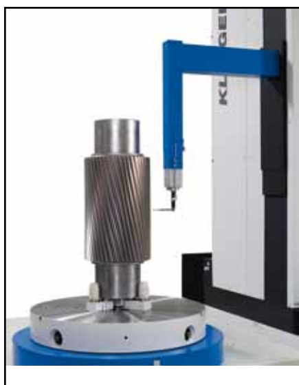
Nicht nur Sonnenräder werden mit der P 150 W extrem präzise vermessen.
