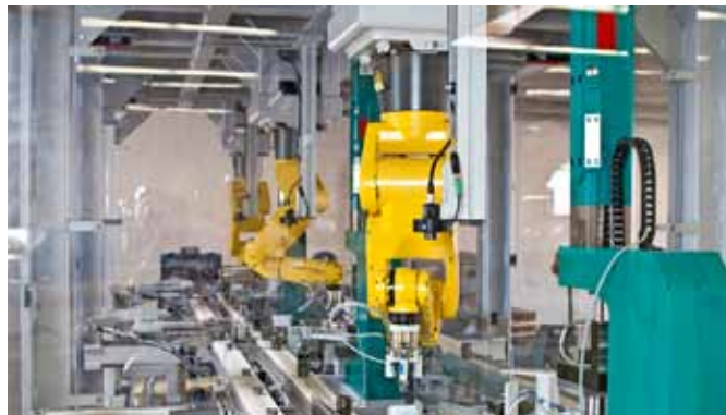
Pressenstation, in die eine C-Gestell-Tischpresse ›CMB‹ und ein Tox Electric Power Modul ›EPMS 055‹ sowie ein Presskraftsensor ›ZPS‹ integriert sind.
