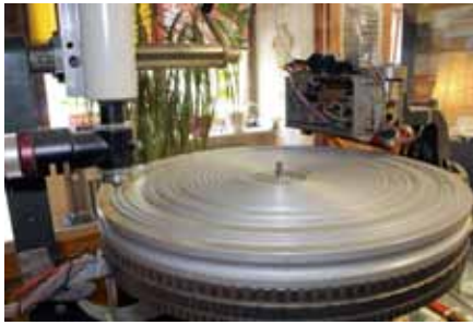
Wer Schallplatten produziert, benötigt hochwertige Technik, wie Schallplatten-Schneidapparate von Neumann. Seine präzise Mechanik erlaubt es, Masterplatten für Kopiermaschinen herzustellen.
