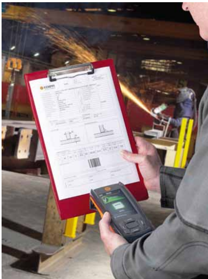
›ArcQuality‹ von Kemppi ist ein System zur einfachen Überwachung der Spezifikations-Erfüllung von Schweißverfahren.
