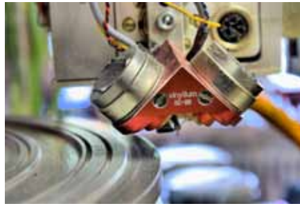
Der Stichel im Schneidkopf des Schneidapparats wird von zwei Magneten bewegt, die, je nach Tonsignal, den Stichel nach links oder rechts auslenken, was die Form der Schallplattenrinne bestimmt.
