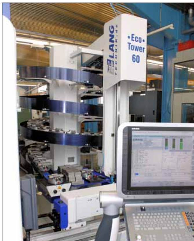
Mit bis zu 60 Spannvorrichtungen bietet der Eco-Tower von Lang genug Kapazität für stundenlanges, autonomes Fertigen.
