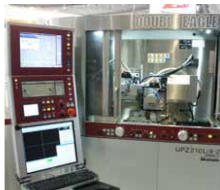
Für hochgenaue Profilschleifaufgaben: Ultra-Präzisions-Mikro-Profil schleifmaschine UPZ 210 Li II von Okamoto.
