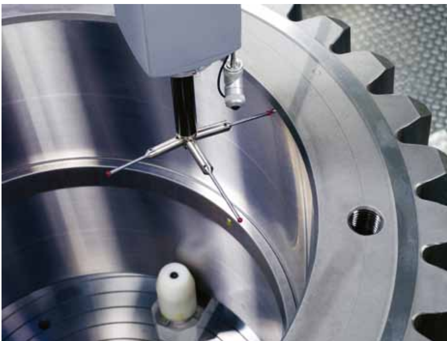
Die Lagerung der P 150 W hat eine Rundlaufgenauigkeit, die unter 0,5 Mikrometer liegt. Eine ideale Voraussetzung für Formmessungen an rotationssymmetrischen Bauteilen.
