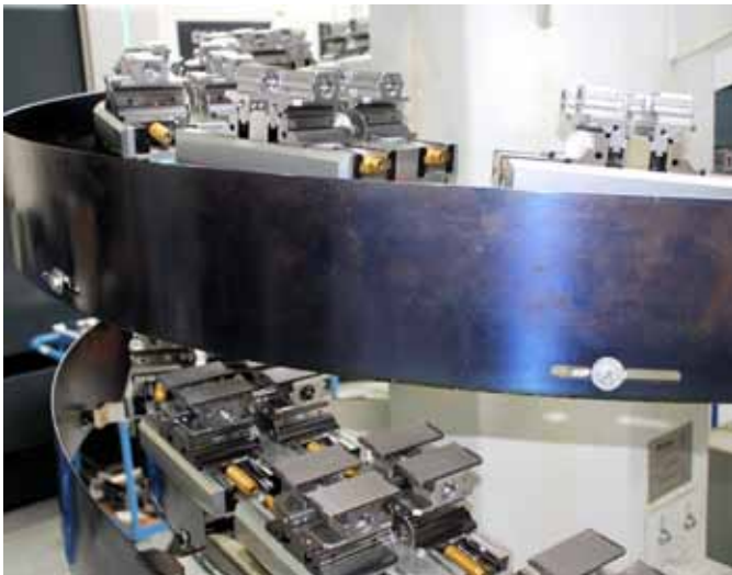
Spannkörper von Lang nehmen bis zu vier Bauteile auf einmal auf. Damit die Spannsysteme nicht zu schnell nach unten fahren, werden diese durch eingebaute Bremsen verlangsamt.
