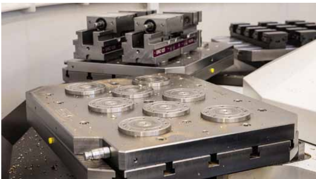
Rüstplätze außerhalb der Maschinen erhöhen die Auslastung der Maschinen bei Kocher-Plastik erheblich.
