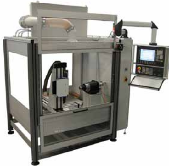
Das Unitest-MQL führt Sprühtests durch und prüft die sichere Durchleitung des MMS-Mediums zur Schneide.
