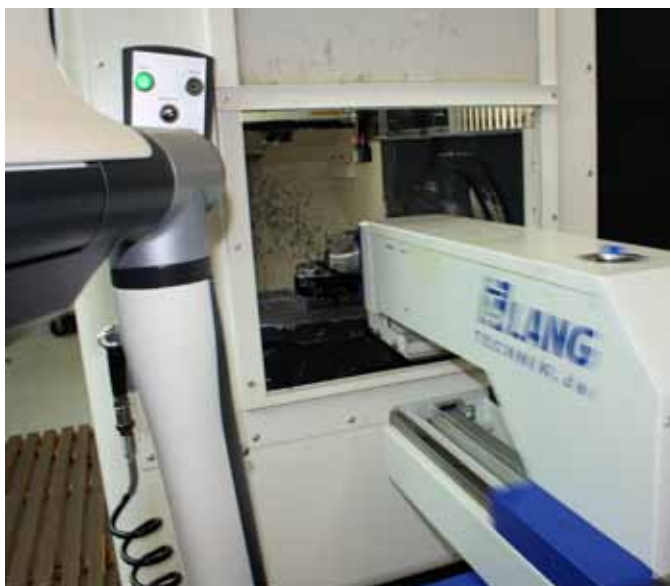
Das robuste Handlingsystem für den Lang-Eco-Tower kommt ohne Schutzzaun aus.
