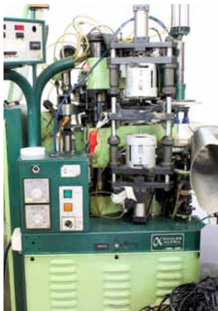
Bereits über 34 Jahre hat die Toolex Alpha auf dem Blechkleid. Dennoch werden mit ihr bei My45 immer noch mehr hundert Single-Platten pro Tag gepresst.
