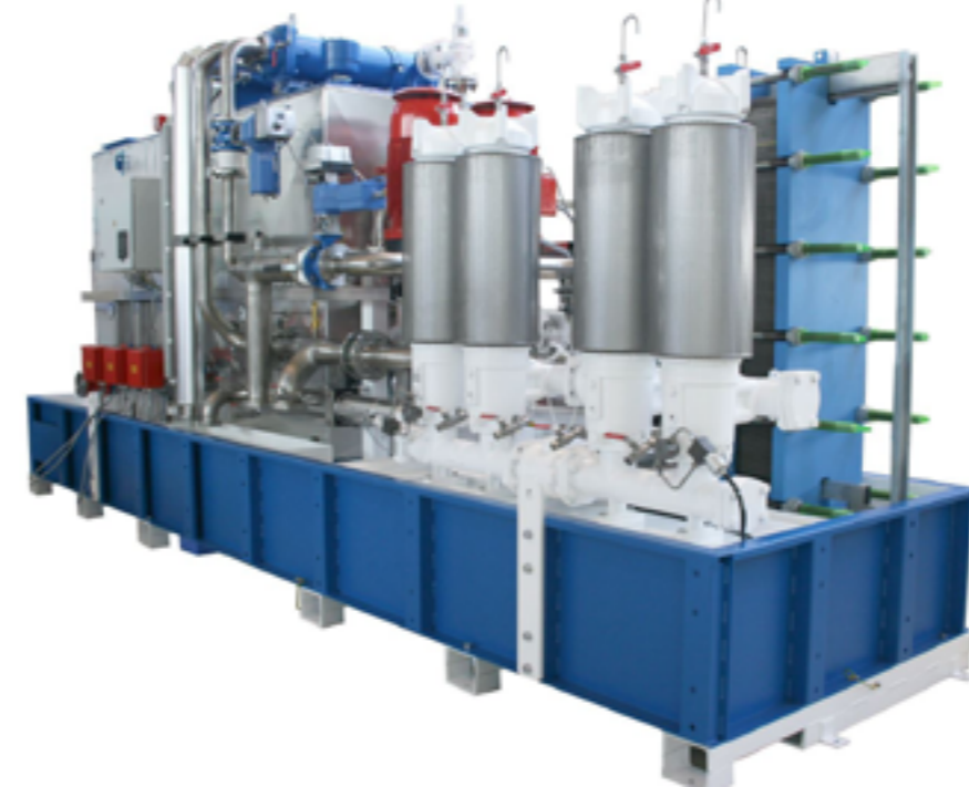
Das auf extreme Betriebstemperaturen ausgelegte Schmiersystem für den Prüfling verursacht darin genau diejenigen „Schmierungs-Fehler“, aus deren Analyse sich die SKF Experten wertvolle Hinweise zur Optimierung künftiger Großlager-Generationen erhoffen.
