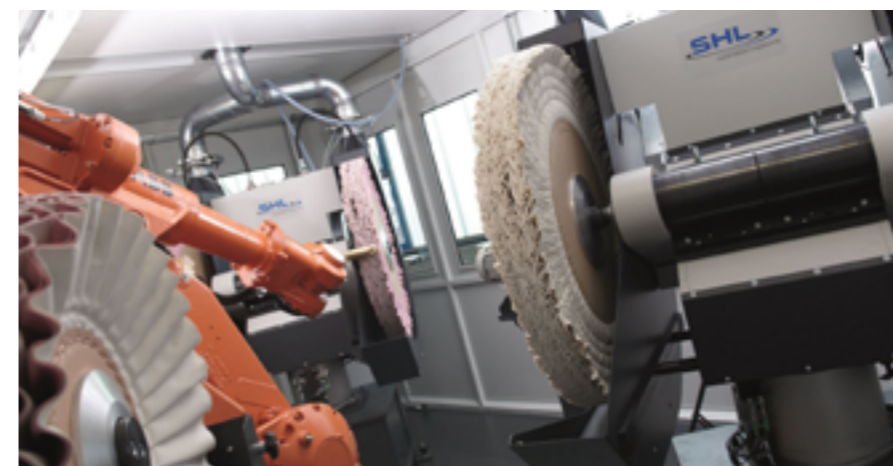
Ohne menschliches Zutun werden die Wasserarmaturen in der SHL-Anlage von Robotern auf Hochglanz poliert.
