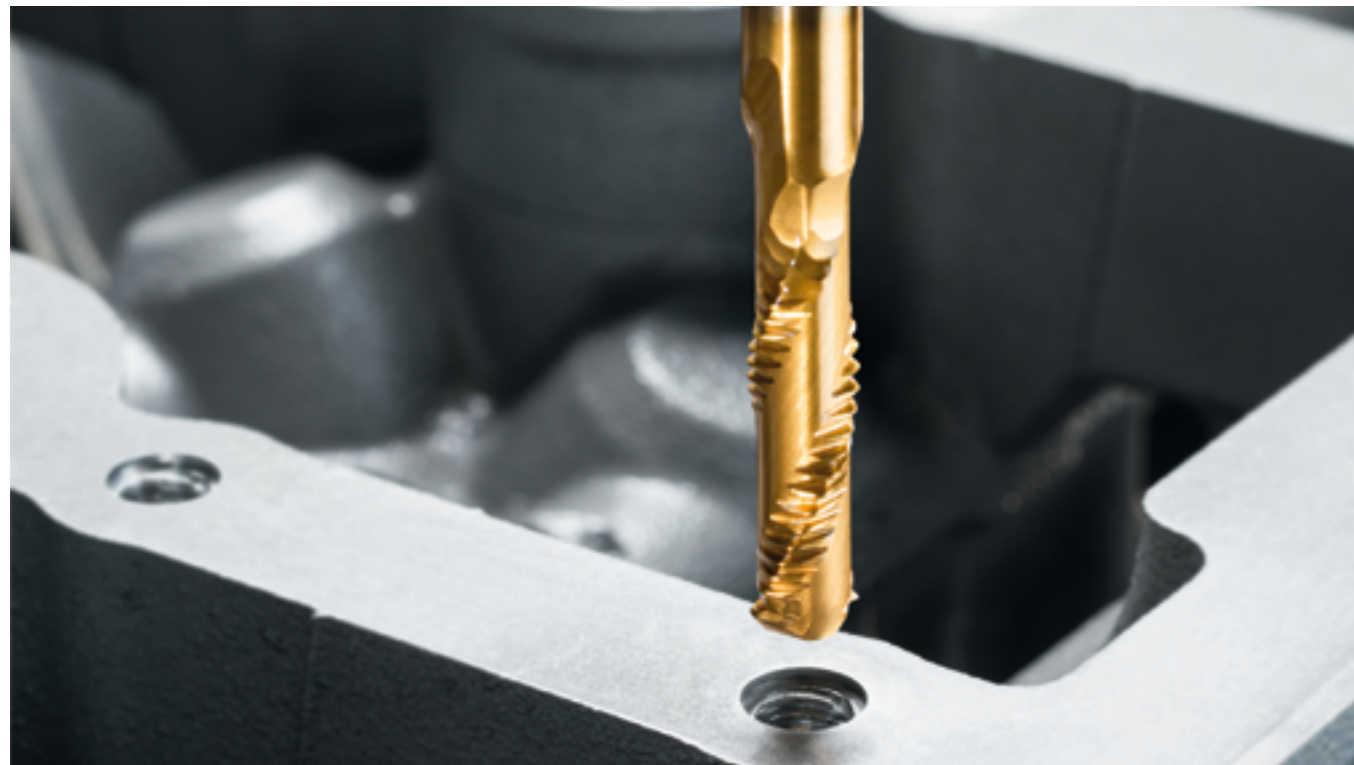
Der PunchTap-Gewindeformer von Emuge besitzt ein innovatives Profil. Das dadurch mögliche, neuartige Verfahren überrascht mit einem im Vergleich zum herkömmlichen Gewindeformen völlig anderen Bewegungsablauf, was satte Zeiteinsparungen ermöglicht.
