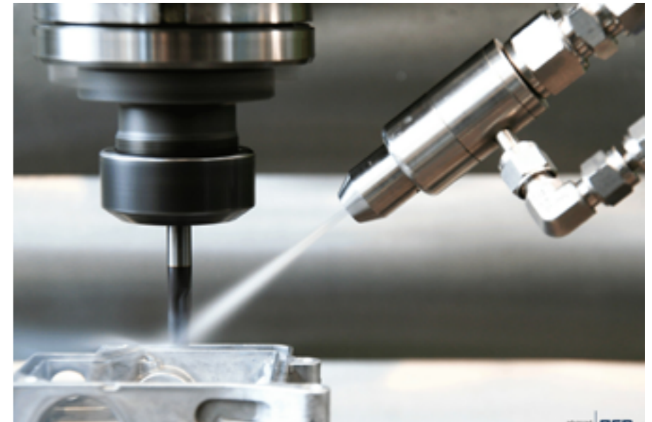
Die Zweistoffringdüsen-Technologie sorgt für einen konstanten Druck, der eine Vereisung der Düse verhindert und eine gleichbleibend gute, externe Kühlung sicherstellt.
