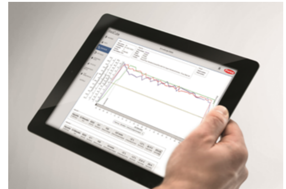
Das Dokumentations- und Datenanalyse-System »Weldcube« visualisiert die in der Stromquelle erfassten Daten und stellt die Ergebnisse per Webbrowser zur Verfügung.
