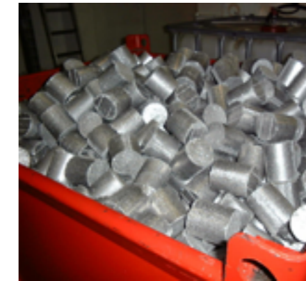
60 mm Durchmesser weisen die Aluminiumbriketts auf, die von der Presse erzeugt werden.
