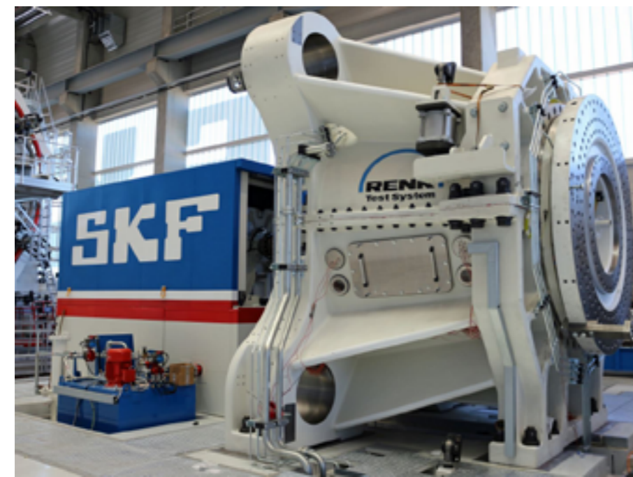
Der neue SKF-Prüfstand für Großlager in Anwendungsbereichen wie dem Schiffbau, dem Bergbau, der Zement- und Stahlbranche oder auch der Papierindustrie entwickelt Kräfte von gut einem halben Dutzend Meganewton und kann dabei Rotationsgeschwindigkeiten von über 200 min -1 erzielen.
