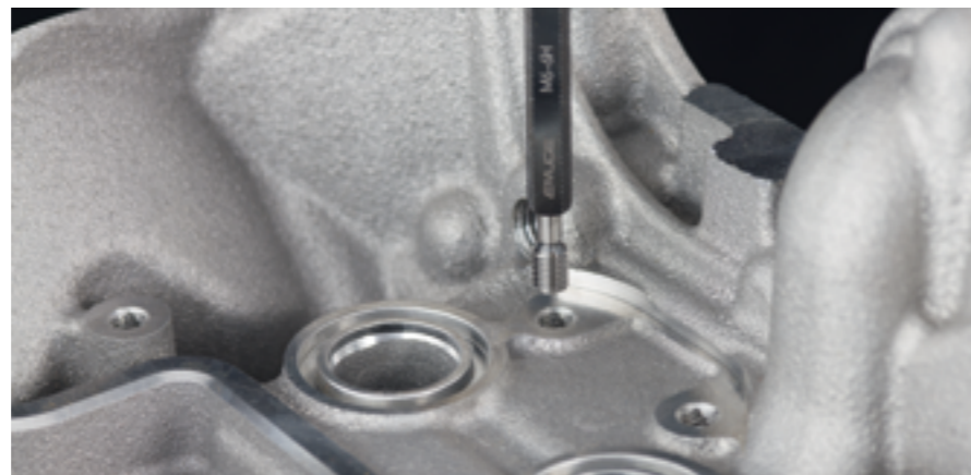
Das mittels PunchTap hergestellte Gewinde bietet eine ähnliche Festigkeit, wie sie klassische Gewindeformer erzeugen. Zudem sind die Gewinde absolut maßhaltig.
