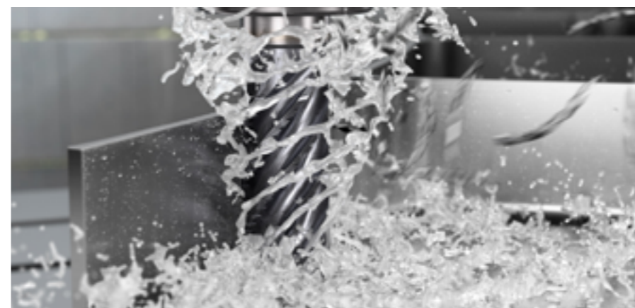
Die Coromill Plura HFS-Schafffräser von Sandvik Coromant eignen sich hervorragend für die Bearbeitung von Flugzeugbauteilen aus Titan- und Nickelbasislegierungen.
