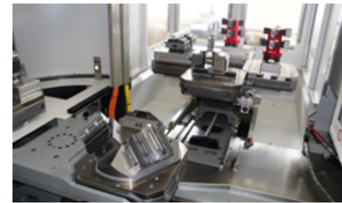
Die mechanische Nullpunkt-Spannsystemplatte ›gredoc NRS‹ montiert auf einer Hermle-Maschinentischpalette.
