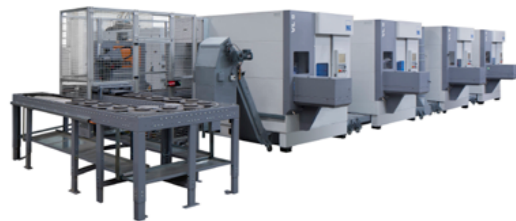
Die Verkettung der Emag-Maschinen erfolgt per ›Trackmotion‹. Es ist möglich, eine Maschine aus dem Prozess „wegzuschalten“, wenn für das Werkstück nicht alle Operationsschritte nötig sind.
