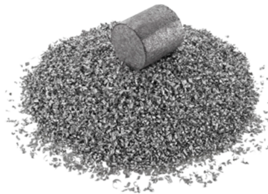
Seit 2001 komprimiert die kompakte Anlage von Ruf bei ZF Gusstechnologie zuverlässig Aluminiumspäne zu Briketts.
