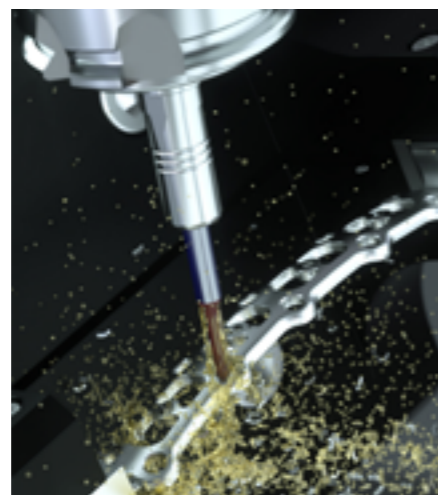
Der massive Kühlmittelstrahl hält die Schneidentemperatur unter Kontrolle.
