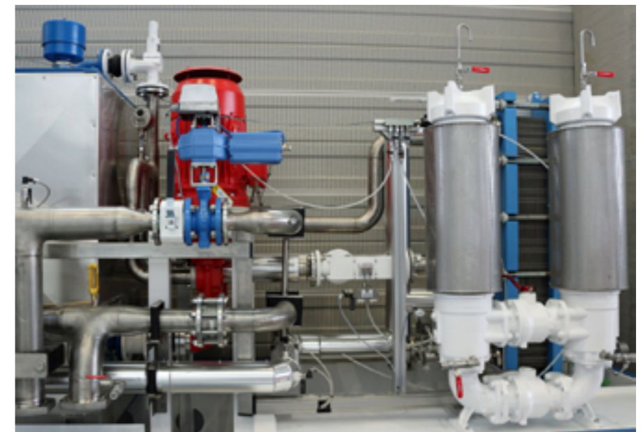
Das Schmieraggregat für den Prüfstand versorgt dessen „steifigkeitsvariable“ Lageranordnung mit der optimalen Schmierung.
