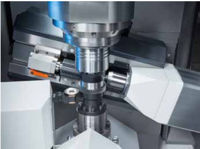
Entwickelt für große Zahnradserien 22 Emags Wälzfräsmaschine ›VLC 200 H‹ ist die ideale Lösung wenn es darum geht, Zahnräder in großer Stückzahl zu produzieren.
