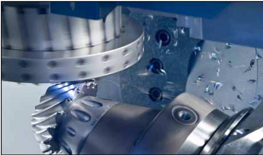
Kegelräder werden durch gleichzeitiges Bewegen von sechs Achsen mit Hilfe von speziellen Messerköpfen hergestellt. Das Programm dazu wird von »KIMoS« erstellt.
