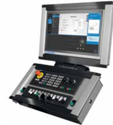
Eine manuelle Programmierung zum Kegelradfräsen ist nicht nötig, da ›KIMoS‹ alle CNC-Programme erzeugt.
