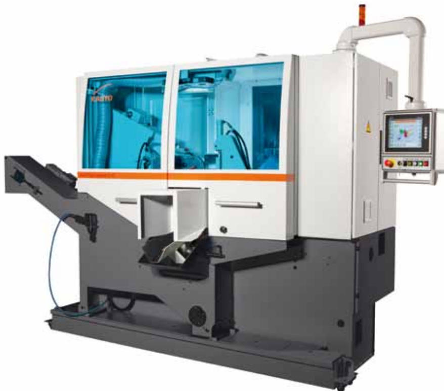
Die Kreissägeautomaten »Kastogripspeed« haben einen Schnittbereich von 15 bis 100 mm Durchmesser und nutzen spezielle Einweg-Hartmetallblätter mit wahlweise 2,5 oder 2 mm Dicke.
