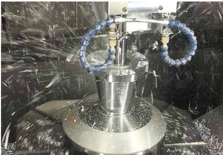
Volumenzerspaltung von Aluminium mit ATS und Einschraubfräser mit rhombischen Wendeschneidplatten von Franken.
