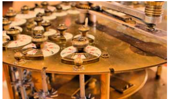
Mit seinen Rechenmaschinen hat sich Philipp Matthäus Hahn das Berechnen seiner Uhrwerke und Planetarien sehr erleichtert. Die Maschinen konnten sogar den Zehnerübertrag auszuführen.
