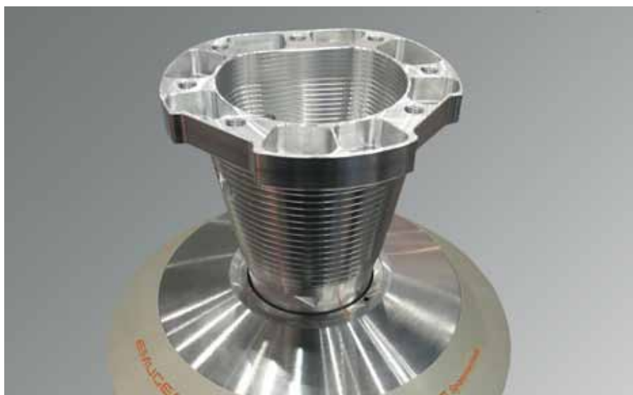
Das fertige Getriebegehäuse. Eine optimale KSS-Strategie ist wichtige Voraussetzung, um anspruchsvolle Materialien produktiv und somit wirtschaftlich zu zerspanen.
