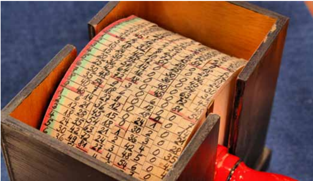
Erste Erleichterung beim Rechnen verschaffte sich der Pfarrer und Erfinder Philipp Matthäus Hahn mit den sogenannten Napierschen Rechenstäben. Nach deren Prinzip ersann er eine Rechentrommel, mit der das Rechnen noch schneller vonstattenging.
