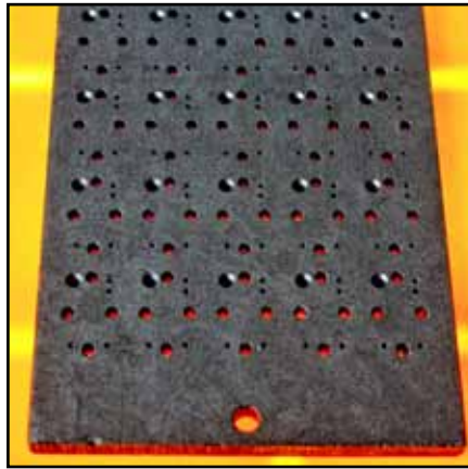
Beleuchtete Metapor-Platten erlauben es, Teile nach der Fertigung sofort per Optik zu vermessen.
