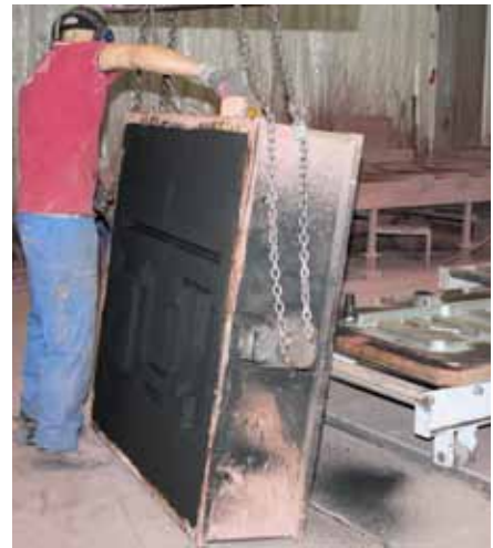
Nach dem Aushärten des Sandes werden die Gussformen entfernt. In die Hohlräume fließt später das Gusseisen.
