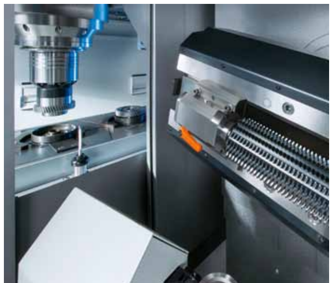
Das Be- und Entladen der Maschine erfolgt Emag-typisch über die Pick-up-Arbeitsspindel.
