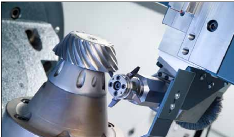
Auch für das Entgraten der Zähne hat »KIMoS« eine Rechenroutine parat. So wird es zum Kinderspiel, ein Entgratwerkzeug an den Zähnen entlangzuführen.
