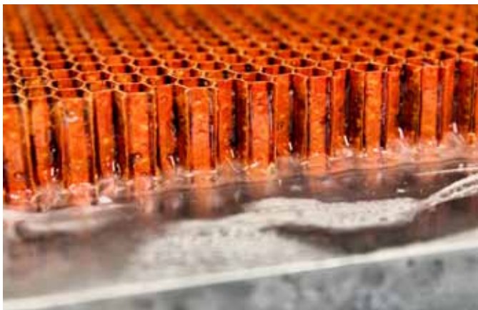
Das gefrorene Wasser umschließt lückenlos das Bauteil, wodurch es mit hoher Festigkeit auf der Alu-Platte fixiert ist.
