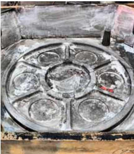
Mit Trennmittel eingepinselte Gussformen aus Holz bilden die Grundlage für das spätere Gussteil.
