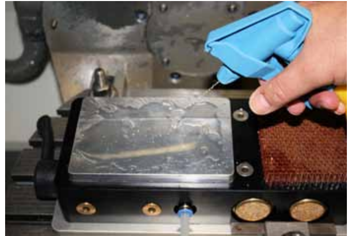
Als „Spannmittel“ eignet sich normales Wasser, dem Spülmittel zum Entfernen der Oberflächenspannung zugegeben wird.
