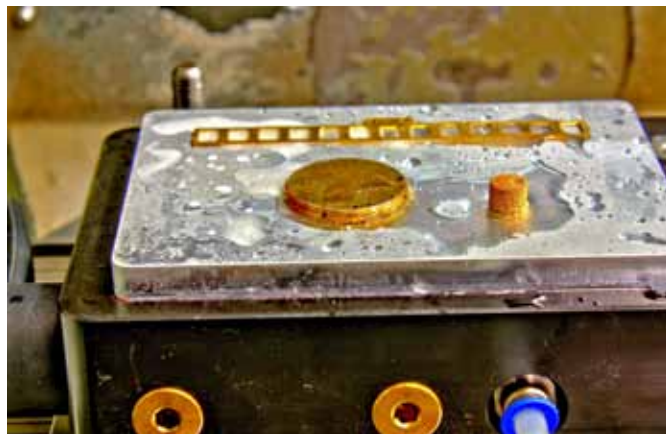
Egal, ob porös, gelocht oder perforiert, in jedem Fall werden Teile optimal gehalten, wodurch deren Bearbeitung möglich wird.
