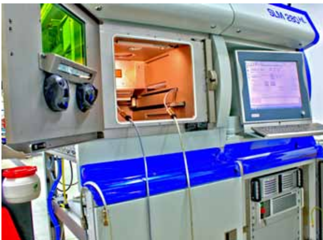
Das Modell »SLM 280 HL« besitzt einen beachtlichen Bauraum von 280 x 280 x 350 Millimeter. In diesem Modell wird die Doppelstrahltechnik eingesetzt, was die Bauzeiten kräftig senkt.
