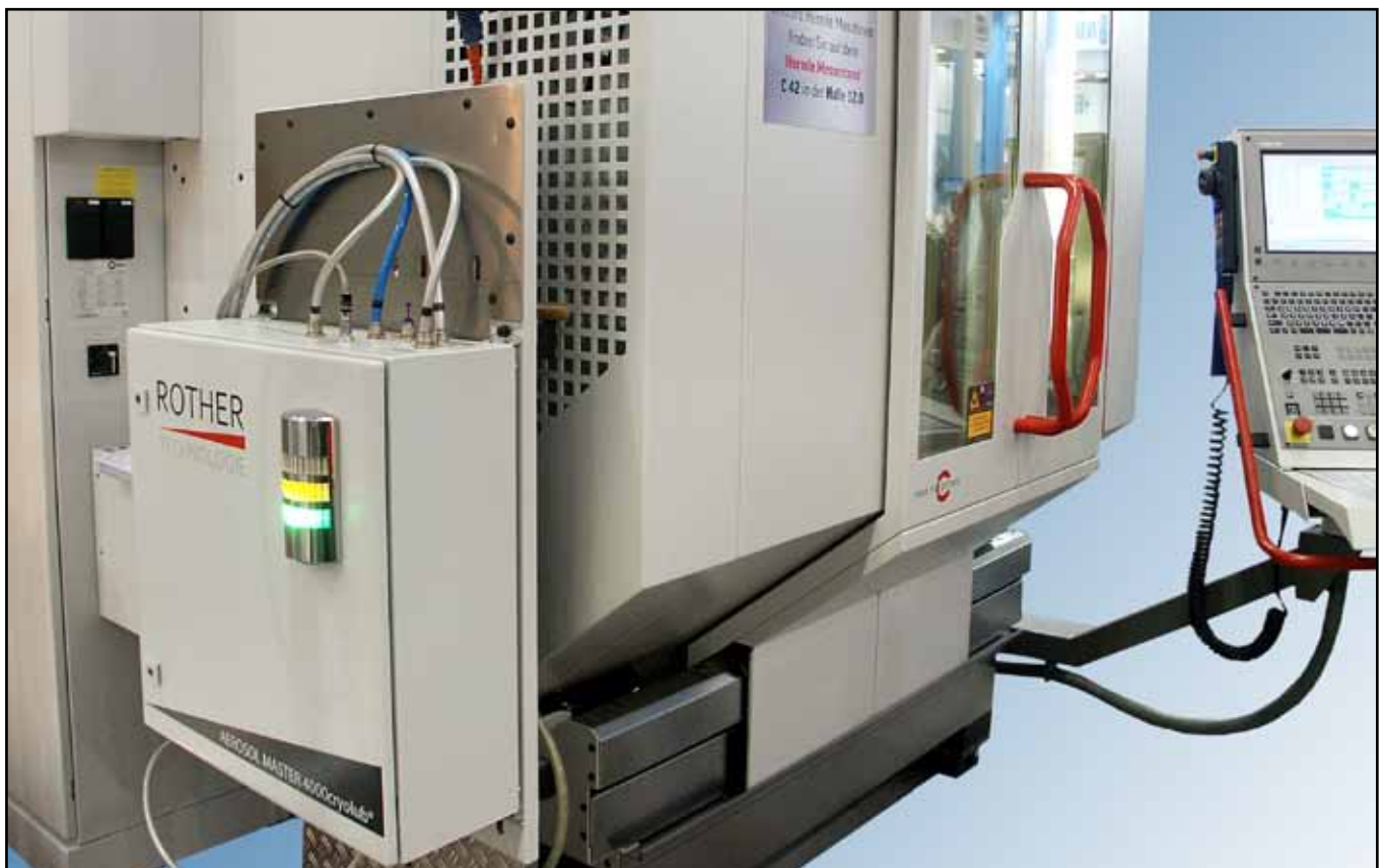
›ATS‹ von Rother lässt sich mit geringem Adaptionaufwand und ohne nennenswerte Störung der Produktion in Bearbeitungszentren, Transferstraßen sowie Dreh-, Fräs- und Bohrmaschinen schnell integrieren.
