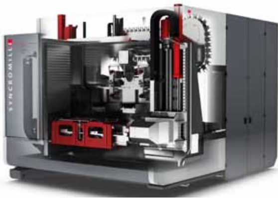
Die ›syncromill c‹ von Fill ist der Spezialist für die platzsparende und wirtschaftliche Fertigung komplexer Bauteile.
