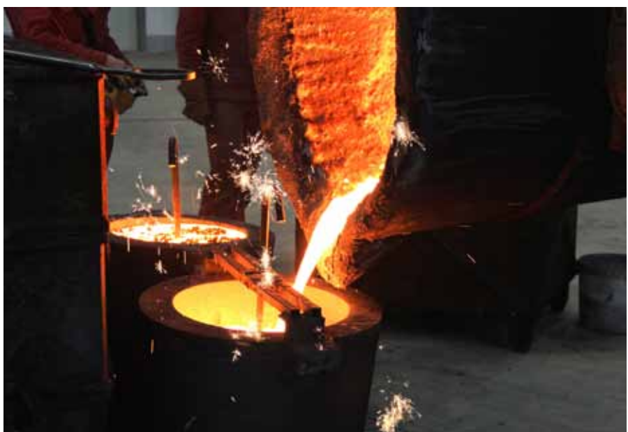
Stahl- und Gusschrott bildet die Basis für die Schmelze, aus der neue Maschinenteile hergestellt werden. Bei Erreichen der Schmelztemperatur fließt das geschmolzene Material in die Gießbehälter, die wiederum die Gussformen speisen.
