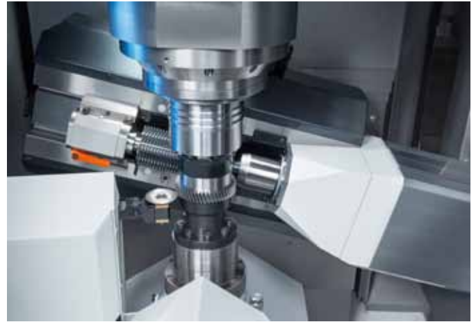
Die ›VLC 200 H‹ ist für radförmige Werkstücke mit einem Durchmesser bis 200 mm und Modul 4 ausgelegt.
