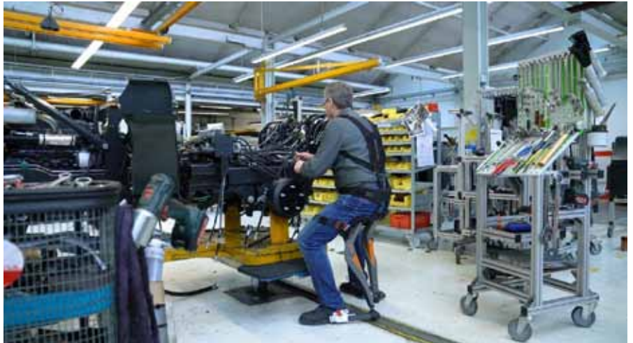
Durch die Möglichkeit, jederzeit sitzen zu können, verringert der Chairless Chair die körperliche Belastung bei stehenden Tätigkeiten signifikant.
