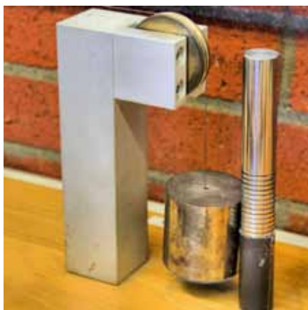
Formgedächtnismetalle können mühelos auch schwere Lasten heben, da bei Erwärmung schon kleinste Materialquerschnitte beträchtliche Zugkräfte entfalten.
