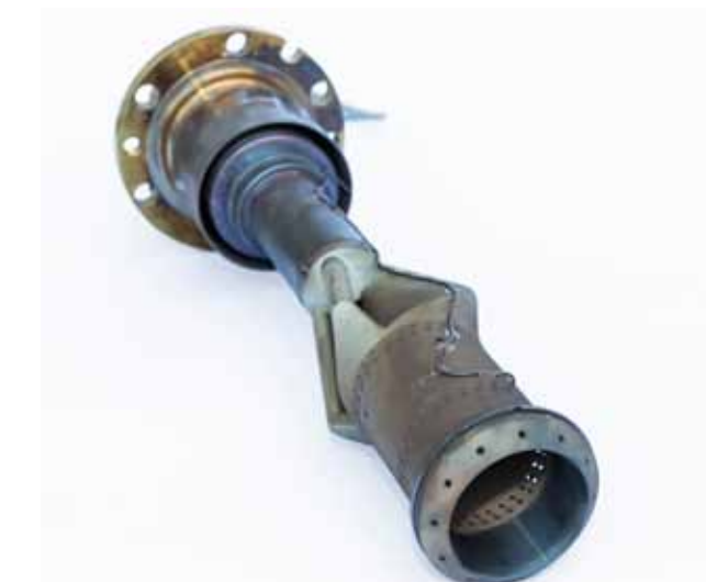
Der per additiver Fertigung hergestellte Gasbrenner ist für das E.ON-GuD-Kraftwerk Philippsthal produziert worden.
