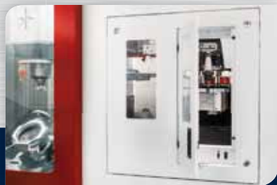
65-fach Werkzeugmagazin, von vorne bedienbar
