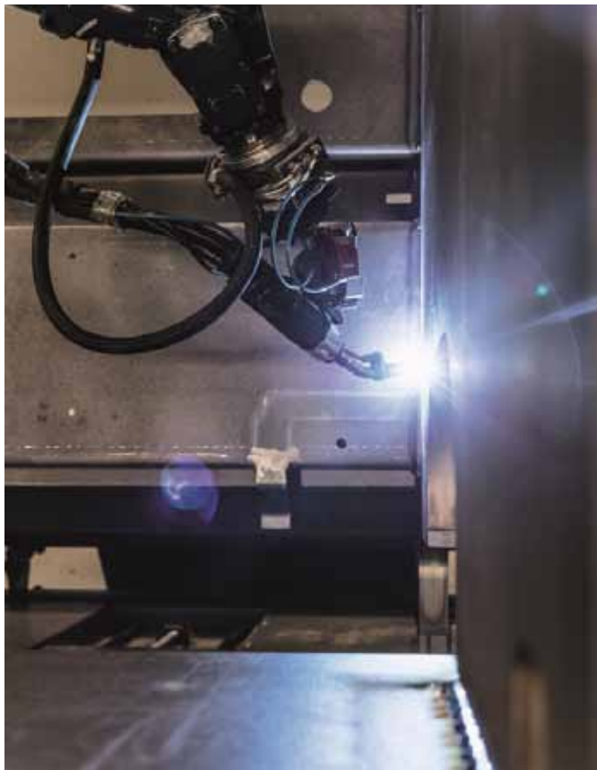
Das Laserhybrid-Schweißen ist ein kombinierter Prozess aus dem Laserschweißen und dem Metall-Schutzgas-Schweißen (MSG).
