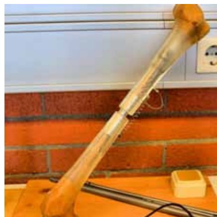
Auch in der Medizintechnik werden Formgedächtnismetalle eingesetzt. Beispielsweise können damit Knochen verlängert werden.
