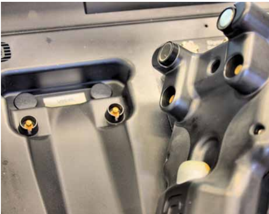
Der Akku des kabellosen Handrads lässt sich ähnlich einfach wie ein Handy laden: einfach in die vorgesehene Mulde legen.
