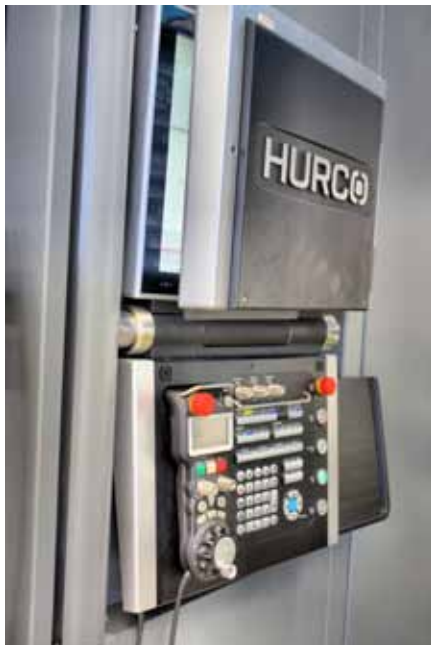
Bei Nichtbenutzung lässt sich die Max-5 Bedienkonsole sehr platzsparend an die Maschine schmiegen.
