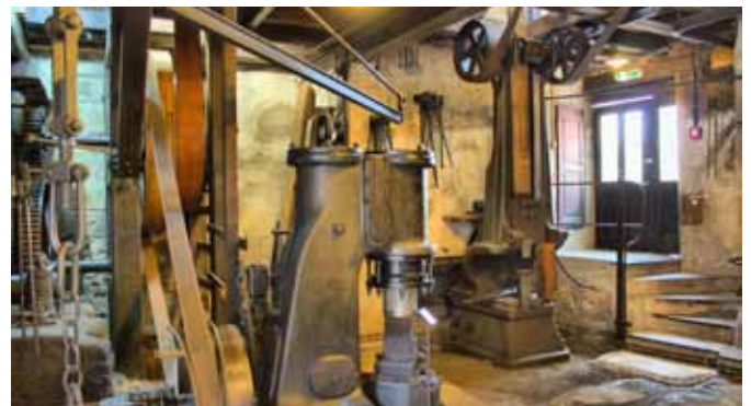
Die Ausstattung des Eisenhammerwerks stammt vorwiegend aus der Zeit zwischen 1895 und 1955. Hier wurde ausschließlich mit Wasserkraft geschmiedet.
