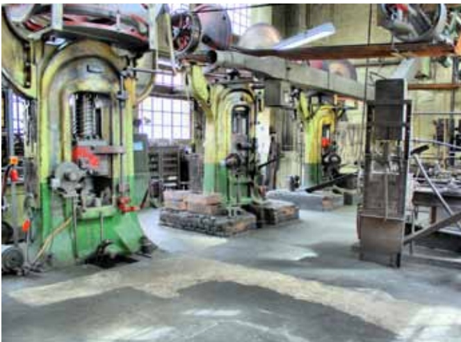
Gewaltige Spindelpressen waren nötig, um aus einem vorgeformten Werkstück einen Ventilrohling zu pressen, der anschließend noch nachbearbeitet wurde.
