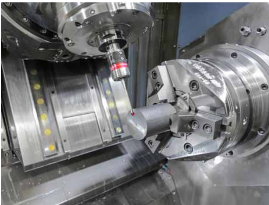
Der Blum-Messtaster ›TC62‹ mit BRC-Funktechnologie misst, ob das Bauteil korrekt gespannt wurde und kontrolliert die Rohling-Abmaße.
