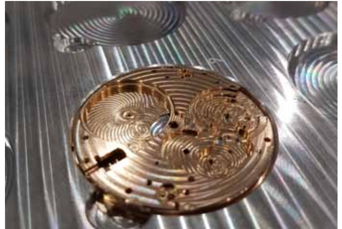
Hochpräzise Kleinstteile wie diese Platine sorgen dafür, dass die Uhren von NH Watches lebenslang „richtig ticken“.
