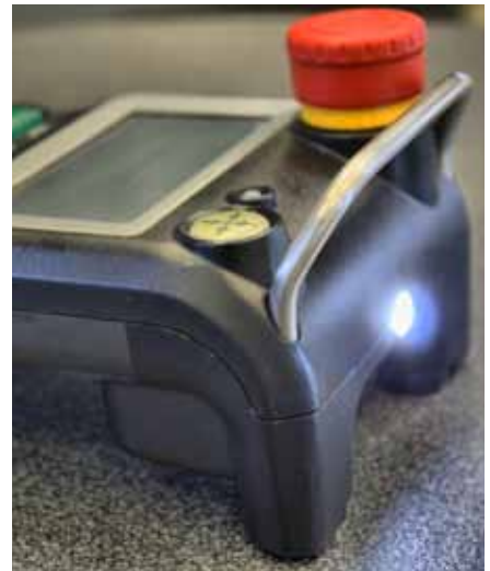
Sogar eine kräftige Lampe ist am Handrad eingebaut, was das Einrichten der Maschine an dunklen Stellen sehr erleichtert.
