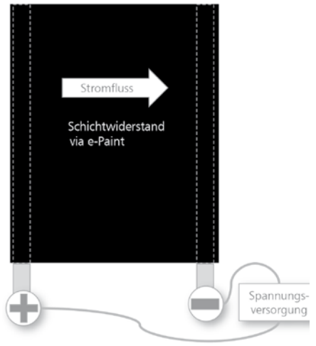
Durch den Stromfluss von Cu-Band zu Cu-Band erwärmt sich die e-Paint-Farbe.
