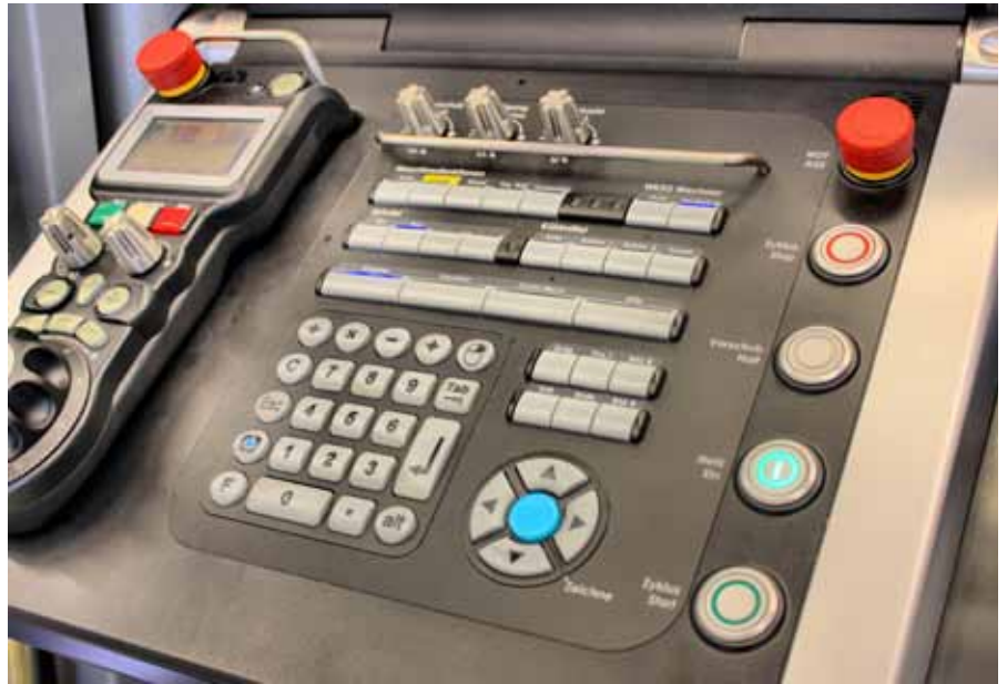
Die lösemittelfeste Tastatur besteht aus ABS Polycarbonat. Wenige Tasten genügen, um via Dialog-Programmierung CNC-Programme zu erstellen.
