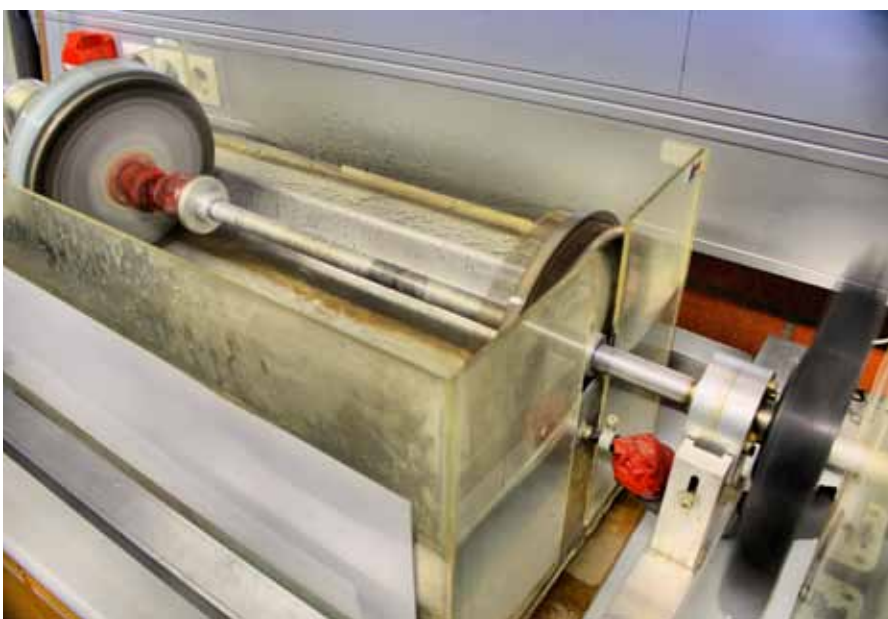
Beim Kontakt mit heißem Wasser ziehen sich NiTi-Drähte zusammen und treiben durch die so entstehende Zugkraft eine schräg stehende Scheibe an, die sich bald darauf mit rund 120 U/min dreht.
