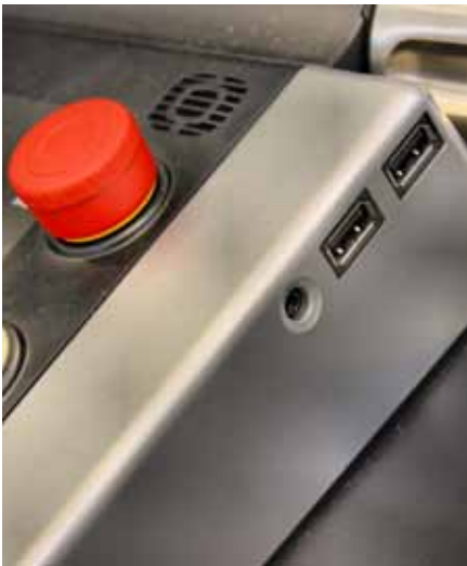
Zwei USB-Anschlüsse erlauben den Anschluss von USB-Speichersticks, einer Maus oder anderen USB-fähigen Geräten.
