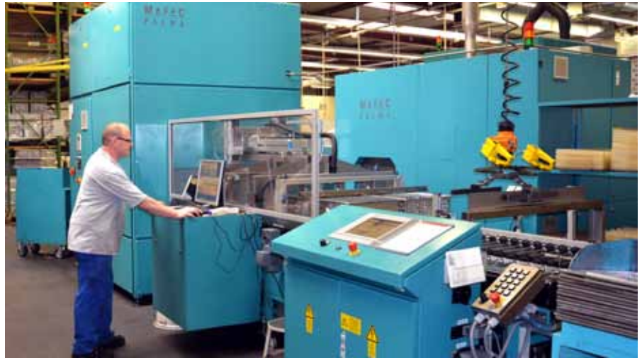
Für die hohen Durchsatzzahlen schaffte das Unternehmen Grieshaber zwei Dreitanlagen mit Spritz-Flutverfahren an. Diese reinigen täglich bis zu 250 000 Drehteile.
