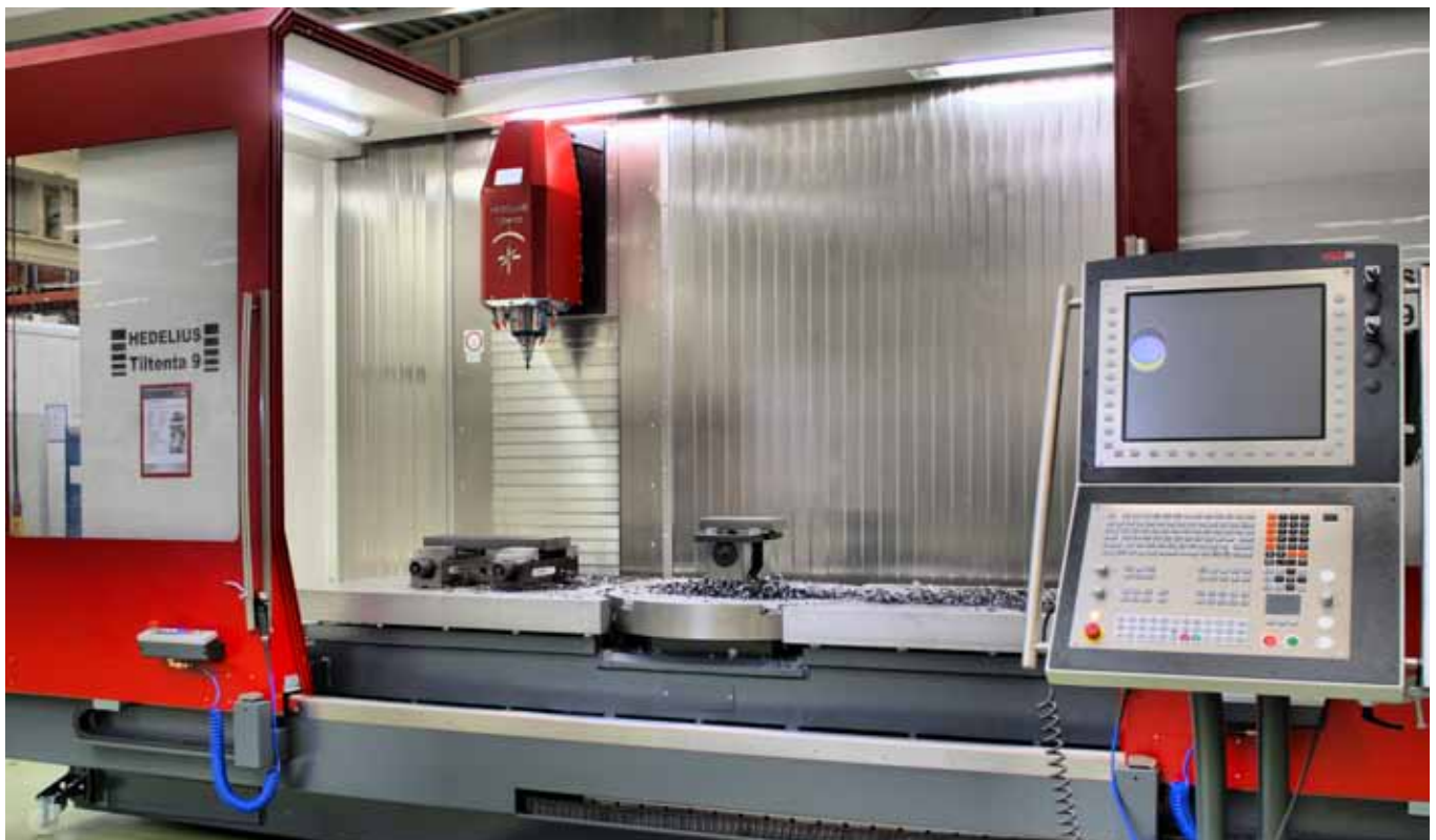
Die »Tiltenta 9« ist das neueste Highlight im BAZ-Portfolio von Hedelius. Mit diesem Modell werden neue Möglichkeiten eröffnet, lange Werkstücke via Fünfachsbearbeitung zu zerspanen.
