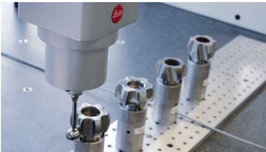
Mit dem Koordinatenmessgerät ›Reference‹ von Leitz können Kugelbahnen mithilfe einer Funktionskugel gescannt werden, die der Kugel entspricht, die später darin läuft.
