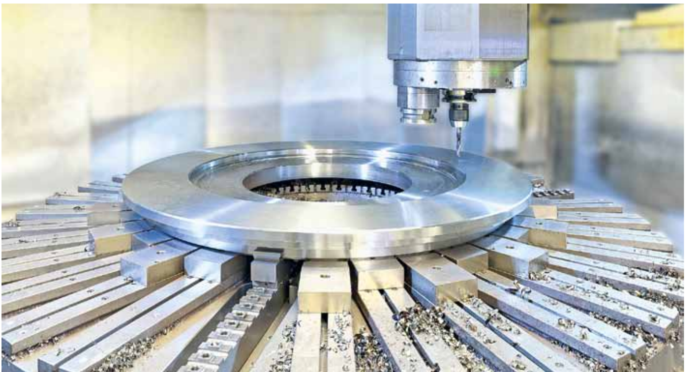
Hybridfutter vereinen ein klassisches Zentrierfutter und eine runde Magnetspannplatte. Sie zentrieren die Werkstücke und spannen diese deformationsfrei.
