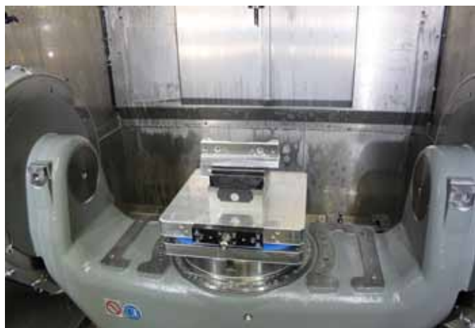
Der kompakte Aufbau des Zentrischspanners ›C2‹ von Gressel erlaubt die Fünfseitenbearbeitung in einer Aufspannung.
