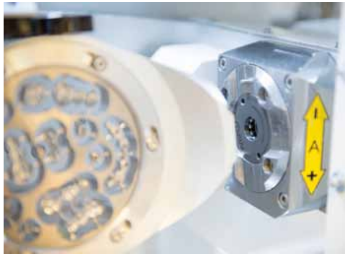
Nullpunkt-Spannsystem mit Klasse 38 Mit dem AMF-Nullpunktspannsystem gelingt die Vollautomatisierung in der Fräsbearbeitung sogar bei Tischmodellen.
