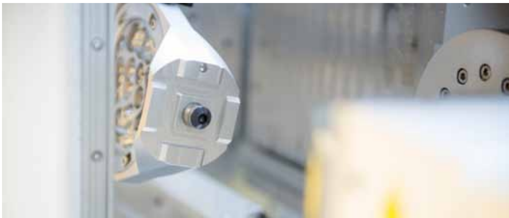
Die Rondenhalter mit den darin eingespannten Blanks werden mit passenden, in den Boden integrierten AMF-Spannnippeln direkt gespannt.
