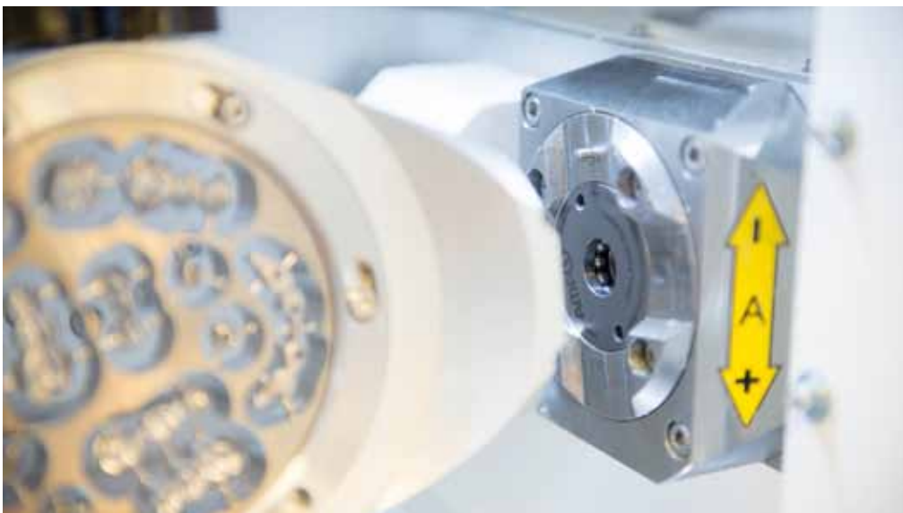
Das Nullpunktspannsystem von AMF ermöglicht Vollautomatisierung in der Fünffachs-Simultanbearbeitung aller Werkstoffe im Dentalbereich mit Maschinen von Imes-Icore.
