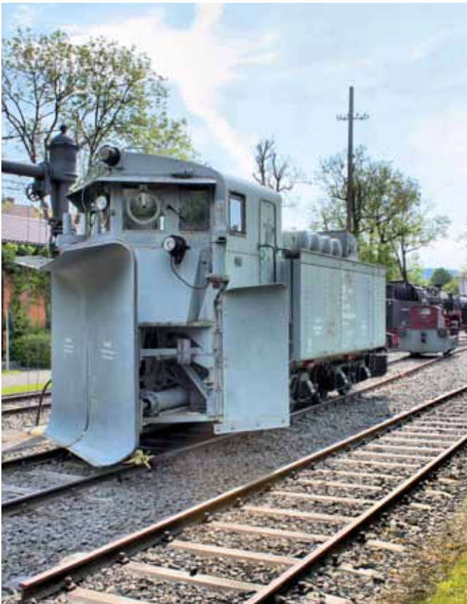
Schneepflüge konnten dank der per Druckluft beweglichen Pflugscharen den Schnee auch nach nur eine Seite schieben, was bei zweigleisigen Strecken wichtig war.
