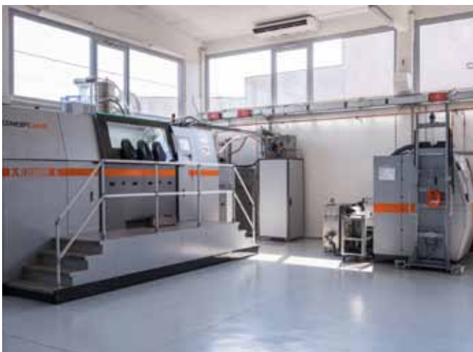
Die »X Line 2000R« von Concept Laser ermöglicht es dem Unternehmen Zare, am Markt auch größere, 3D-gedruckte Teile anzubieten.
