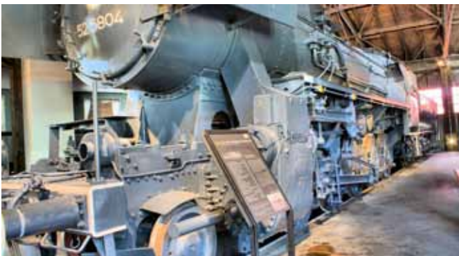
Das Modell »52 5804« wurde 1944 als Kriegslok in Dienst gestellt. Bei diesen Loks wurde die Konstruktion auf die allereinfachste Bauweise reduziert.
