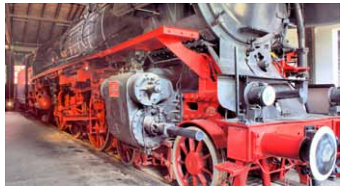
Anders als Kriegsloks wurden normale Loks konstruktiv aufwendig hergestellt. Sie bekamen unter anderem Speichenräder und sauber gearbeitete Windleitbleche.
