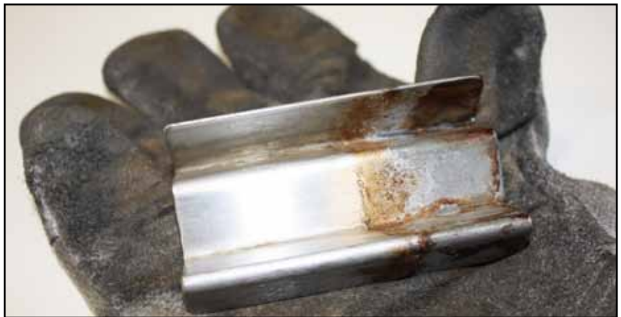
Selbst eigene Handschuhe für VA-Arbeiten müssen beim Umgang mit ›Edelstahl-Rostfrei‹ verwendet werden. Wer dies nicht beachtet, fördert Rost an seinen Werkstücken.
