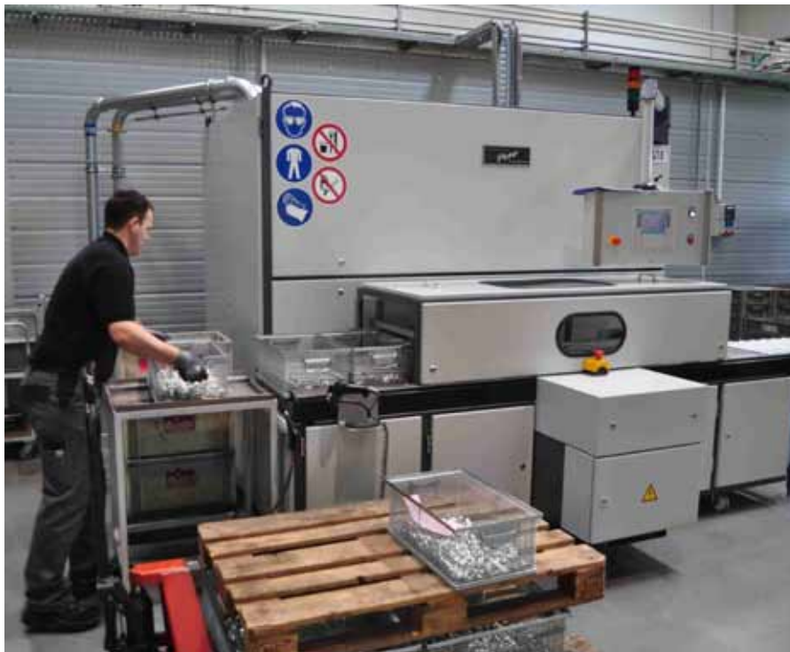
Die Pero R1-Voll-Vakuum-Reinigungsanlage arbeitet vollautomatisch die manuell aufgelegten Waschkörbe ab und fügt sich gut in das Mehrmaschinen-Bedienkonzept von Föhl ein.
