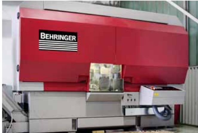
Eine Schnittdrucksteuerung mit Servovorschub und ein Hartmetallpaket zählen bei der HBM-Baureihe zur Basisausstattung.
