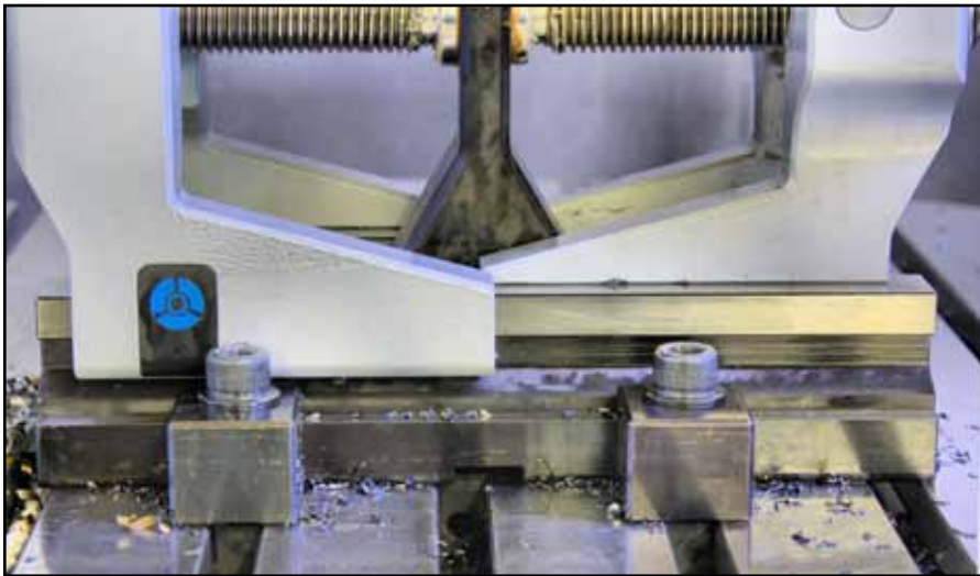
Besonders lange Führungen, deren Gestaltung sich Röhm patentieren ließ, garantieren eine zuverlässige Aufnahme der Spannkräfte.
