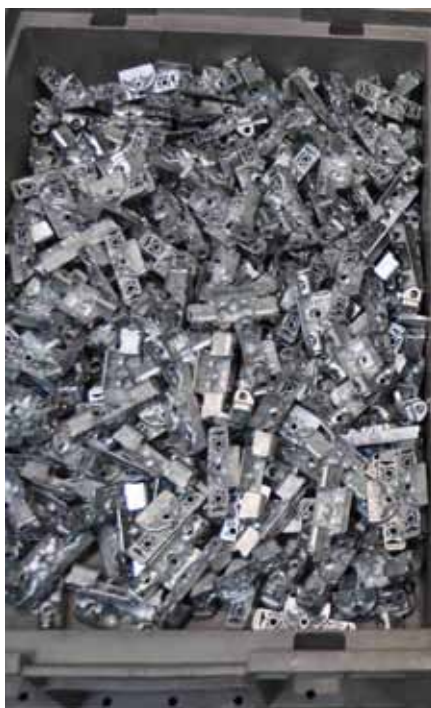
Nach der Reinigung in der »R1«: Saubere Breschlagteile für die Möbelindustrie.
