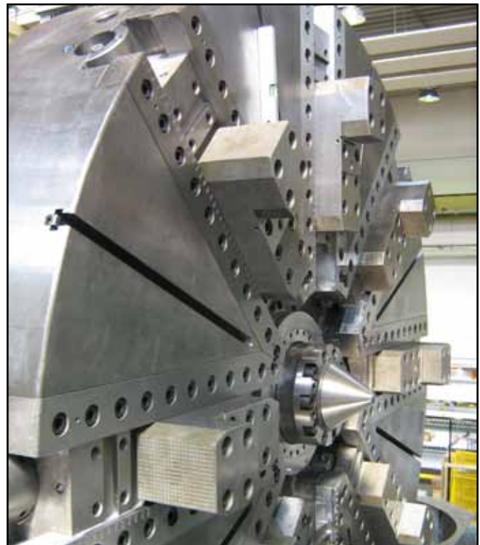
Spannspindeln von Jakob besitzen eine ausgeklügelte Mechanik, die eine Selbsthemmung in jeder Spannstellung gewährt.
