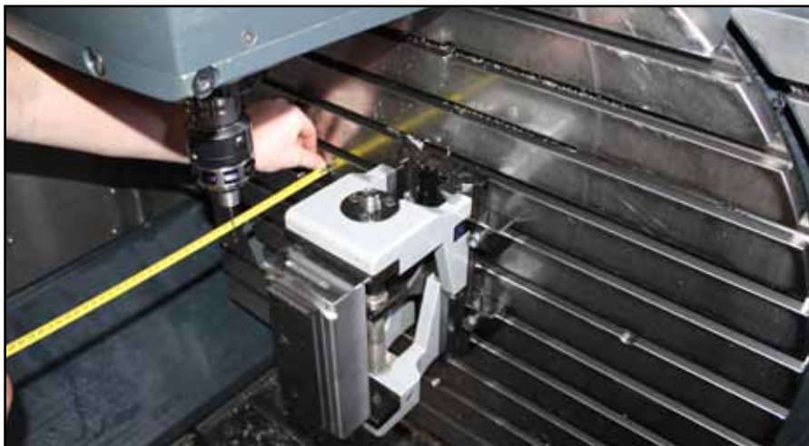
Die hohe Bauart macht das Unterbauen von Abstandsplatten überflüssig. Dank 200 Millimeter Mindestmaß werden alle Werkstückstellen locker erreicht.
