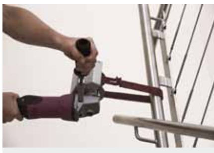
Bänder mit Knopflochverschluss sind perfekt für Arbeiten an Rohrkonstruktionen.
