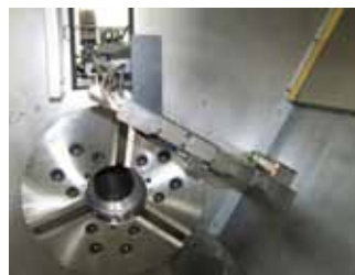
Präzision wird durch den prozessbegleitenden Messtechnik-Einsatz leichter erreicht.
