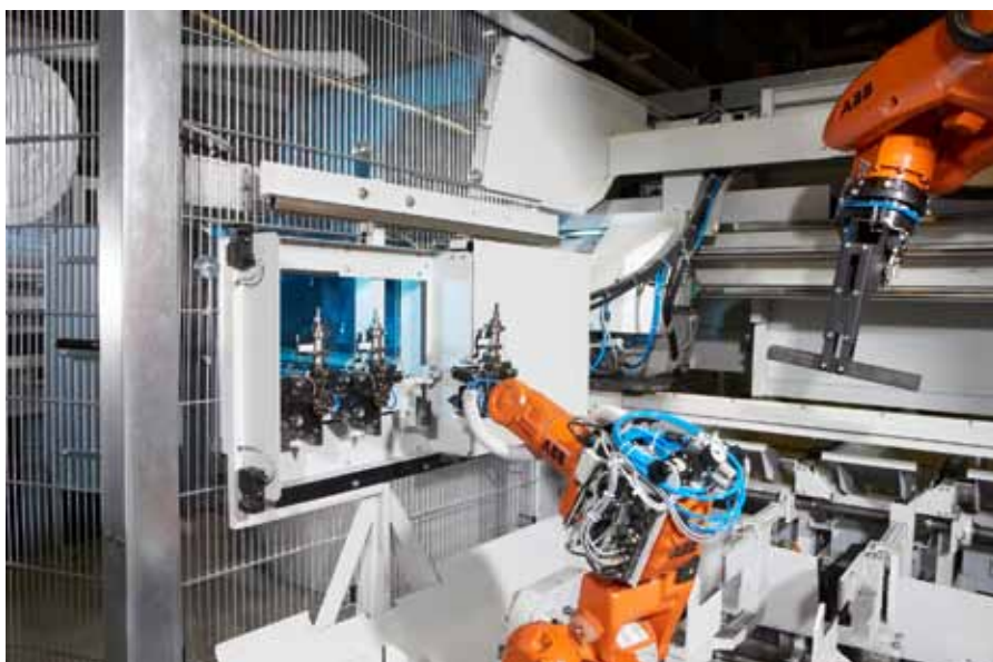
›Kastosort‹, hier an der ›Kastovariospeed C15‹, handhabt mannlos Sägeabschnitte. Das System gibt es auch mit Entgratroboter und vollautomatischer Fräserwechseinheit.
