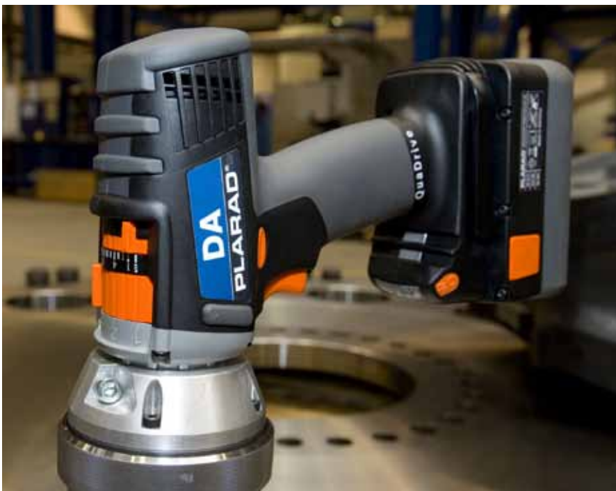
Der Akku-Drehschrauber ›DA‹ von Plarad kann Schrauben bis 2600 Nm anziehen. Um die Drehmomentgrenze sicher einzuhalten, schaltet sich das Gerät automatisch ab.
