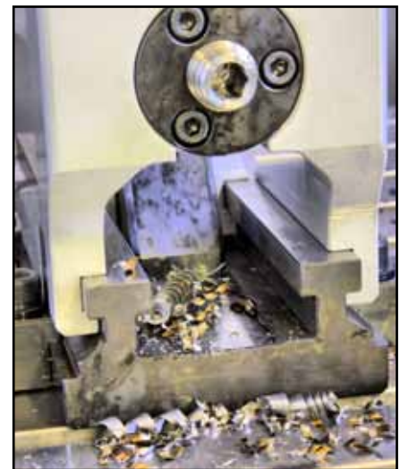
Die offene Bauweise garantiert einen guten Spänefall und einfache Reinigung.
