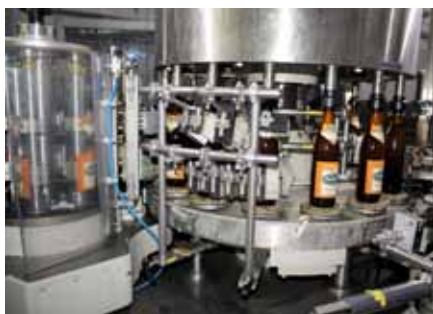
Vollautomatisch werden die jeweiligen Getränkeetiquetten in hohem Tempo auf die Flaschen aufgebracht.
