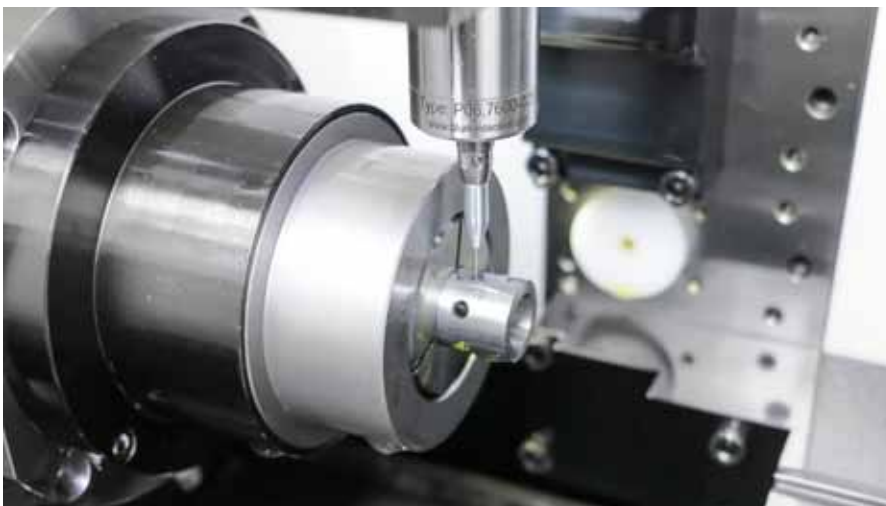
Der Messtaster ›TC76-Digilog‹ der Blum-Novotest GmbH scannt die komplette Kontur des Langlochs – eine echte Innovation in der Fertigungsmesstechnik.
