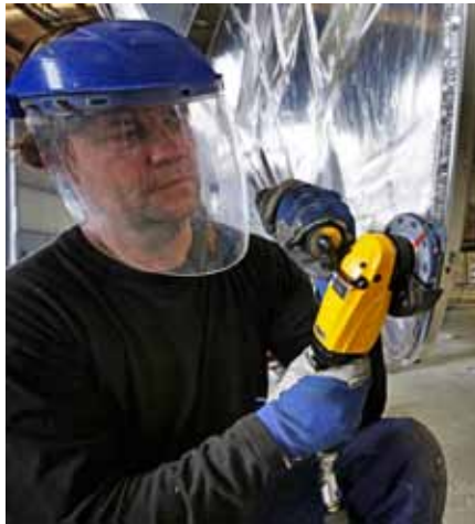
Gutes Alu-Gespann: Der Turboschleifer ›GTG 25‹ und die Alumaster-Disc.
