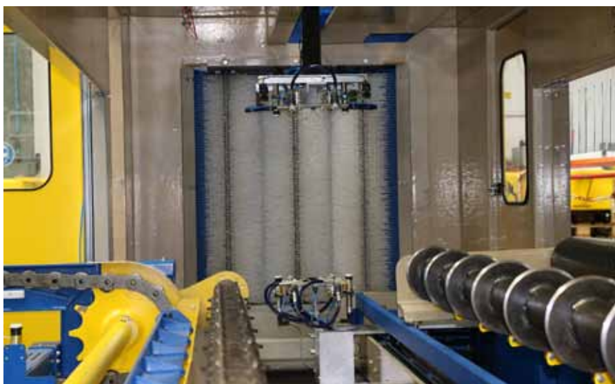
Innovative Detaillösung der Konservierungslinie von Rösler: Die Bürstenvorabscheidung reduziert die Belastung des Feinfiltersystems um 60 bis 80 Prozent.
