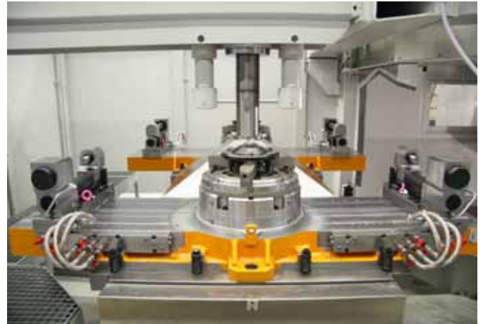
Das Spann- und Spankonzept für die Flansche spezieller Fahrachsen wurde von SSB in enger Zusammenarbeit mit dem Kunden entwickelt.
