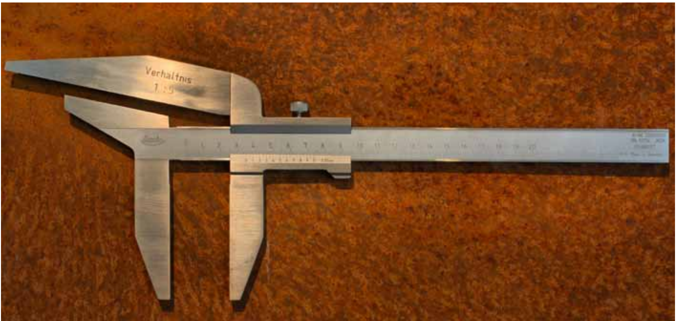
Der Kornform-Messschieber zum Bestimmen des Längen- und Dickenverhältnisses von Steinen ist zur Ermittlung der Korngröße gedacht. Auch dieses Modell dokumentiert Scalas Klasse, ungewöhnliche Messaufgaben mit besonderen Messschiebern zu lösen.
