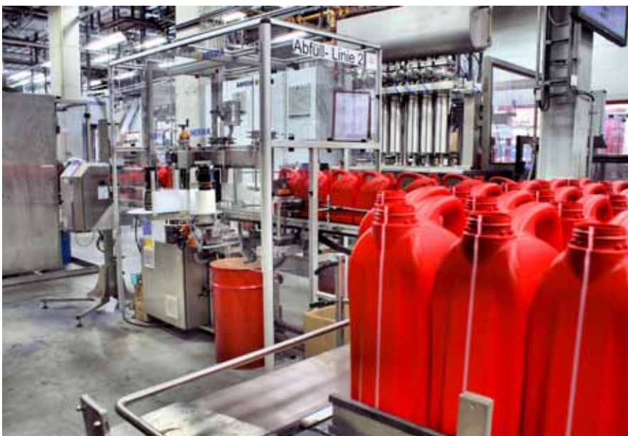
Öle von Zeller+Gmelin werden, wie hier die Kraftfahrzeugöle, auf modernsten Anlagen abgefüllt und verpackt. Nur wenige Fachkräfte sind dazu nötig.
