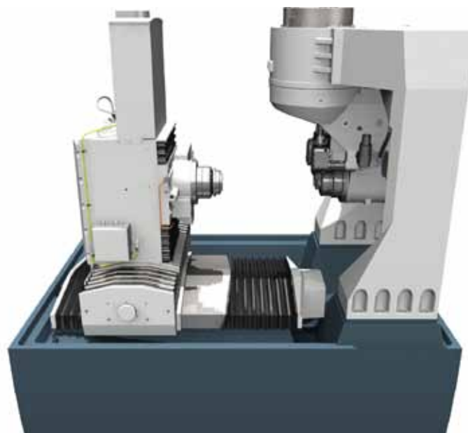
Linx-Linearmotoren auf den X-, Y- und Z-Achsen sowie Drehachsen (A und C) mit Direktantrieb, Spindel-Spitzenleistung: 37 kW.
