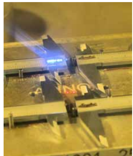
Logo und Skalen werden per Laser präzise und dauerhaft eingegraben.
