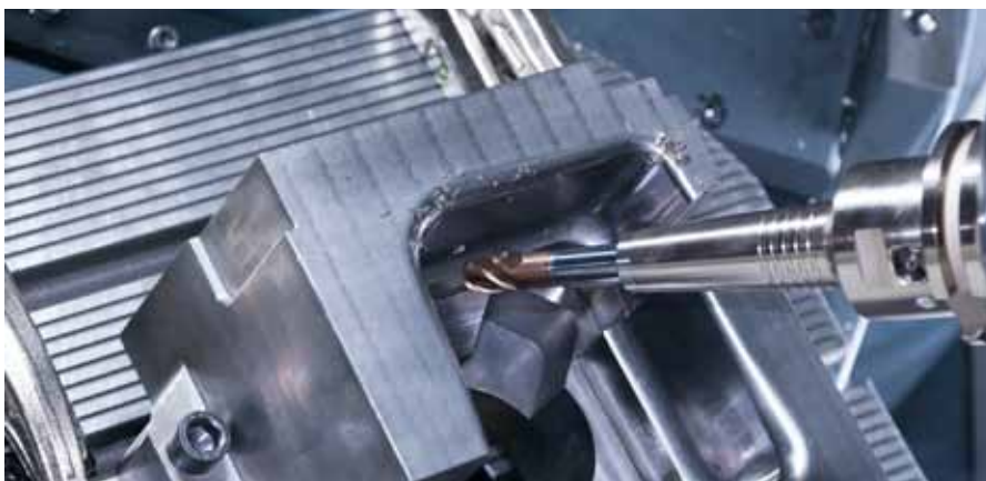
Kugelfräser vom Typ »EHHB« von MMC Hitachi Tool sind speziell für die Hartbearbeitung ausgelegt und gut für das Schlichten von mittellegierten Stählen geeignet.
