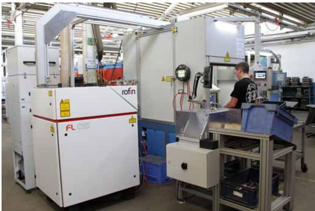
zum Verschweißen von Vierkant-Stahleinsätzen mit Edelstahlgriffen setzt das Unternehmen Hoppe auf eine Faserlaseranlage des Typs ›FL 015‹ von Rofin, die über 1,5 kW Leistung verfügt.
