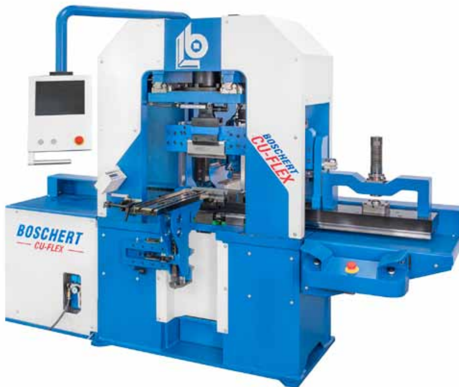
Das Kupfer-Bearbeitungszentrum ›CU-Flex‹ von Boschert besitzt eine mittige Presseneinheit sowie nach links und rechts verfahren Arbeitsstationen zum Stanzen, Biegen und Scheren.
