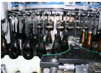
Die Befüllungsmaschinen sind so konstruiert, dass Luftsauerstoff vom eingefüllten Bier ferngehalten wird.
