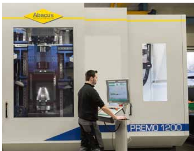
Bei der ›Premo 1200 gemini‹ von Abacus können die beiden Hauptrevolver unabhängig voneinander gesteuert werden.
