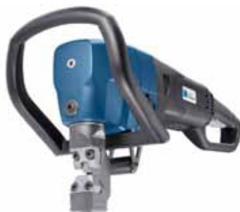
Der Dickblechnibbler ›Trutool N 1000‹ verfügt über einen Motor mit 2600 Watt.
