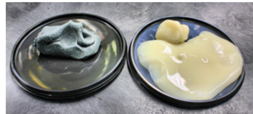
Mit »Multicut Flowgrind« können in geometrisch komplex geformten Werkstücken Grate entfernt und Oberflächen geglättet werden. Dazu werden Siliconpolymere (rechts) mit abrasiven Partikeln, beispielsweise Siliziumcarbid, versetzt (links).
