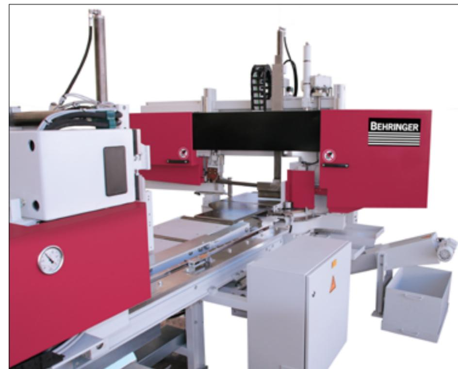
Mit einem Schnittbereich im Flachmaterial von 520 x 320 mm sowie beidseitigen Gehrungen von 45 und bis 30 Grad links erweist sie sich die ›HBE320-523GA‹ als Generalist für viele Sägaufgaben.
