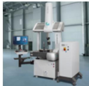
flächen lassen sich ohne teure Beschichtungs- und Reinigungsvorgänge, wie sie viele berührungslose Messtechnologien erfordern, einfach vermessen. Die in Verbindung mit der Global Advantage HTA-Lösung eingesetzte Bladesmart-Inspektionssoftware enthält eine Befehlsbibliothek zur Messung der Geometrie von Rotorschaukeln, -plattformen und -füßen zur Erstellung und Inbetriebnahme von Messprogrammen.
