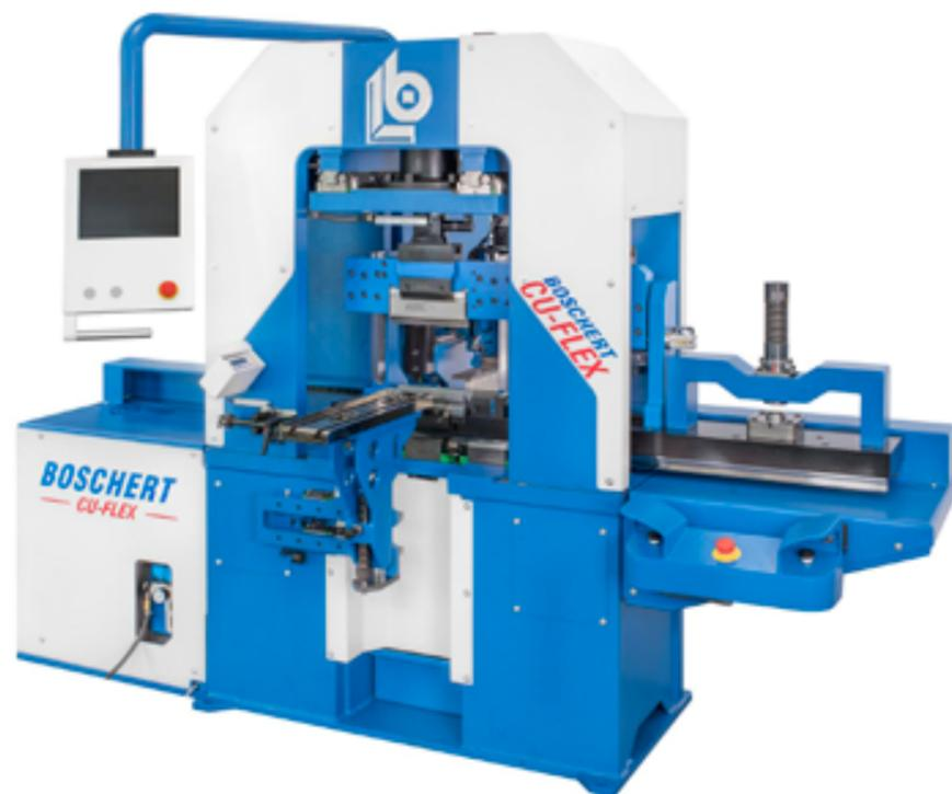
Das Kupfer-Bearbeitungszentrum ›CU-Flex‹ von Boschert besitzt eine mittige Presseneinheit sowie nach links und rechts verfahrenende Arbeitsstationen zum Stanzen, Biegen und Scheren.
