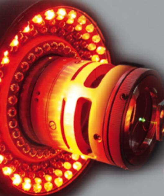
**Messen mit Multisensorik Werth Fasertaster WFP – hochgenauer 3D Mikrotaster zur „kraftfreien“ Antastung sensibler und filigraner Bauteile**
