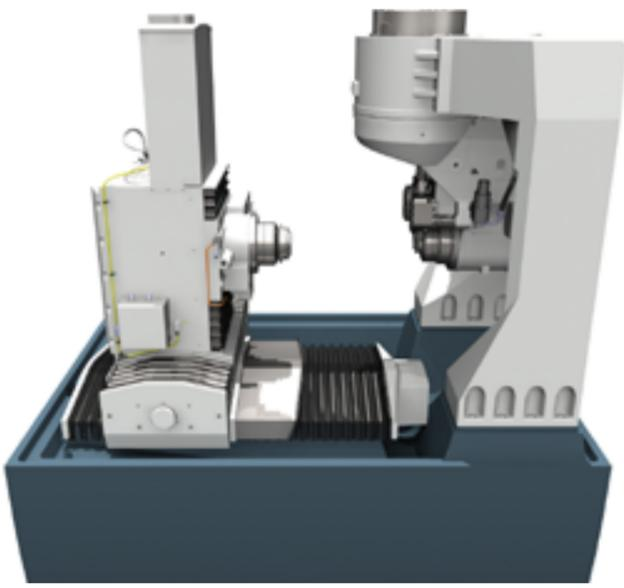
Linx-Linear Motoren auf den X-, Y- und Z-Achsen sowie Drehachsen (A und C) mit Direktantrieb, Spindel-Spitzenleistung: 37 kW.
