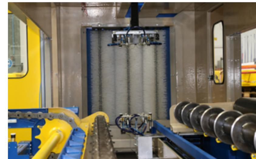
Innovative Detaillösung der Konservierungslinie von Rösler: Die Bürstenvorabscheidung reduziert die Belastung des Feinfiltersystems um 60 bis 80 Prozent.
