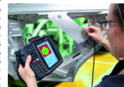
testen. Im Gegensatz zur Prüfung nach Prüfplan sind alle Ultraschall- und Auswerteparameter frei einstellbar. Der Prüfer kann aber auch auf hinterlegte Datensätze zugreifen; in diesem Fall muss er im Gerätemenü nur noch das Material und die Materialdicke wählen. Ideal, wenn häufig identische Materialien zu prüfen sind, um nicht jedes Mal neu einstellen zu müssen. Falls nicht bekannt, lässt sich die Einzelblechstärke direkt mit der Wanddicken-Messfunktion des Systems ermitteln.
