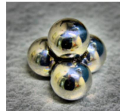
**Ölqualitätsprüfung: eingeeilte Kugeln werden in Rotation versetzt und durch Reibkräfte miteinander verschweißt.**
