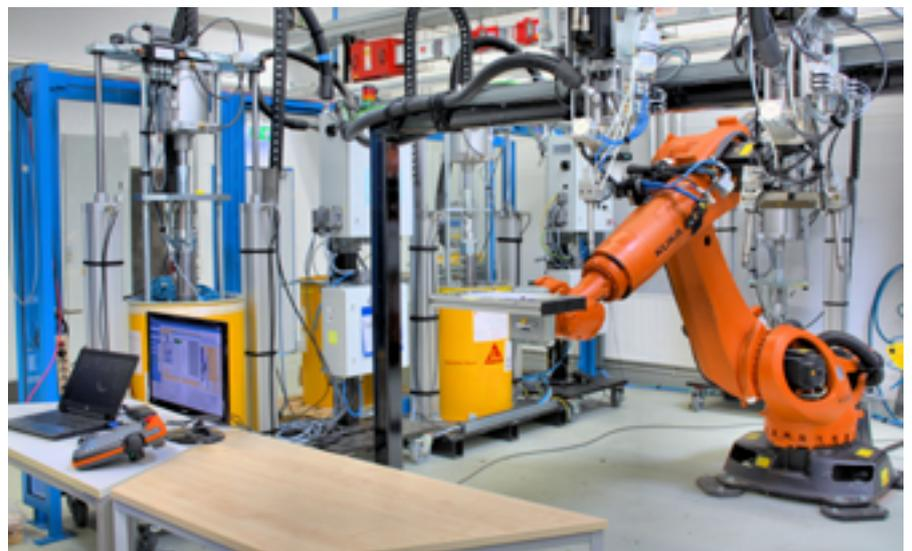
Mit seinen Komplettanlagen für das robotergestützte, präzise und rasche Auftragen von Klebstoff auf zu fügende Teile spricht Nimak alle Branchen an, in denen die Vorteile des Klebens für große Serien genutzt werden sollen.
