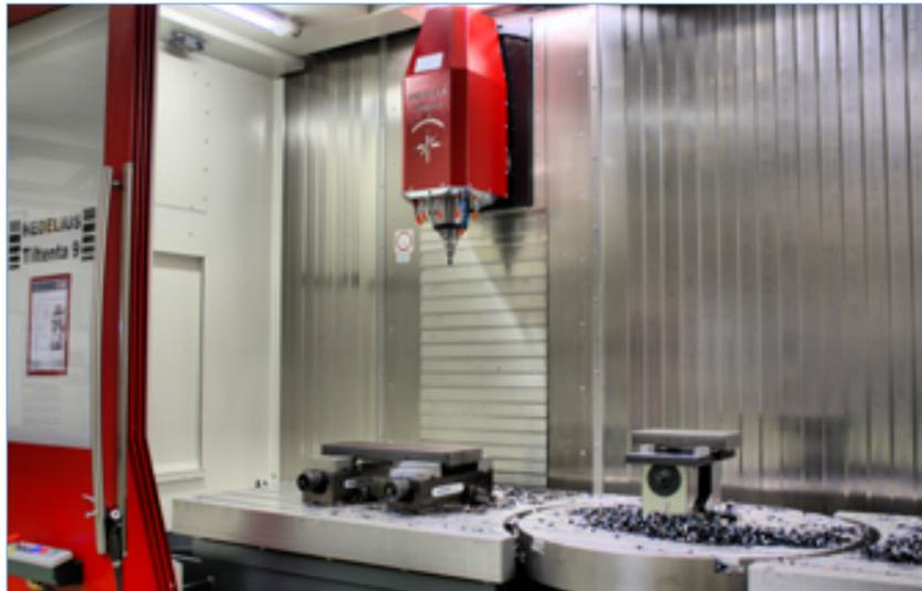
Mit der innovativen ›Tiltenta 9‹ von Hedelius werden neue Möglichkeiten eröffnet, lange Werkstücke via Fünfbearbeitung zu zerspanen.
