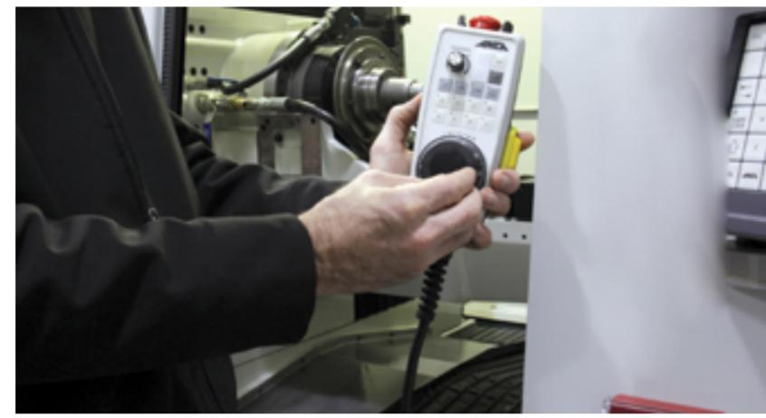
Die handgehaltene Fernbedienung ermöglicht dem Bediener einen sicheren und einfachen Zugang zur Maschinensteuerung.
