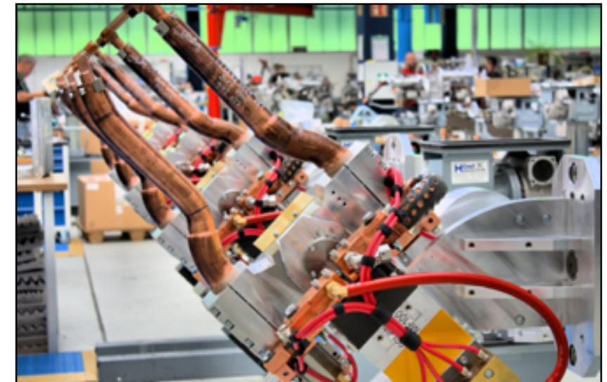
Die Mehrzahl wichtiger Komponenten für die leistungsstarken Schweißzangen von Nimak werden in der eigenen Fertigung produziert. Eigene Prüfstände stellen sicher, dass ausschließlich voll funktionsfähige Exemplare den Weg zum Kunden antreten.
