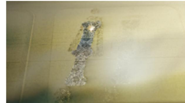
Schicht um Schicht baut die ›M2 cusing‹ von Concept Laser die Geometrie des ›Unlinger Reiters‹ auf.
