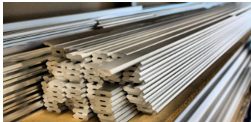
Die Messschienen der Alinox-Messschieber bestehen aus präzise gezogenem, eloxierten Aluminiumprofilen. Diese ermöglichen den Bau von Messschiebern mit bis zu vier Metern Länge.
