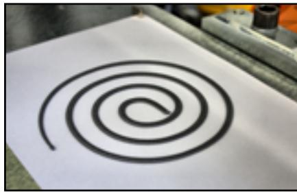
Die ausgereifte Konstruktion der Dosieranlagen von Nimak garantiert, dass selbst im Fall einer kontinuierlich gesteigerten Robotergeschwindigkeit eine gleichmäßige Klebstoffraupe entsteht.
