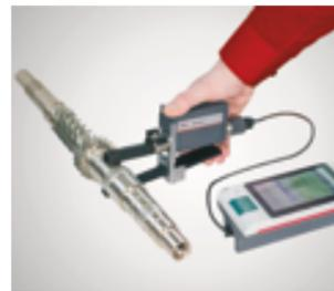
Smartphone gewöhnt sind. Das kleine Gerät bietet mit 31 Kenngrößen einen Leistungsumfang wie ein Laborgerät und ist der preislich attraktive Start in die Normmessung von Oberflächen. Die Messdaten können in den Formaten TXT, X3P, CSV oder PDF als fertig aufbereitete Messprotokolle gesichert werden. Neben dem mobilen Einsatz kann das Gerät auch an einem Messständer befestigt werden und wird so zu einem festen Messplatz.
