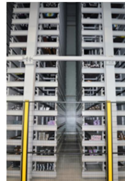
Dank des neuen Automatiksystems von Remmert lagern rund 4.000 Tonnen Stahl auf nur 370 m<sup>2</sup> Grundfläche.
