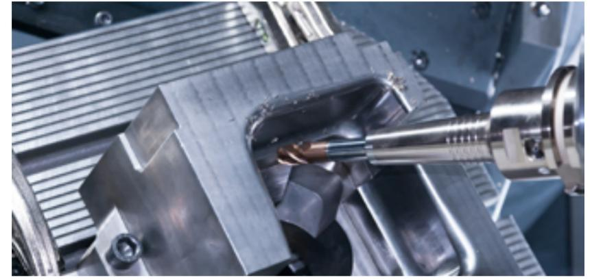
Kugelfräser vom Typ »EHHB« von MMC Hitachi Tool sind speziell für die Hartbearbeitung ausgelegt und gut für das Schlichten von mittellegierten Stählen eignet.
