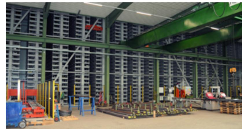
Um einen optimalen Materialfluss zu ermöglichen, verfügt die Anlage über zwei Lagerstationen: Eine Schnellwechselstation für die Ein- und Auslagerung sowie für die Kommissionierung.
