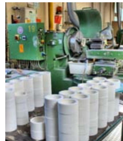
Rohlinge müssen nach dem Brennen per Drehmaschine in Form gebracht werden, um exakte Normmaße zu erreichen.
