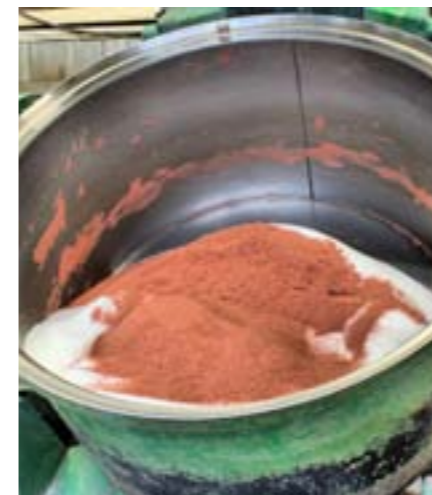
Korund beziehungsweise Karbid sowie Bindemittel in Pulverform bilden die Grundlage für jede Schleifscheibe.
