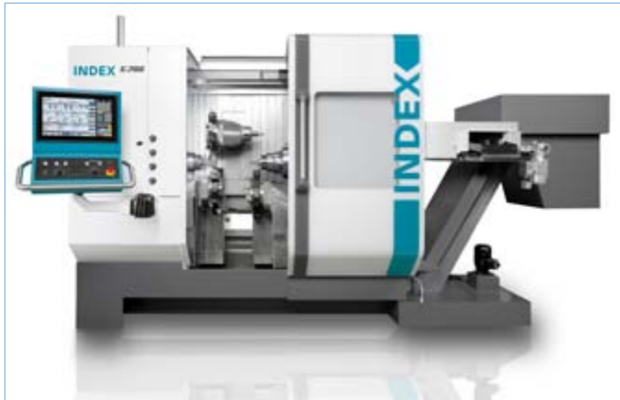
Die neue Dreh- Fräsmaschine »G200« von Index enthält umfangreiche Verbesserungen vom Maschinenaufbau bis zur Leistungsfähigkeit der Frässpindel.
