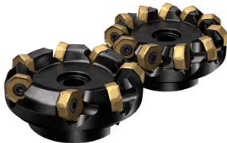
Der Planfräser ›CoroMill 745‹ wird von Sandvik als differential und gleich geteilter Fräser angeboten. Alle Fräserkörper besitzen einen Einstellwinkel von 42 Grad.
