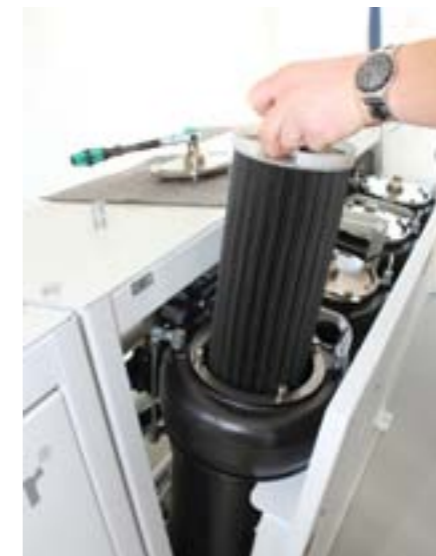
Ein Kernelement der Knoll-Feinstfilter vom Typ Micropur sind die Filterpatronen, die regelmäßig prozessparallel rückgespült werden.
