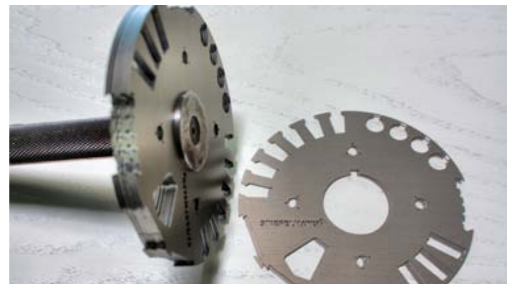
Wie der Grenzlehrdorn demonstriert, ist es mit Lasermaschinen von Stiefelmayer möglich, Passungen in Blechteilen einzubringen. Ein Goodie, das alles andere als selbstverständlich ist.
