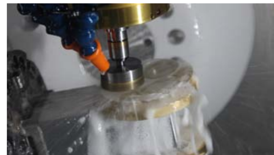
Ob Glas oder Keramik: Dank der inneren Kühlmittelzufuhr wird das Werkzeug immer an der Stelle frei gespült, gekühlt und geschmiert, wo es notwendig ist.
