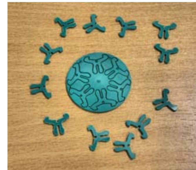
Ohne Startloch sind Serienteile mit filigranen Konturen und kleinen Toleranzen in wenigen Sekunden ausgeschnitten.
