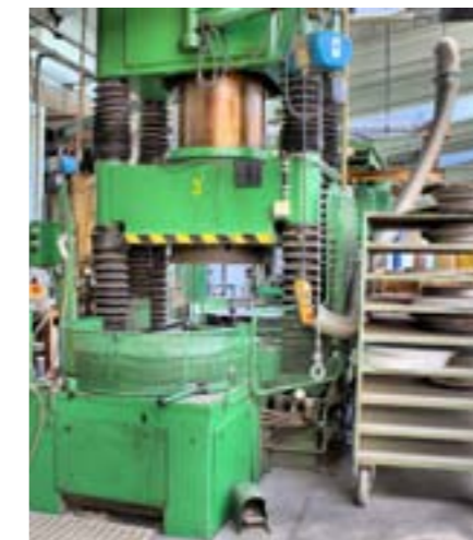
Bis zu 750 Tonnen Presskraft sind nötig, um das vermischte Pulver haltbar in Formen zu pressen.
