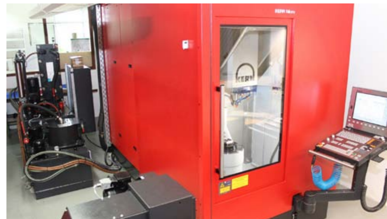
Mit der »Micro Keramik« hat Kern ein kombiniertes Fräs- und Schleifzentrum entwickelt, das sich insbesondere für die simultane Fünffachbearbeitung von Keramik eignet.
