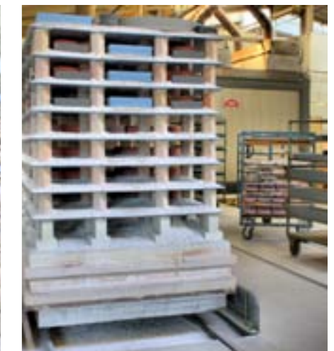
Bis zu drei Tagen werden die gepressten Rohlinge in einem Ofen gebrannt und erhalten so ihre Gebrauchsfestigkeit.
