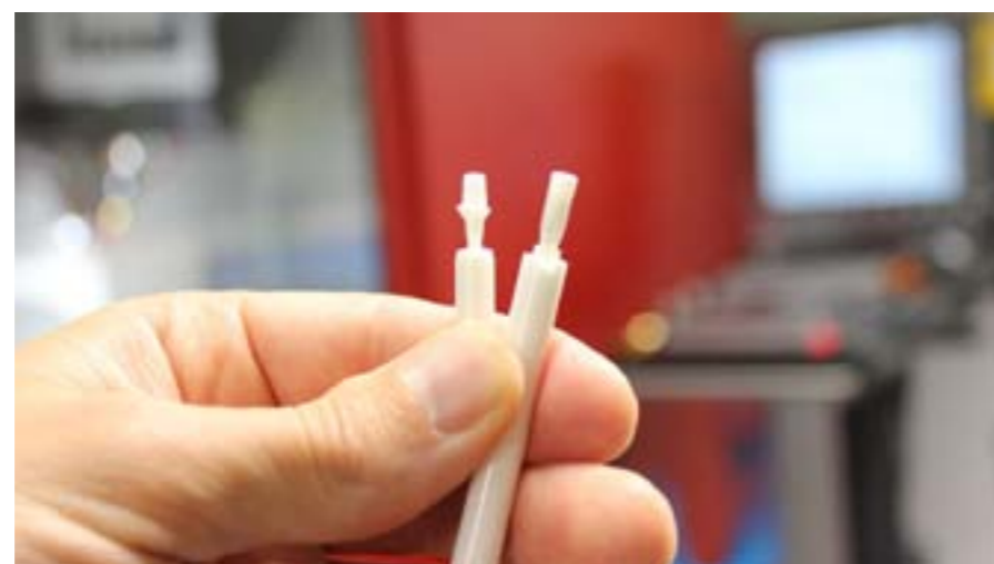
Die Kern Micro Keramik macht's möglich: Hartkeramik wird gefräst, geschliffen sowie mit Gewinden und Bohrungen versehen.
