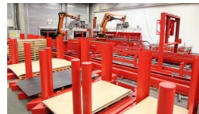
ASPA realisiert die Kommissionierung, Stapelbildung, Etikettierung und Verpackung von rund 60 Blechen pro Stunde.
