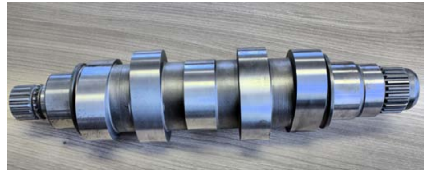
Unrunde Teile sind mit der leistungsstarken Steuerung sowie der präzisen Mechanik der Weiss-Rundscheifmaschinen problemlos zu schleifen. Sogar CAD-Daten lassen sich per DXF-Format in die Steuerung übertragen, um beispielsweise Steuernocken mit völlig unterschiedlichen Profilen zu schleifen.
