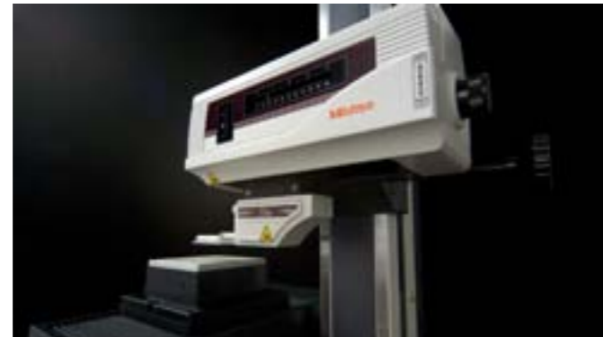
Surftest SV-3200 misst Primär-, Rauheits- und Welligkeitsprofil.
