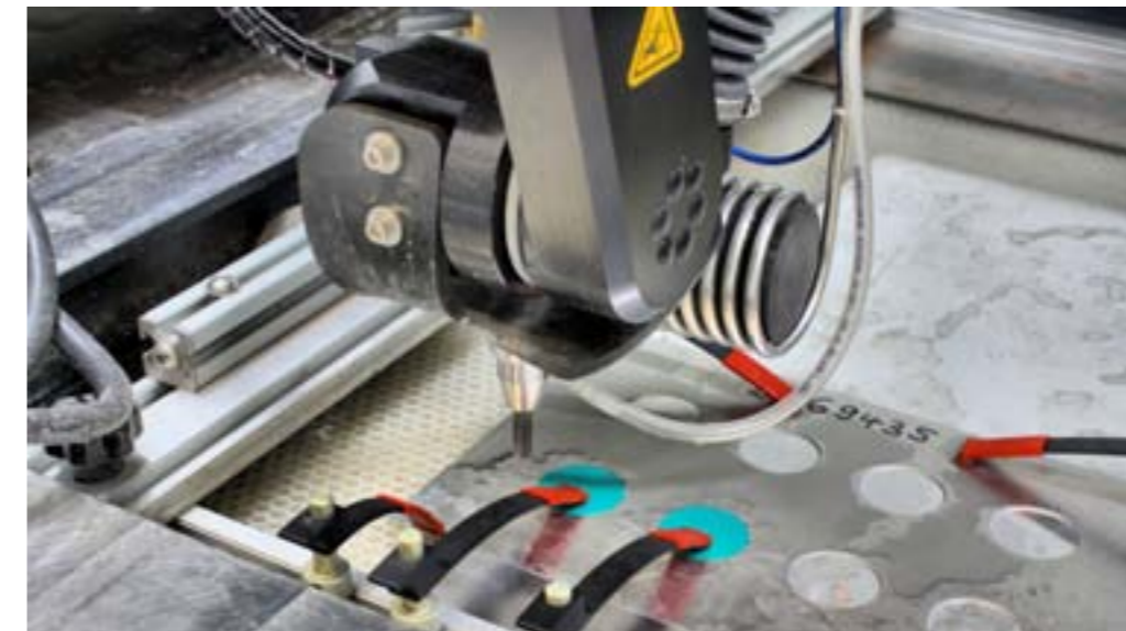
Eine einfache Spannmöglichkeit und die Erzeugung exakt winkliger Flächen mit dem beweglichen Präzisionsschneidkopfes ›Tilt-A-Jet‹ sind Merkmale der Micromax.
