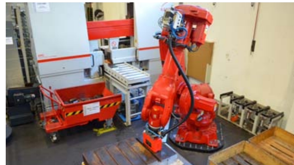
Die vollautomatische Bandsäge vom Typ ›Kastotec FC 4‹ sorgt für eine enorme Produktivitätssteigerung. Dazu trägt auch ein Roboter bei, der mit einer Abschnittsortierung ausgestattet ist.
