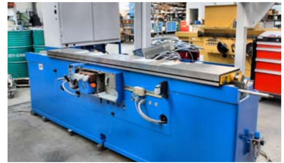
Retrofit mit Herzblut: Nach der Totalsanierung sind gebrauchte Karstens-Rundscheifmaschinen in einem Fast-Neu-Zustand.
