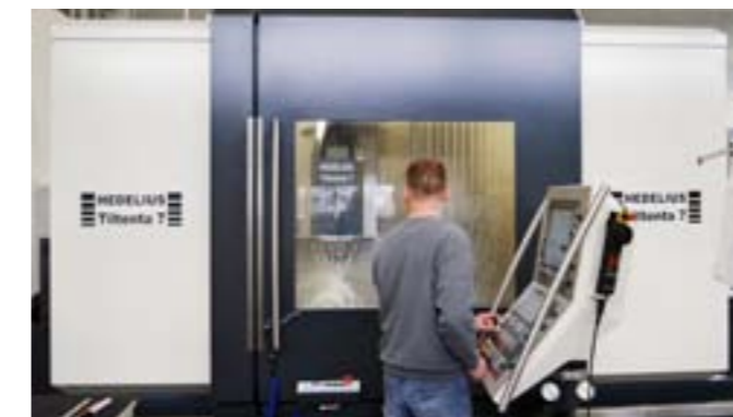
Auf der »Tiltenta 7 Single« von Hedelius werden bei D+P überwiegend Werkstücke aus Aluminium bearbeitet.
