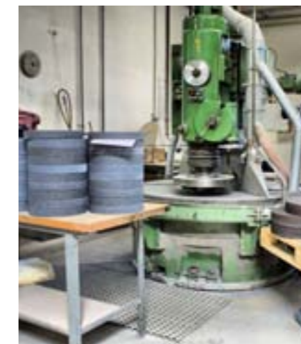
Via Tellerschleifmaschine erhalten gerade Schleifscheiben ihre normgerechte Dicke bis auf das Hundertstelmillimeter.
