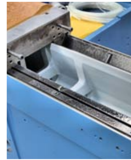
Eine neu beschichtete Führungsbahn einer »K11« von Karstens.
