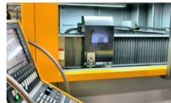
Stiefelmayer-Lasermaschinen glänzen mit CFK-Leichtbau, Lineardirektantrieben, Granitbett sowie messmaschinengerechter Ausrichtung aller Achsen.
