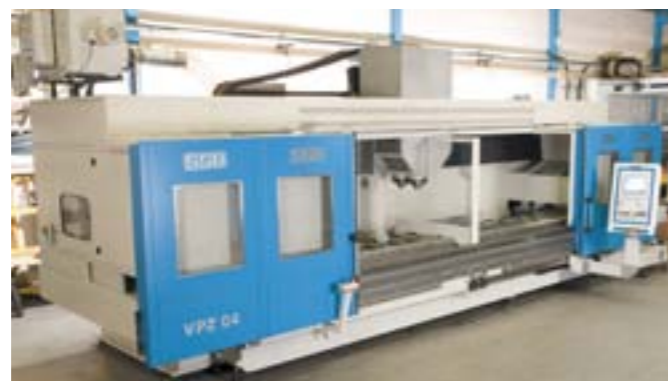
Rationale Pendelbearbeitung auch sehr großer Bauteile macht SSB mit dem VPZ-Konzept möglich.
