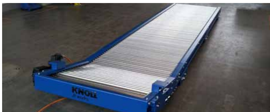
Die Plattenbandförderer von Knoll sind modular aufgebaut. Es gibt sie in frei wählbaren Nutzbreiten (Plattenlänge) von 140 bis zu 2000 Millimeter.
