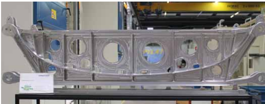
Bei einer Holzbrücke für das Mehrzweckflugzeug ›Pilatus PC-12‹ bleibt von einem knapp 380 Kilogramm schweren Rohteil ein Fertigteil übrig, das nur noch 35 Kilogramm wiegt.
