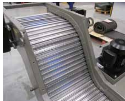
Die starke Profilierung der Knoll-Plattenbänder gewährleistet eine bestmögliche Material-Mitnahme.
