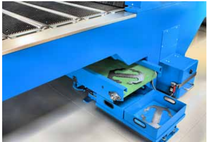
Ein optionales Förderband ist die sinnvollste Möglichkeit, die Teileausschleusung zu automatisieren.
