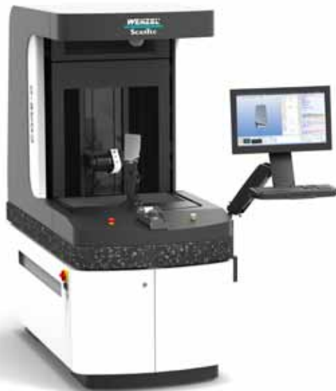
Die neue Generation des optischen High Speed Scanning-Systems »Core D« beim Scannen einer Turbinenschaufel.
