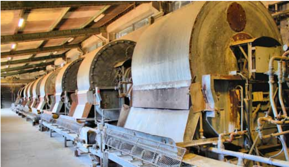
In der Aufbereitungsanlage wurden die Erze fein vermahlen, getrennt und unter Zugabe von Wasser und Reagenzien zu Konzentraten angereichert, die zur Weiterverarbeitung an die Hüttenwerke verkauft wurden.
