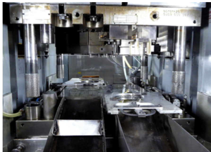
Da in der Feinschneidpresse unterschiedliche Werkstoffe verarbeitet werden, ist die Befettungsanlage für drei verschiedene Medien ausgelegt.
