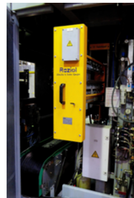
Die Sprüchkammer dient zum Beölen der Bänder an den Feinschneidpressen HFA.
