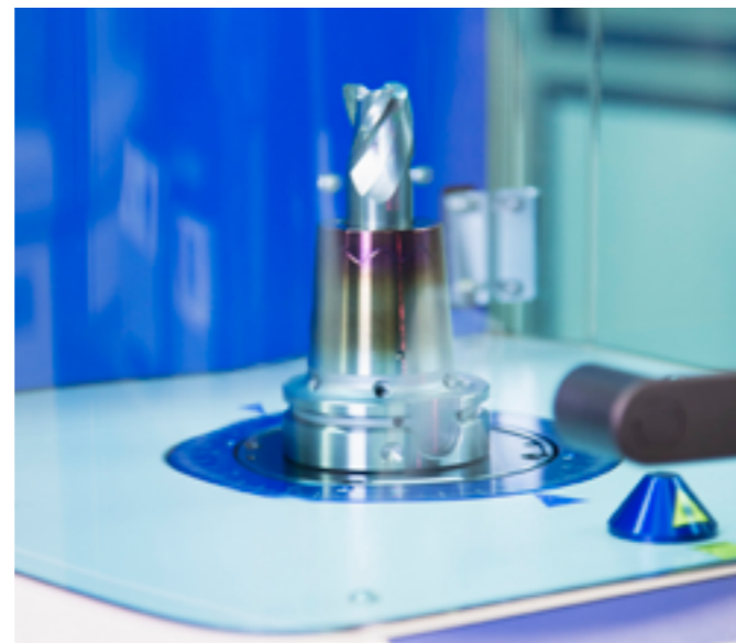
Mit dem Wuchtgerät ›Tool Dynamic Comfort‹ wird die Wuchtgüte der Werkzeuge bei 33 000 U/min geprüft und korrigiert.
