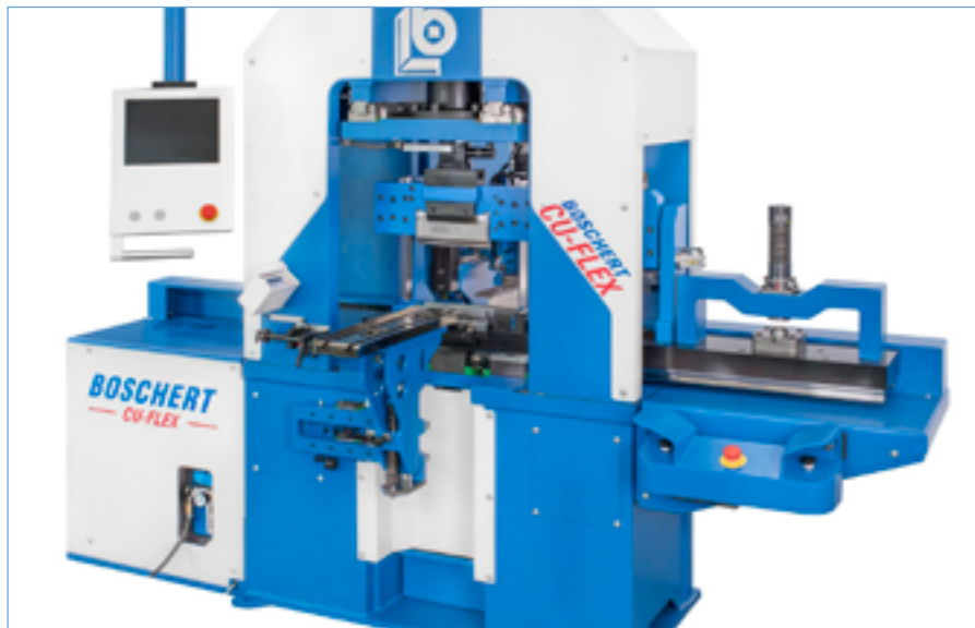
Das Kupfer-BAZ ›CU-Flex‹ von Boschert erlaubt mit seinen drei Stationen Stanzen, Biegen und Scheren unter anderem die Komplettbearbeitung von CU-Stromschienen.
