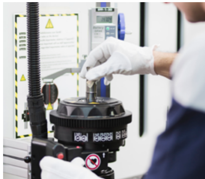
Einfacher Schrumpfvorgang: Für jedes Schrumpffutter sind bereits alle benötigten Parameter hinterlegt.
