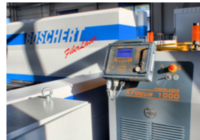
Faserlaser von Kjellberg mit ein, zwei oder vier Kilowatt Leistung stehen für die Boschert Fiberlaser zur Wahl.
