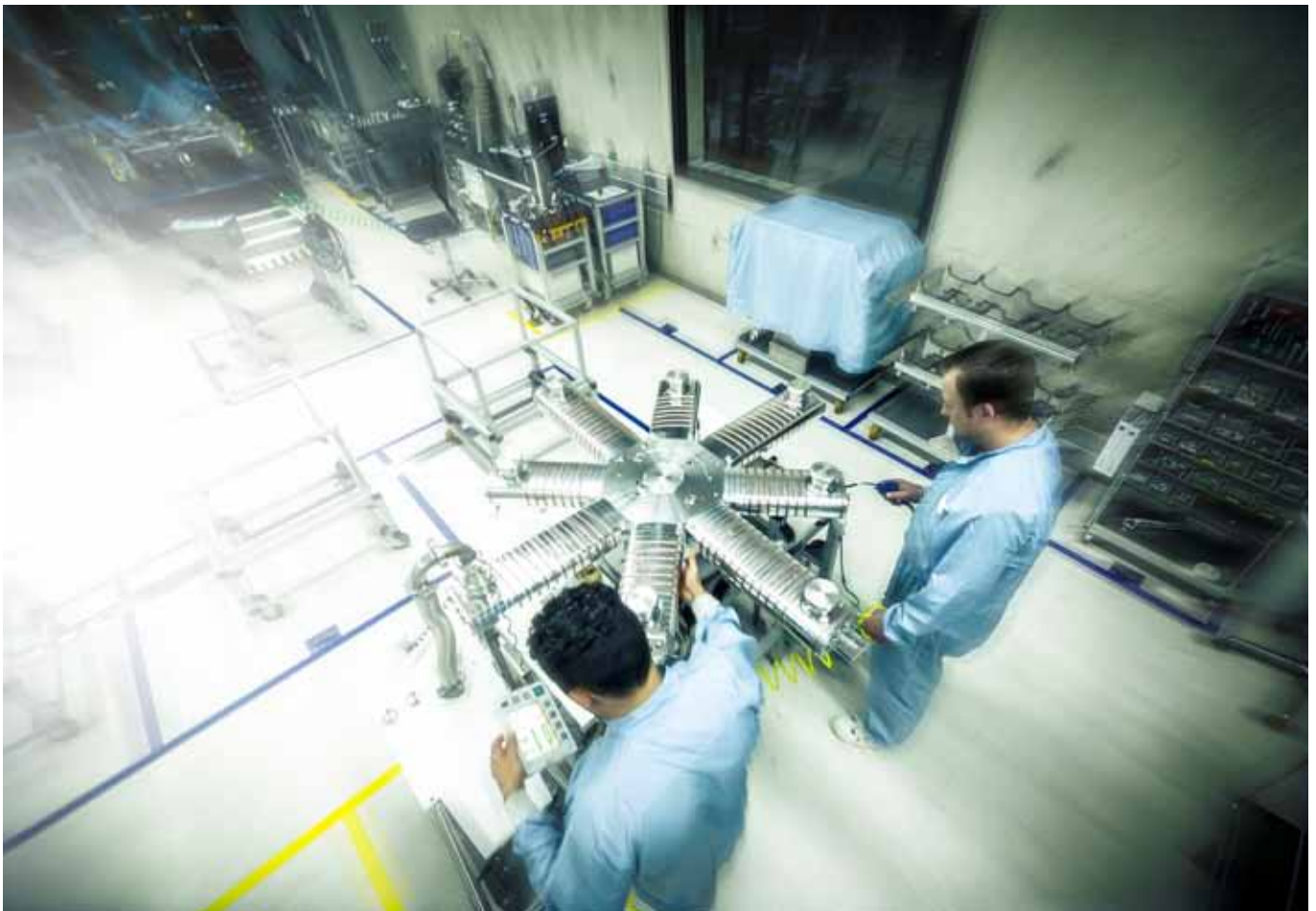
Prüfung eines Hochleistungs-CO 2 -Laser-Moduls. Vier dieser Systeme und ein sogenannter ›Seedlaser‹ ergeben den Trumpf Laser Amplifier.
