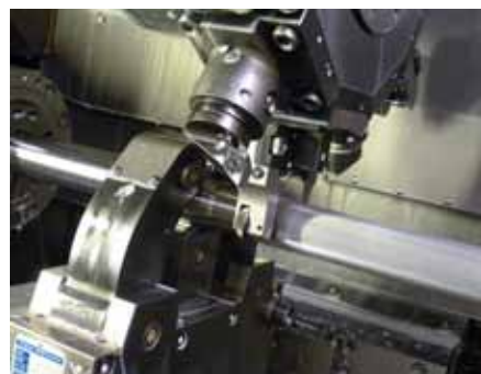
Zeus RD2-Rändelwerkzeug auf der Index G300.
