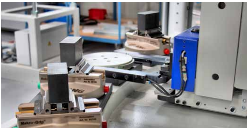
Der Lineararm des Eco Compact 20 kann Spannmittel und Teile von bis zu 40 Kilogramm Gesamtgewicht maximal 1200 Millimeter weit in den Arbeitsraum von CNC-Maschinen einbringen.
