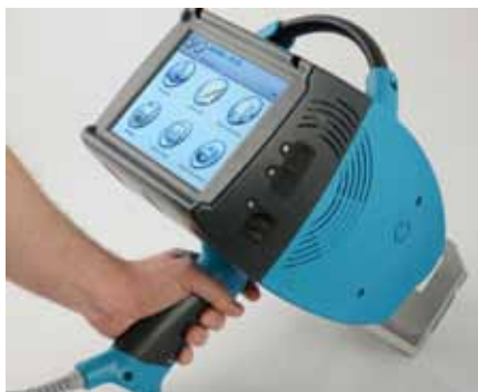
Die M7000 sorgt für dauerhafte Markierungen auf Materialien aller Art.
