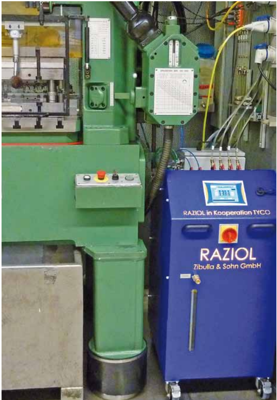
Die Präzisionsdosiereinheit von Raziol wurde speziell für Schnellstanzautomaten entwickelt und zeichnet sich durch eine selbsterklärende und leichte Bedienbarkeit aus.
