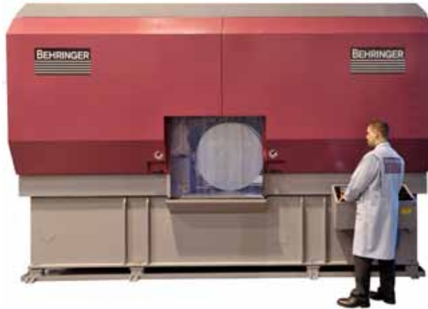
Die voll verkleidete ›HBM800ALU‹ von Behringer eignet sich zum wirtschaftlichen und präzisen Trennen von Alu-Material.
