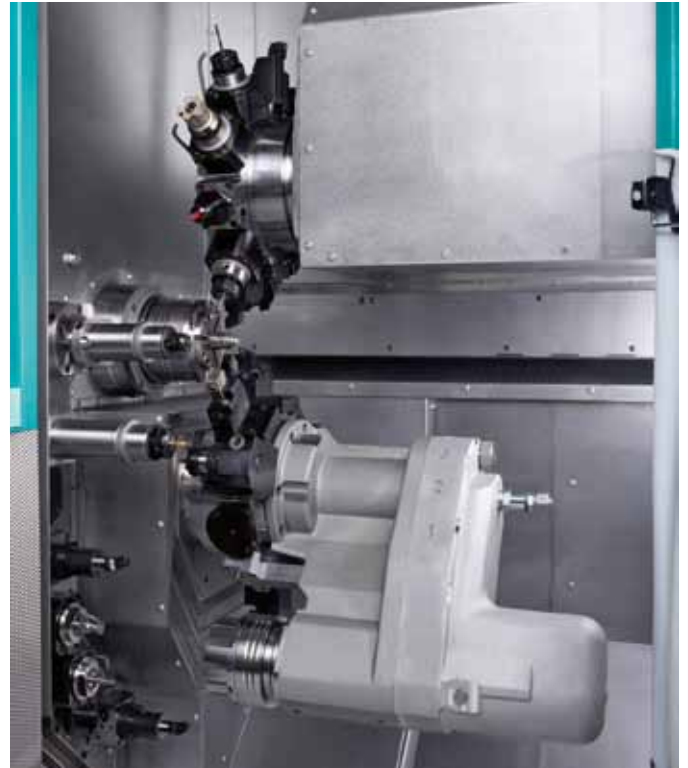
Der Werkzeugrevolver mit NC-Rundachse ermöglicht Mehrfachwerkzeugbelegung und Span-zu-Span-Zeiten von 0,4 Sekunden.
