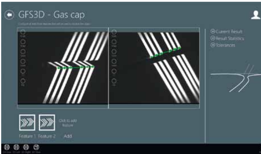
Die Messaufgabe klar im Blick: Visualisierung einer ›Gap & Flush‹-Messaufgabe zur Kontrolle der Bündigkeit im Windows 8-Stil.
