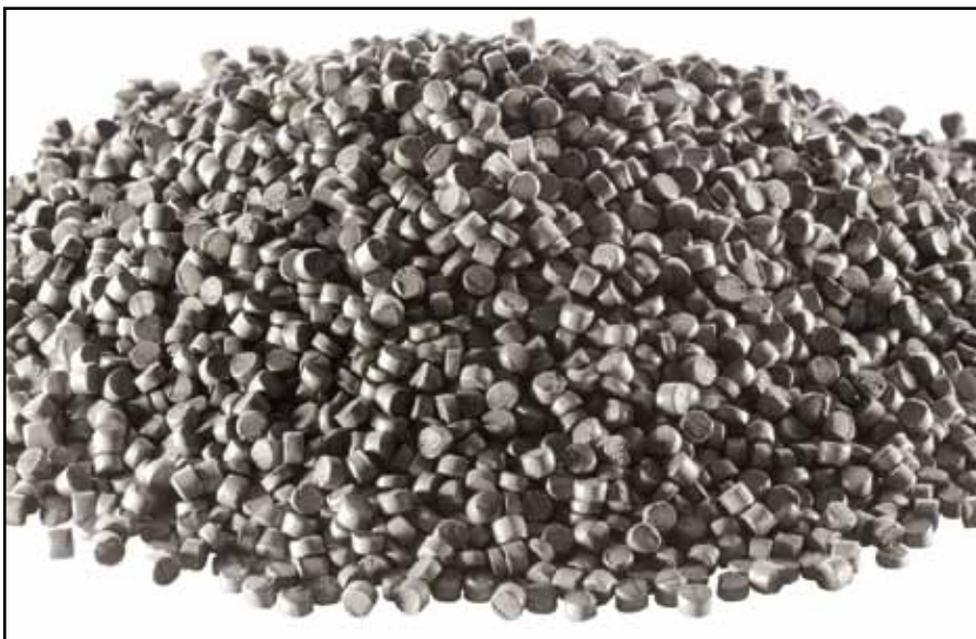
Beim MIM-Verfahren bildet der sogenannte ›Feedstock‹, der aus Metallpulver und Binder besteht, die Grundlage für den Fertigungsprozess.
