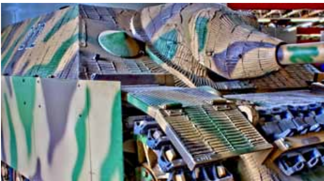
Das zementartige Material ›Zimmerit‹, das wellenförmig auf die Panzerung aufgetragen wurde, sollte es dem Gegner erschweren, Haftminen anzubringen.
