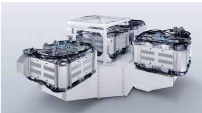
Der TrumPF Laser Amplifier ohne Abdeckung. Die T-Form passt sich besonders gut in kundenspezifische Fertigungen ein.
