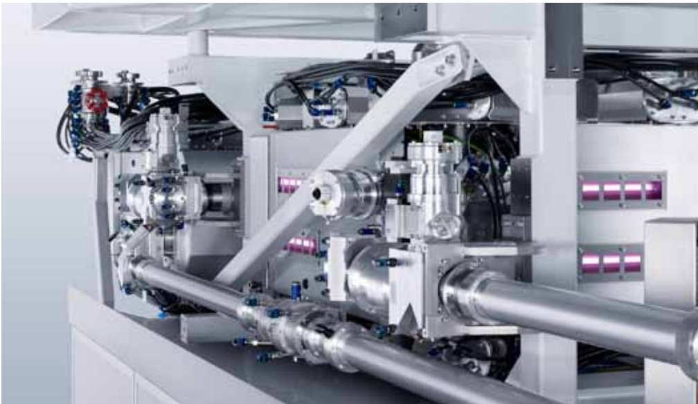
Die Verstärkung in einem TrumPF Laser Amplifier. Zur Verstärkung des Ausgangspulses wird das laseraktive Medium über mehrere Röhren verstärkt.
