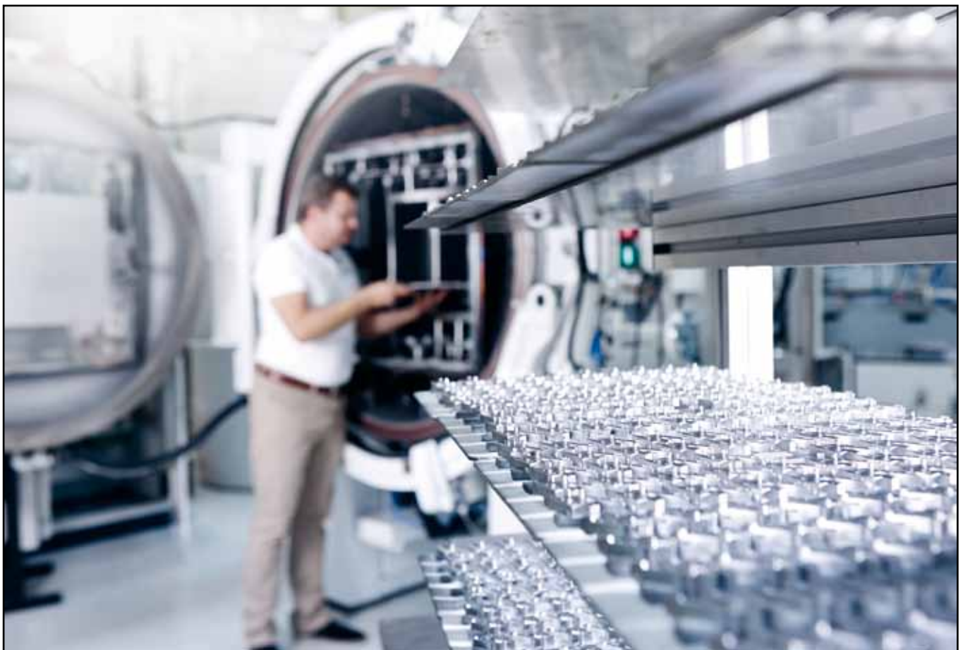
Das sogenannte MIM-Verfahren kombiniert die Spritzgusstechnik und die Sintertechnologie zu einer höchst interessanten Technologie, die sich besonders für komplexe, metallische Serienbauteile eignet.
